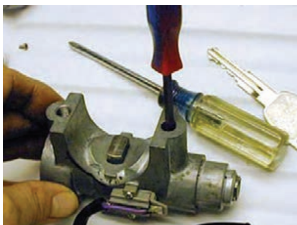
شکل ۱۸-۱۱- باز کردن پیچ مغزی سوئیچ
