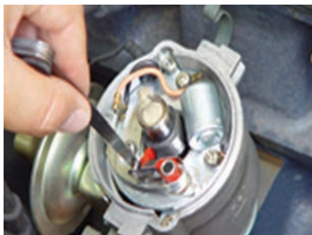
شکل ۴۸-۱۰ قرار دادن فیلر در دهانه‌ی پلاتین
