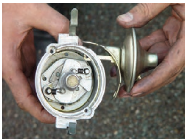
شکل ۳۱-۱۰ جدا کردن مجموعه‌ی آوانس خلئی
