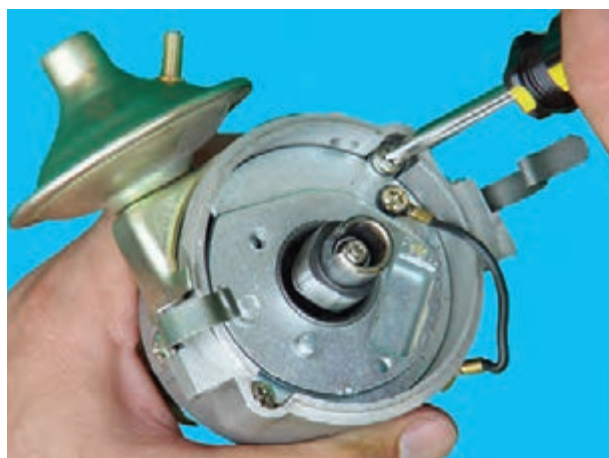
شکل ۱۹-۱۰- باز کردن پیچ‌های صفحه‌ی دلکو
