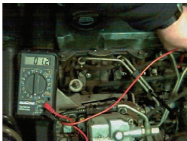
شکل ۱۳-۲۳ اندازه‌گیری مقاومت شمع گرم‌کن سیلندر چهارم
