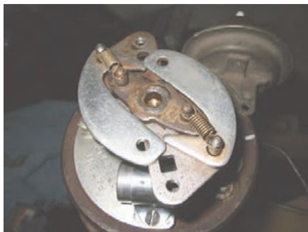
شکل ۲۴-۱۰- دستگاه آوانس وزنه‌ای دلکو
