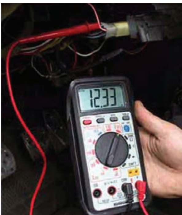
شکل ۲۸-۱۱ اندازه‌گیری ولتاژ در ترمینال ورودی سوئیچ
