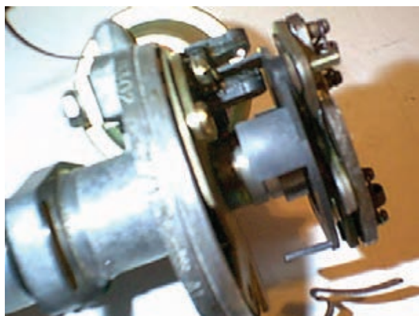
شکل ۷۳-۱۰- دلقوی الکترونیکی با حسگر اثر هال
