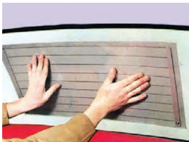
شکل ۹-۳- نحوه چسباندن المنت حرارتی
