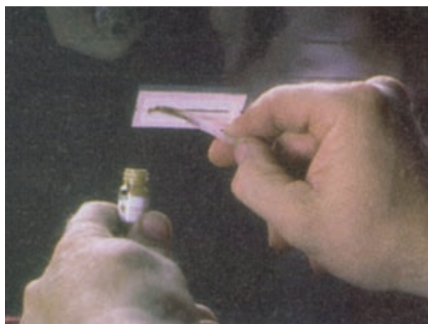
شکل ۳-۲۵- مالیدن مواد بین دو نوار روی شیشه
