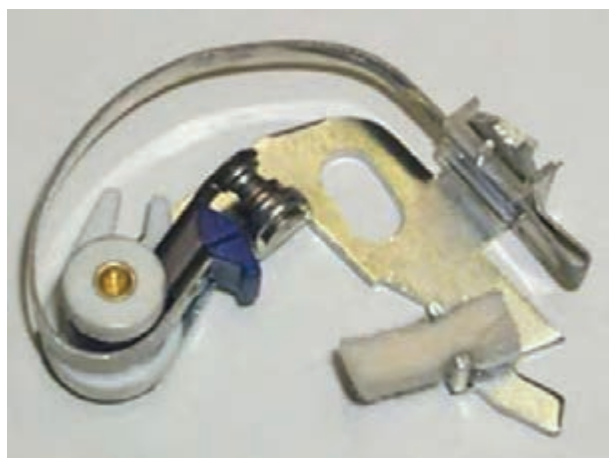
شکل ۲۲-۱۰- نمد روغن کاری بادامک
