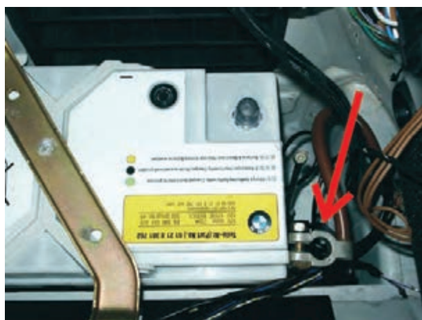
شکل ۹-۱۱- باز کردن کابل اتصال بدنه‌ی باتری
