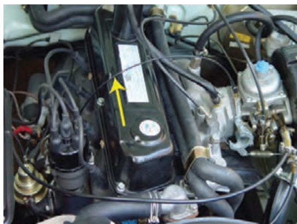
شکل ۲۸- ۱۰- لوله‌ی رابط آوانس خلئی به کاربراتور
