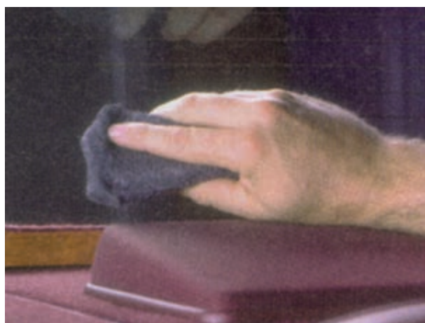
شکل ۳-۲۲- تمیز کردن محل قطع شده‌ی المنت حرارتی
