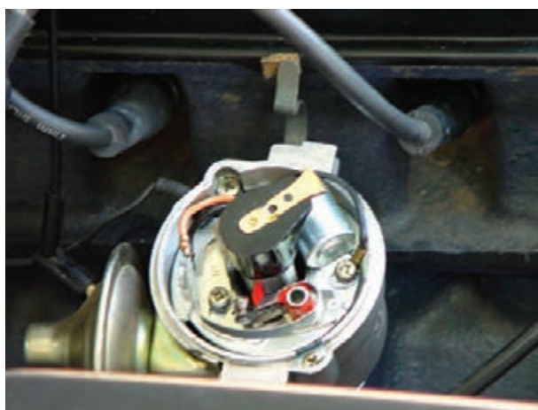
شکل ۵۵-۱۰- راستای چکش برق به سمت سیلندر یک
