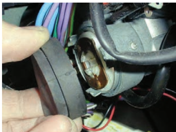
شکل ۱۱-۱۳- بیرون آوردن فیبری پشت سوئیچ
