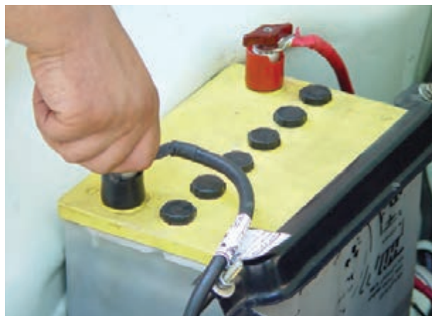
شکل ۱-۴۹- باز کردن اتصال بدنه باتری
