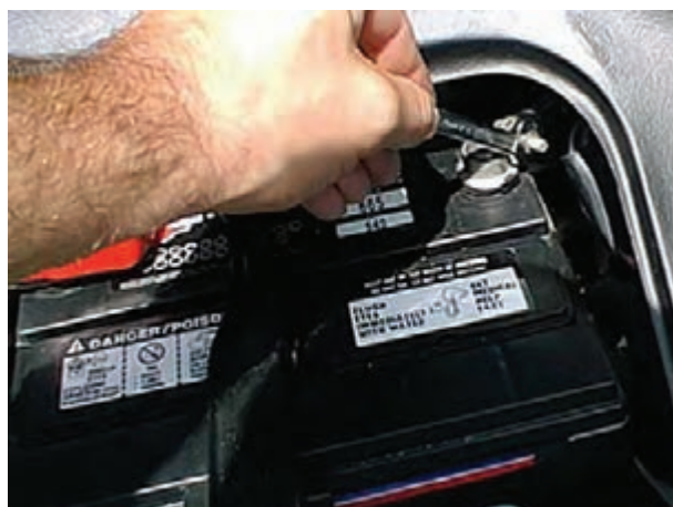
شکل ۱۲-۳- بستن کابل اتصال بدنه‌ی باتری
