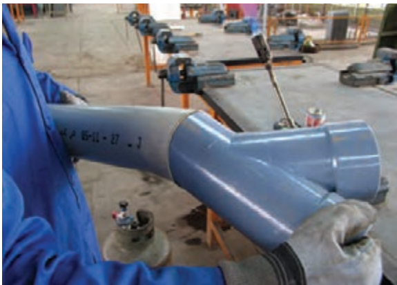
شکل ۹-۲ درست کردن سرکاسه
