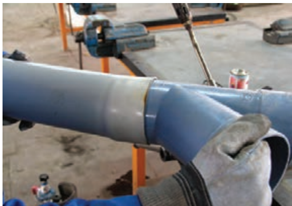
شکل ۱۰-۲ خارج کردن فیتینگ از سرکاسه
