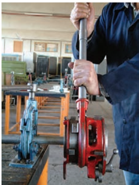
شکل ۱۲۶-۴- باز کردن حدیده از لوله
