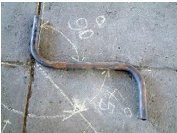
شکل ۵۸-۳- ادامه ی عمل خم کاری
