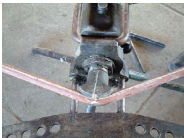
شکل ۳-۲۵- پایان عمل خم‌کاری
