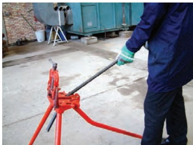
شکل ۳-۹- خم‌کاری لوله به وسیله‌ی گیره‌ی صحرایی
