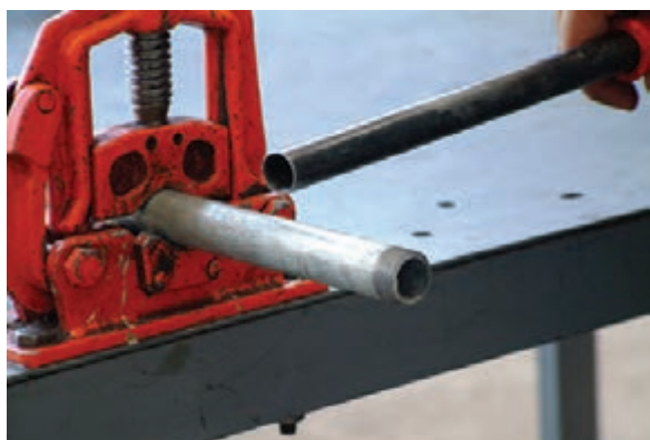
شکل ۴-۱۱۷ جداسازی پلیسه از سر دنده
