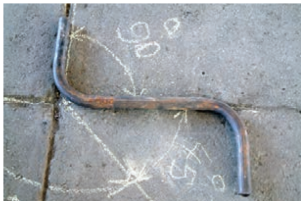
شکل ۳-۴۱- عدم دویدگی لوله‌ی دو خم
