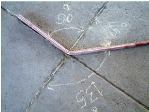
شکل ۲۹-۳- کنترل خم لوله‌های ۴۵ درجه
