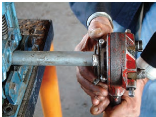
شکل ۴-۳۹- باز کردن فلکهای چهارنظام
