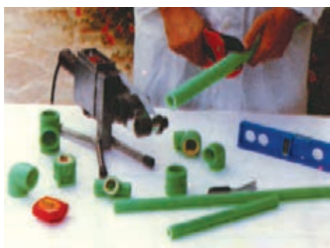
شکل ۲۷-۵- بریدن لوله به وسیله‌ی قیچی مخصوص
