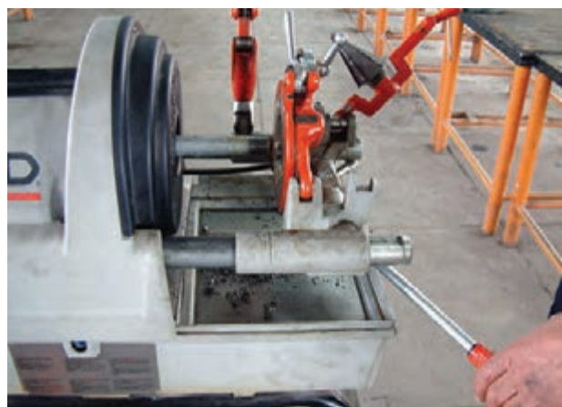
شکل ۴-۱۴۰- پایان عمل حدیده کاری
