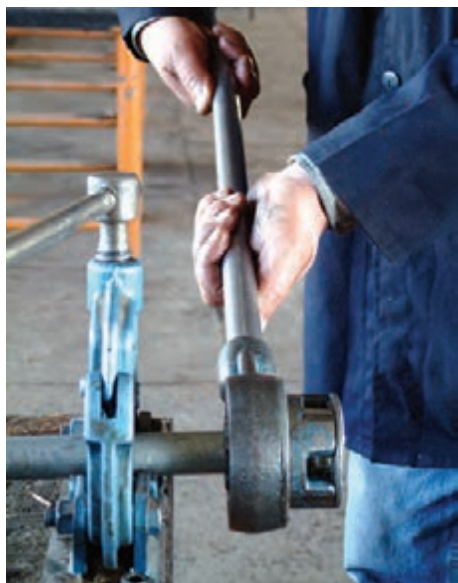
شکل ۴-۵۰- باز کردن حدیده از لوله
