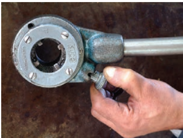
شکل ۴-۴۳- خارج کردن ضامن از شيار
