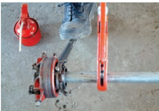
شکل ۵-۱۲۲ ادامۀ عمل حديدۀ کارى
