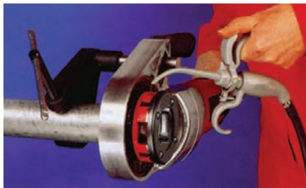
شکل ۴-۱۰۸- استفاده از روغن دان در جریان لوله کشی
