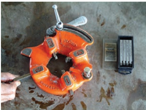
شکل ۴-۹۲ جا زدن پارچه‌ها در شيارهای تنه‌ی حديد
