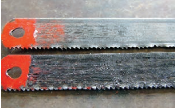
شکل ۱-۴۷- تیغه اره‌های دندان شکسته شده
