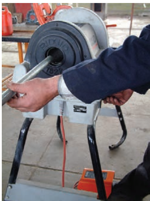
شکل ۱۳۱-۴- قراردادن لوله در حدیده ماشینی
