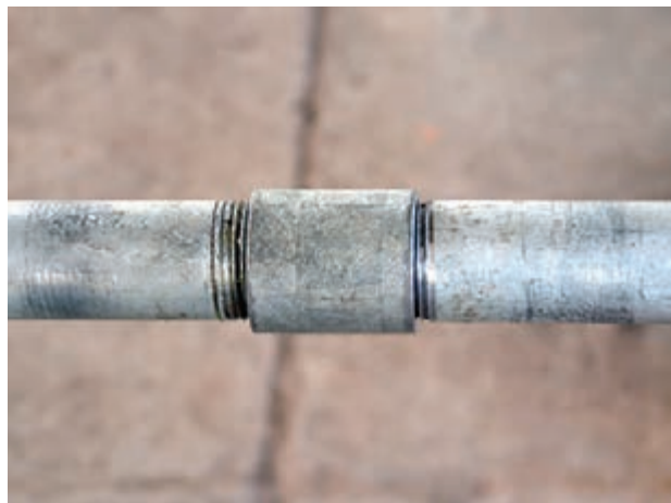
شکل ۳-۵- اتصال دنده‌ای
