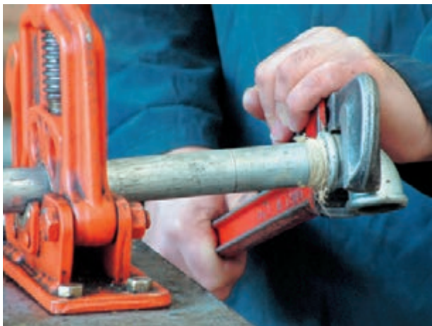
شکل ۵-۹۲- سفت کردن فیتینگ به وسیله‌ی آچار لوله‌گیر
