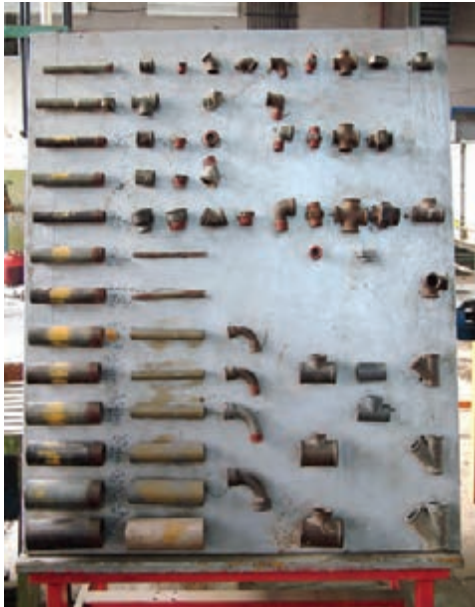
شکل ۳۵-۵- انواع لوله و فیتینگ‌های دنده‌ای
