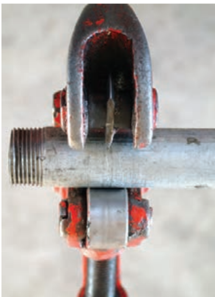
شکل ۹۶-۵- استفاده‌ی غلط از لوله بُر با تیغه‌ی شکسته
