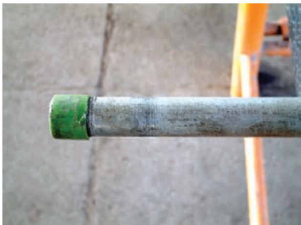
شکل ۴-۱۶ - اتصال بوشن پلاستیکی به سردنده‌ی لوله
