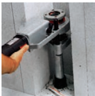
شکل ۴-۱۰۵ - طرز استفاده از حديدى
