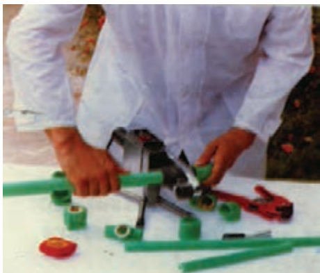
شکل ۵-۲۸- قرار دادن لوله و فیتینگ به صورت هم‌زمان در درون دستگاه
