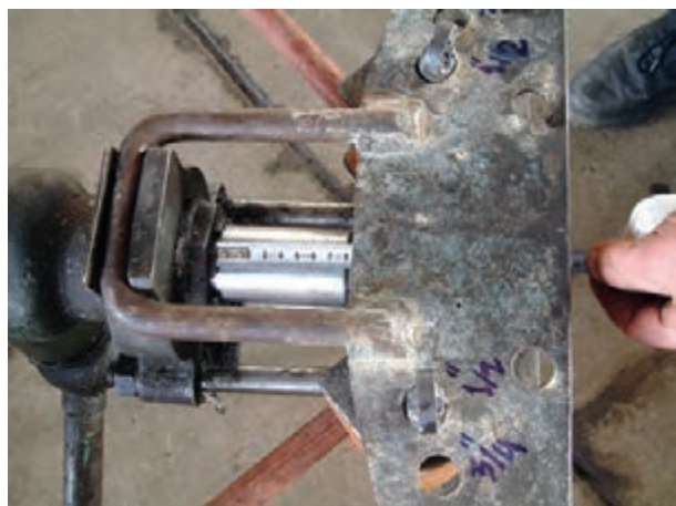
شکل ۳-۲۷- اندازه‌گیری طول پیستون خارج شده از سیلندر
