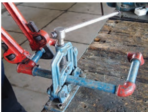
شکل ۵-۱۵۶- بستن ضلع سوم مدار به سهراهی
