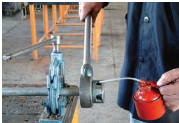
شکل ۴-۴۹- روغن کاری محل تماس پارچه‌ها با لوله
