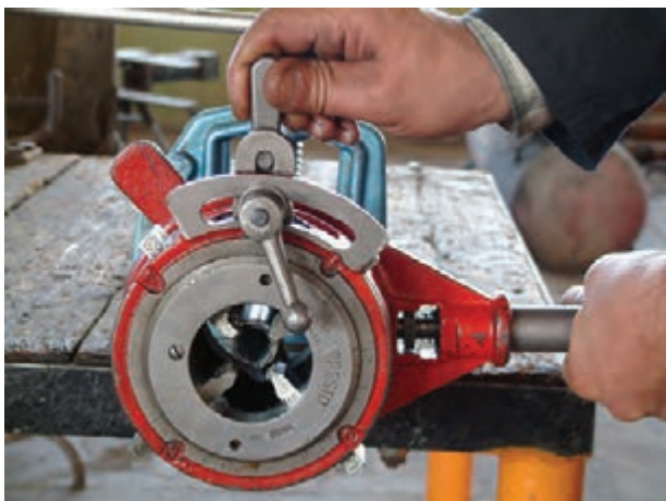
شکل ۱۲۵-۴- کم کردن بار پارچه‌های حدیده
