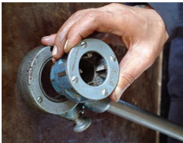
شکل ۴-۴۴- خارج کردن پارچه از بدنه‌ى حديدە
