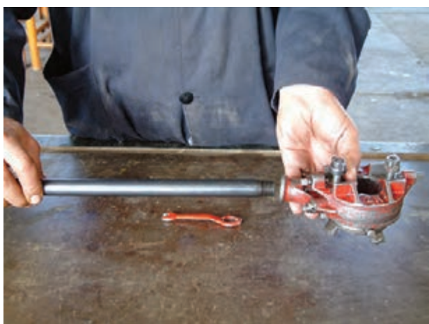
شکل ۴-۲۵ اتصال دسته‌ی حدیده به بدنه‌ی حدیده
