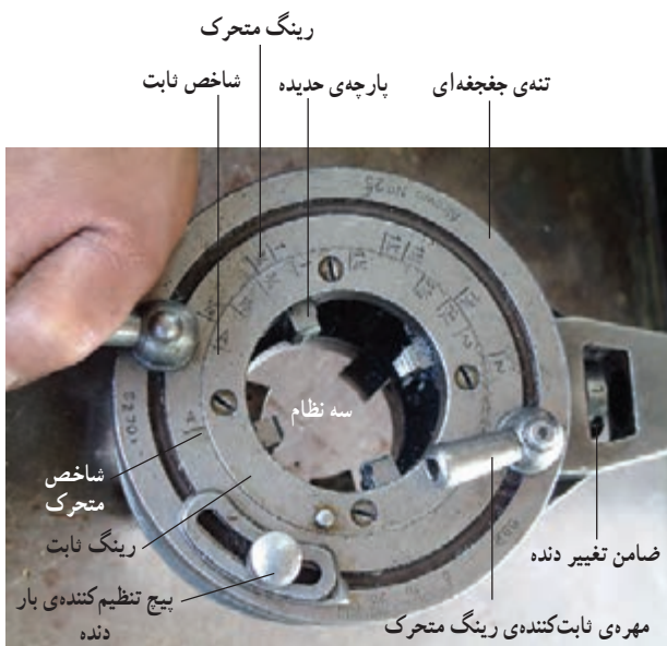
شکل ۴-۵۵- اجزای حدیده‌ی دستی چهارپارچه
