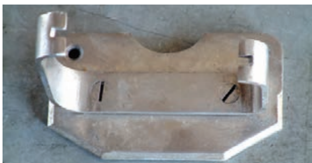
شکل ۴-۵- اتصال موقت با استفاده از پیچ
