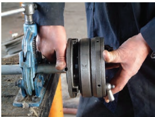
شکل ۴-۶۴- سفت کردن سه نظام حدیده
