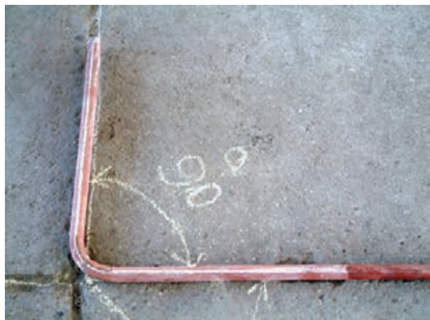
شکل ۳-۵۷- لوله‌ی خم کاری شده
