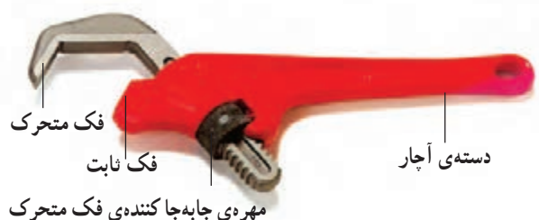
ب - آچار قابل تنظیم زاویه‌ای
