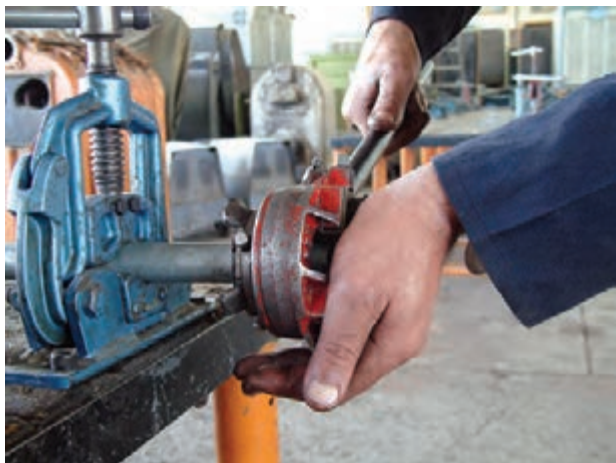
شکل ۴-۳۳- درگیر نمودن پارچه‌های حدیده با لوله
