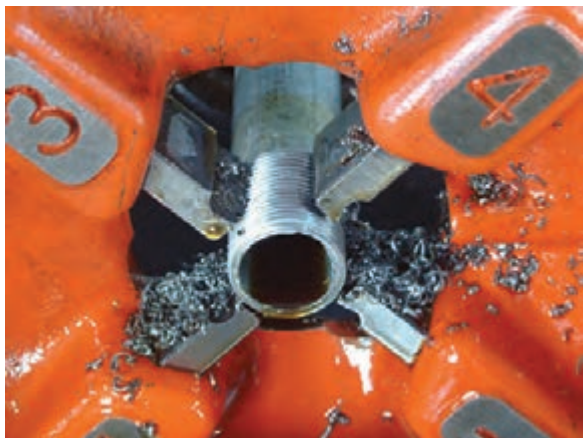
شکل ۴-۱۱۶ طول مناسب دنده
