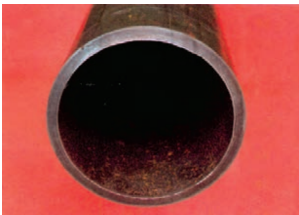
شکل ۴-۱۳- لوله‌ی فولادی بدون درز
