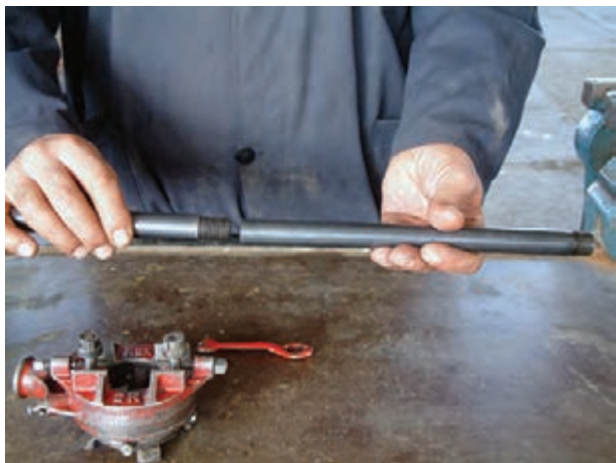
شکل ۴-۲۴ اتصال دسته‌ی دو تکه به یک‌دیگر
