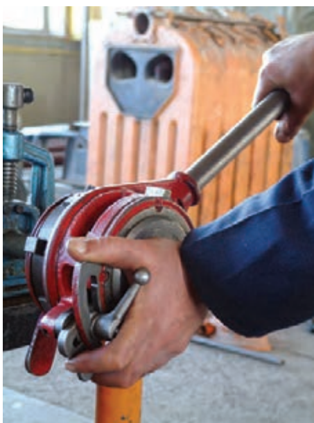
شکل ۴-۱۲۲- عمل درگیر کردن پارچه‌ها با سر لوله
