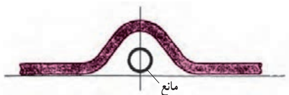
شکل ۳-۱- تغییر مسیر به علت وجود مانع
