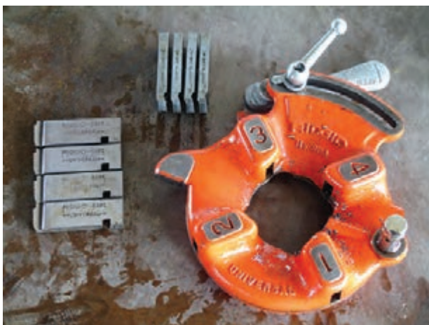
شکل ۸۹-۴- مشخصات حک شده بر روی پارچه‌های حدیده
