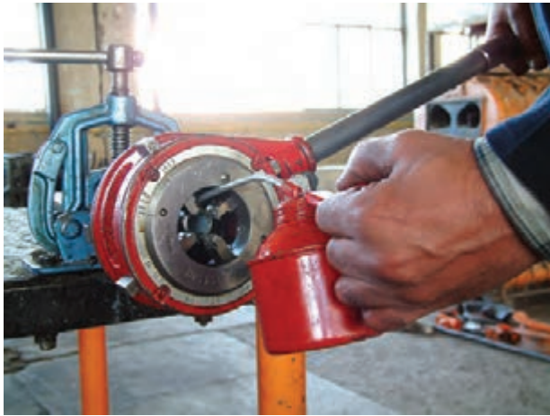
شکل ۱۲۳-۴- استفاده از روغن‌دان در جریان حدیده‌کاری
