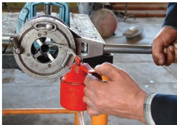
شکل ۴-۶۸- عمل روغن‌کاری در حین حدیده‌کاری
