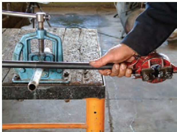
شکل ۴-۴۰- جدا کردن پلیسه‌ها از سر دنده
