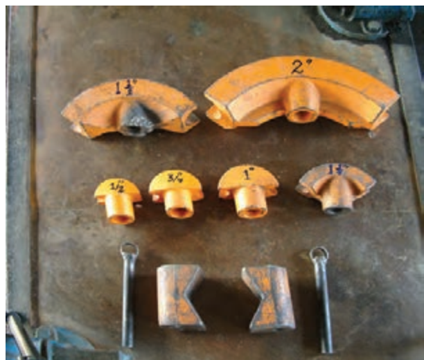
شکل ۳-۲۰- پارچه‌ها و لقمه‌های خم‌کن هیدرولیکی
