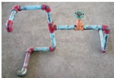
شکل ۱۳۳-۵- تکمیل شدن مدار مطابق نقشه‌ی کار
