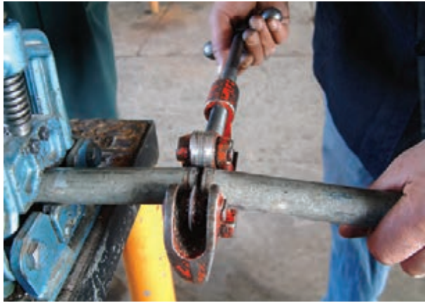
شکل ۳-۵۲- بریدن لوله‌ی محاسبه شده
