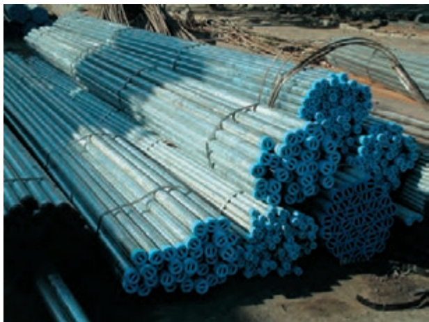
شکل ۴-۱۴ - لوله‌ی فولادی گالوانیزه
