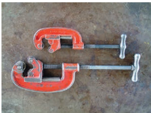
شکل ۱-۶۳- لوله‌بر در دو اندازه‌ی متفاوت
