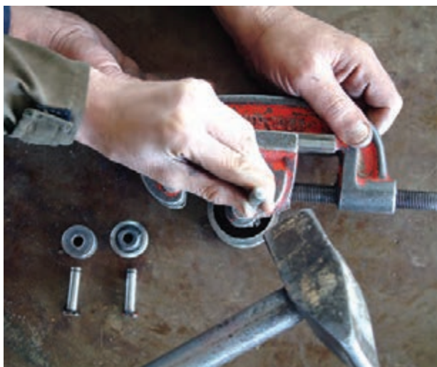
شکل ۱۹-۱ خارج کردن پین‌ها به وسیله‌ی سنبه‌نشان و چکش فلزی
