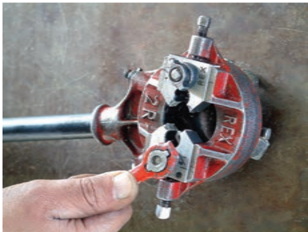
شکل ۴-۲۸- سفت کردن مهره به وسیله‌ی آچار حدیده
