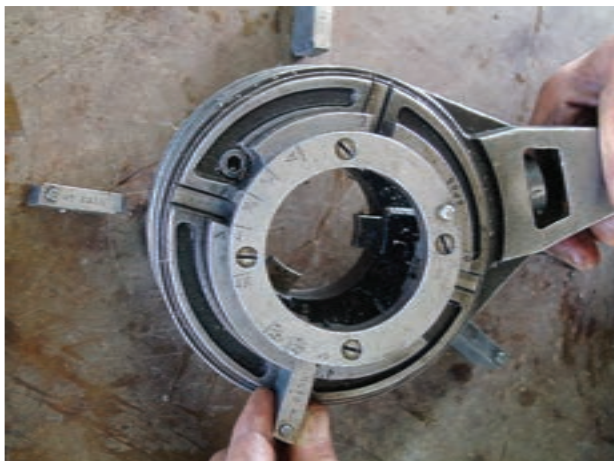
شکل ۴-۵۹- خارج کردن پارچه‌ها از حدیده
