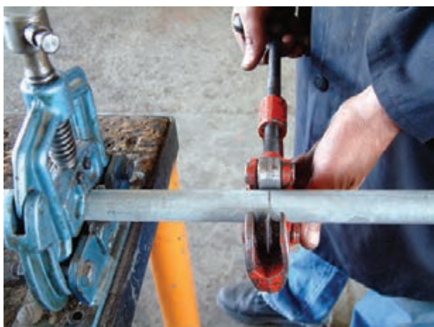
شکل ۱-۶۲- سفت کردن دسته‌ی لوله‌بر به اندازه‌ی لازم
