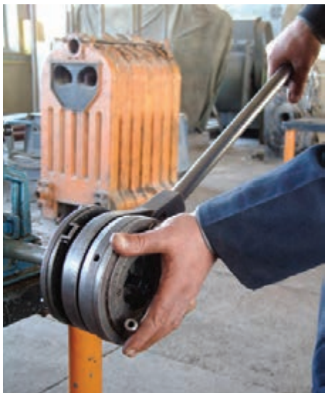
شکل ۴-۶۶- درگیر کردن حدیده با سر لوله
