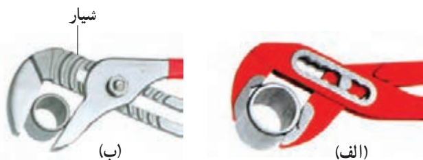
شکل ۵-۷۰- سوراخ‌ها و شیارهای متعدد آچارهای کلاغی
