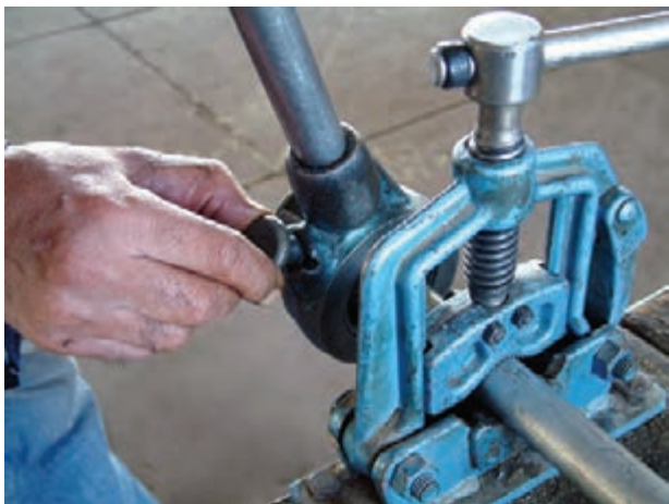
شکل ۴-۴۶- قرار دادن ضامن در جهت حدیده کردن
