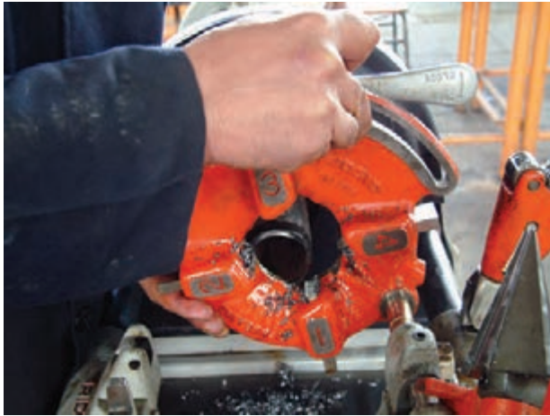
شکل ۴-۹۰ جدا کردن تنه‌ی حديد از دستگاه
