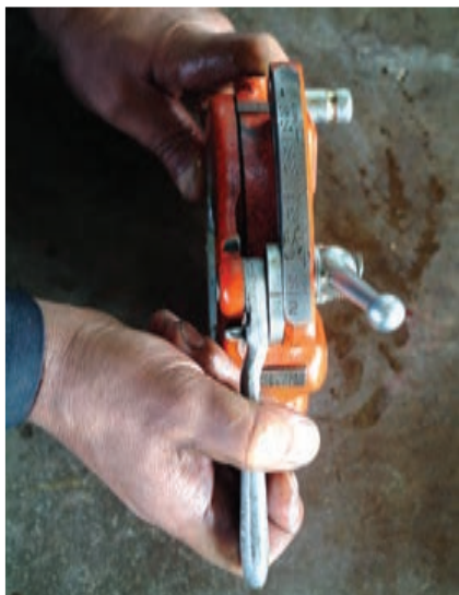
شکل ۴-۹۳- تنظیم حدیده به اندازه‌ی لوله‌ی ۲ اینچ
