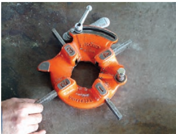
شکل ۴-۹۱ مرحله‌ی اول: ترتيب قرارگيري پارچه‌ها در شيارهای تنه‌ی حديد
