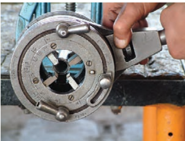
شکل ۴-۵۶- قرار دادن ضامن در حالت F
