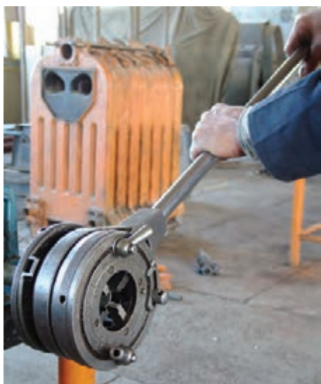
شکل ۴-۶۷- دنده کردن لوله
