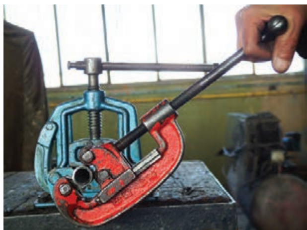
شکل ۱-۵۶- گرداندن لوله‌بُر به دور لوله
