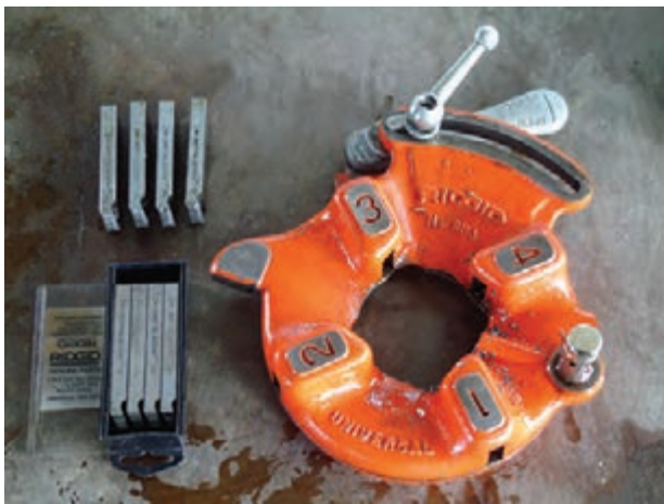
شکل ۸۸-۴- تنه‌ی حدیده و پارچه‌های آن
