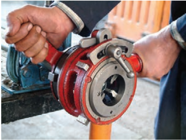
شکل ۴-۱۲۰- بستن اهرم فلکهای چهار نظام
