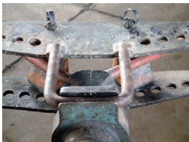
ب- باز کردن خم لوله‌ی خم شده
