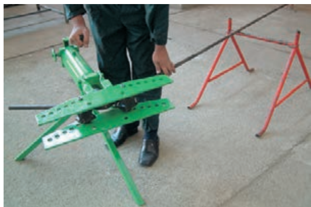
شکل ۳-۴۲- استفاده از خرک در خم کاری
