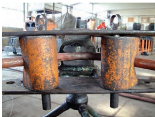
الف- باز کردن خم لوله‌ی خم شده
