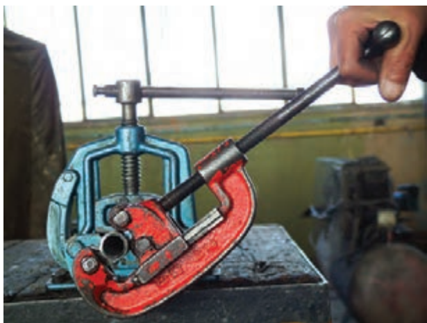
شکل ۱۵۰-۵ بریدن لوله ها
