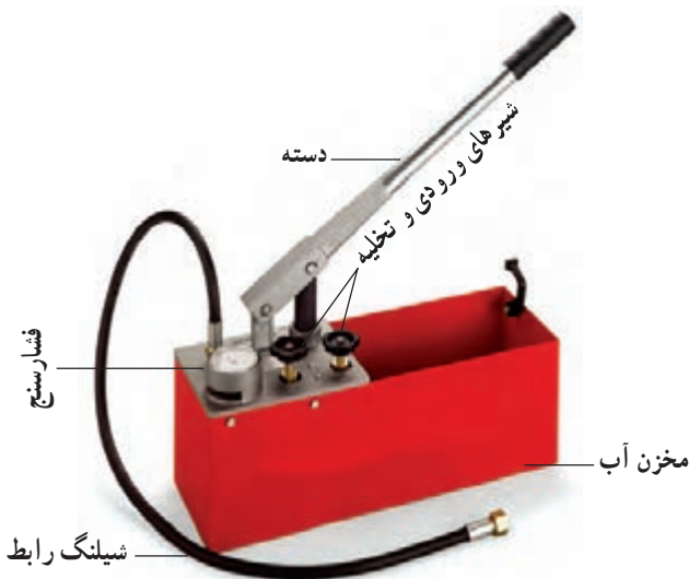
شکل ۸۷-۵- پمپ آزمایش دستی و اجزای آن
