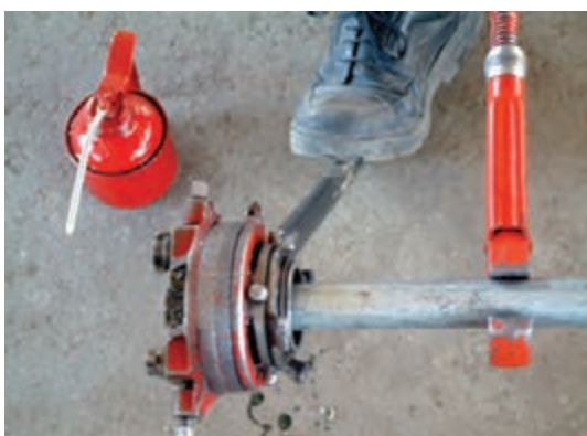
شکل ۵-۱۲۳ عمل باز کردن سردنۀ از پارچه‌هاى حديدۀ
