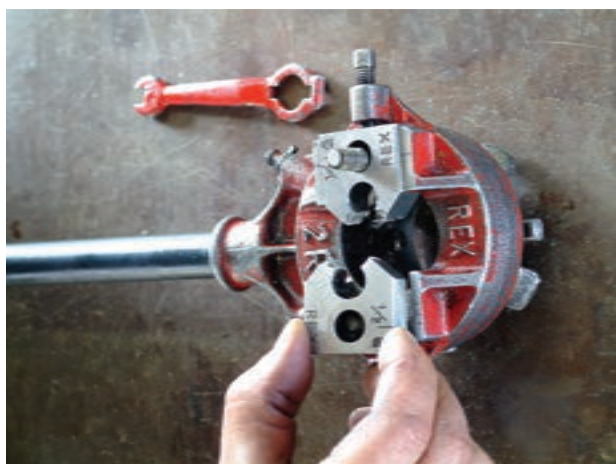
شکل ۴-۲۶ قرار دادن پارچه‌ها در محل خود
