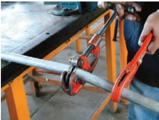
شکل ۱۱۷-۵- بریده شدن لوله و خاتمی کار
