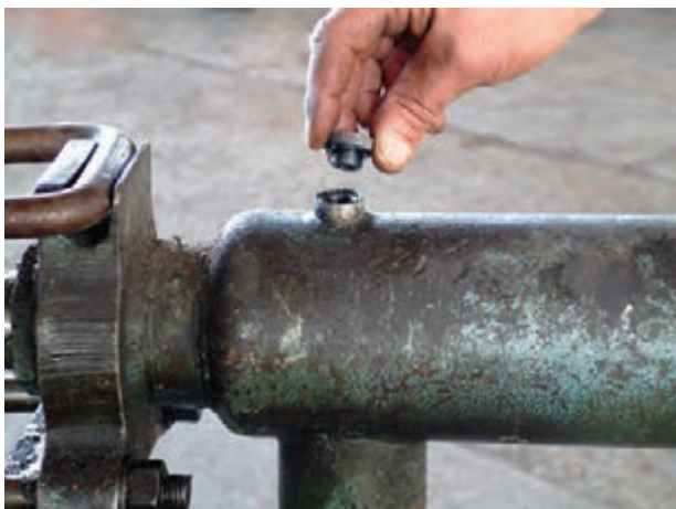
شکل ۱۵-۳ سرپوش مجرای ورودی روغن
