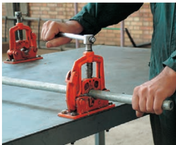
شکل ۱-۲۸ بستن لوله به گیره‌ی لوله
