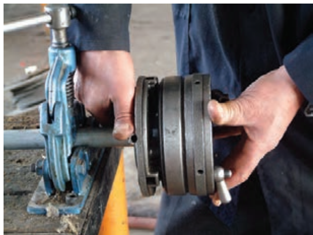
شکل ۴-۷۱- باز کردن سه نظام حدیده
