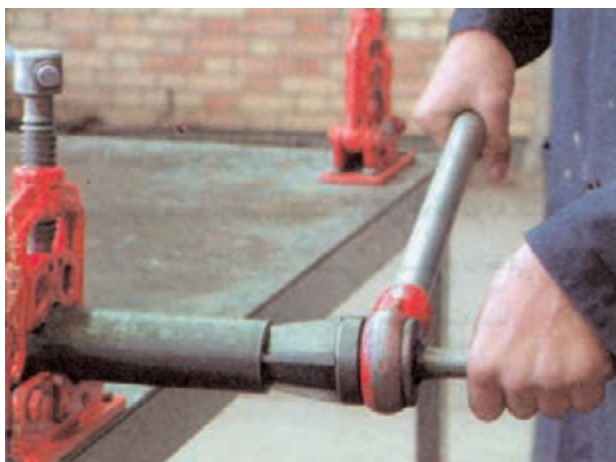
شکل ۱۲-۲ عمل بُرقوکاری
