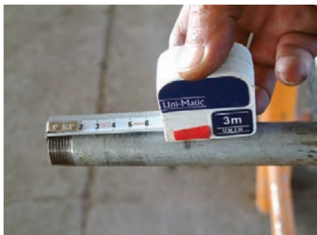
شکل ۱۲۸-۴- اندازه‌گیری لوله‌ی حدیده شده
