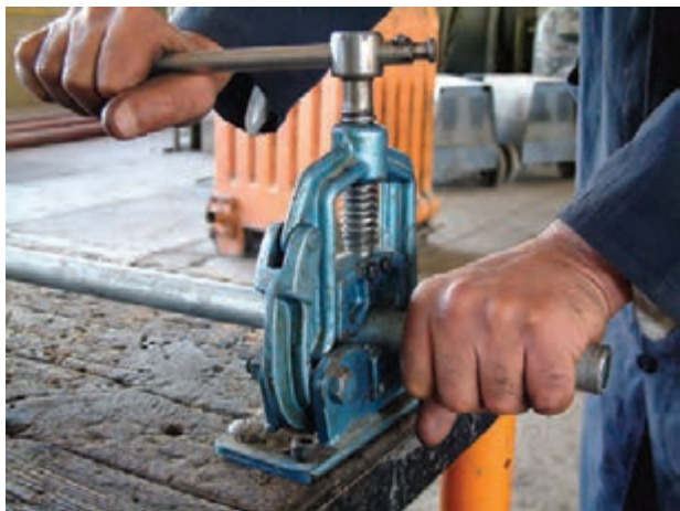
شکل ۱-۳۵- بستن لوله به گیره برای ارّه کاری
