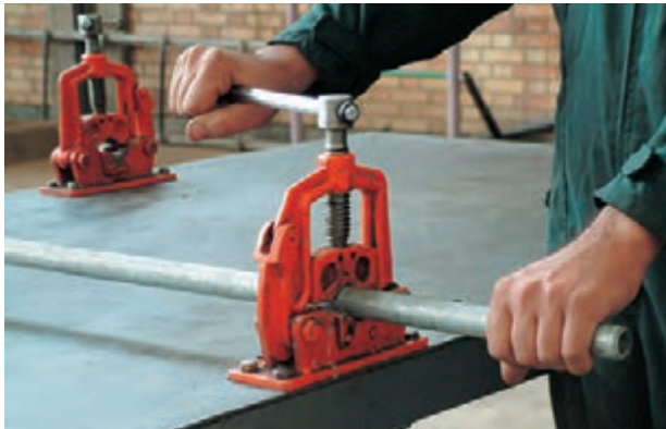
شکل ۳-۵۳- باز کردن شاخه‌ی لوله از گیره‌ی لوله
