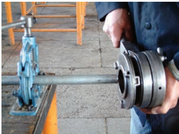
شکل ۵-۱۳۶- حدیده کردن لوله‌ها
