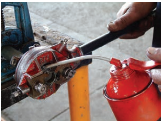
شکل ۴-۳۵- روغن کاری
