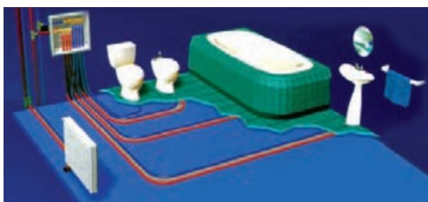
شکل ۵-۱۹- اجرای لوله‌کشی وسایل بهداشتی با استفاده از لوله‌های PE-X
