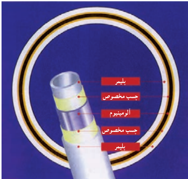
شکل ۵-۲۰ ساختار لوله‌ی پلی اتیلن پنج لایه
