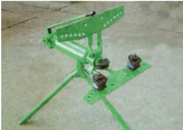
شکل ۳-۴۸ قرار گرفتن لقمه در محل مناسب خود
