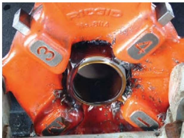
شکل ۴-۸۲- استفاده از روغن در موقع حدیده‌کاری
