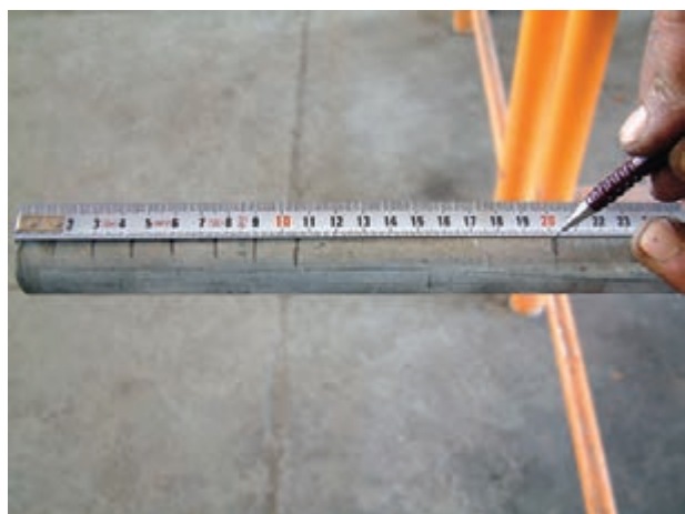
شکل ۱-۶۴- خط کشی کردن لوله
