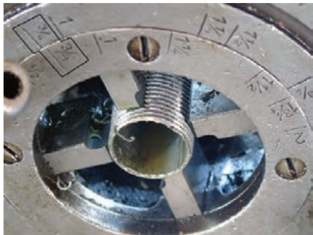
شکل ۴-۶۹- حد صحیح حدیده کردن لوله ی \frac{3}{4} "
