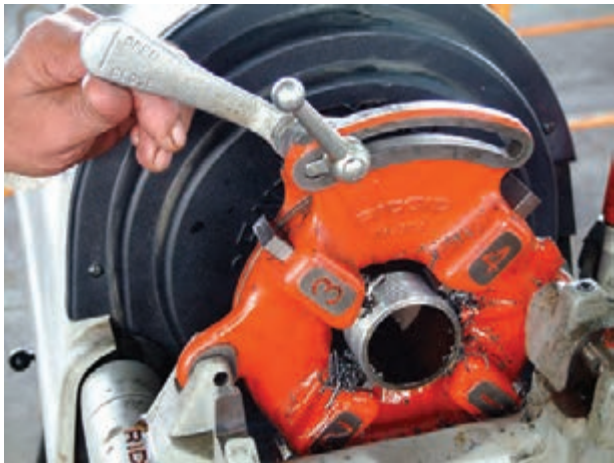
شکل ۴-۷۸- عمل حدیده کاری با ماشین
