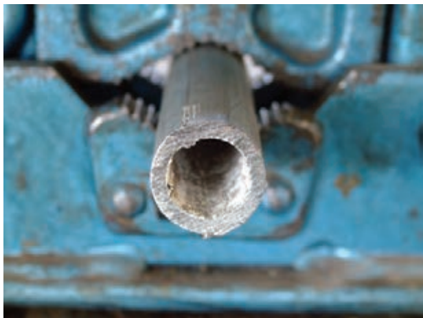
شکل ۱-۵۲- لوله ی بسته شده به گیره ی لوله
