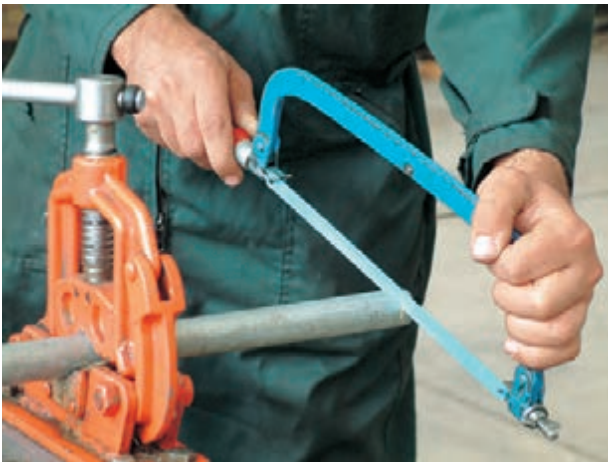
شکل ۵۰-۱- عدم رعایت فاصله‌ی مناسب از لب گیره
