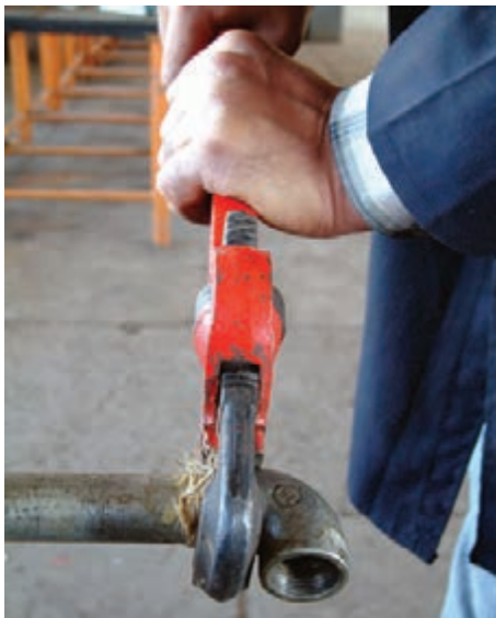
شکل ۵-۵۹- آچار لوله‌گیر
