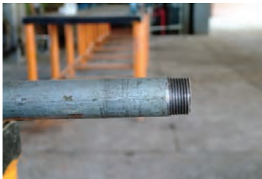
شکل ۵-۴- لوله‌ی فولادی گالوانیزه
