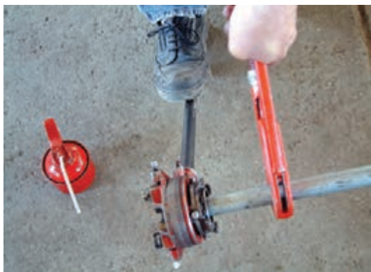
شکل ۵-۱۲۰ عمل حديدۀ کارى لوله
