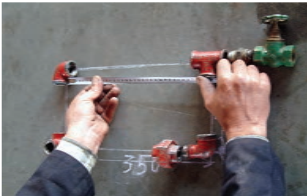
شکل ۵-۱۱۲- اندازه‌گیری طول لوله
