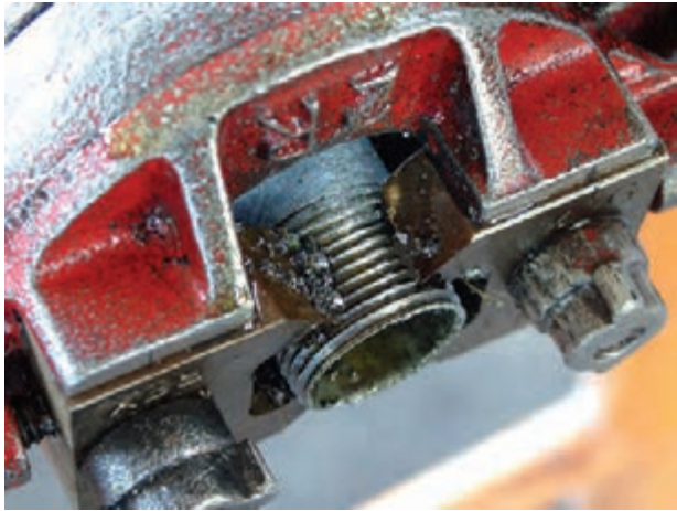
شکل ۴-۳۶- عبور دو دندانه از انتهای پارچه
