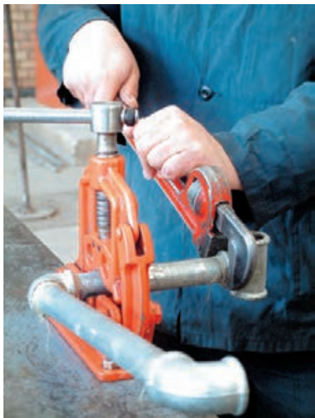
شکل ۱۰۳-۵- نحوه‌ی صحت سفت کردن فیتینگ به لوله
