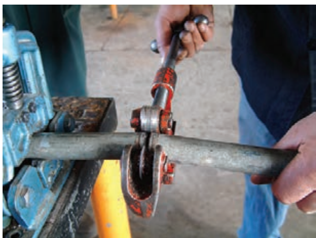
شکل ۱-۵۹ - انتهای عمل بُرش کاری
