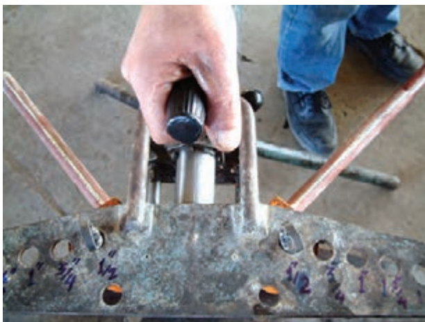
شکل ۱۲-۳- بعد از عمل خم کاری
