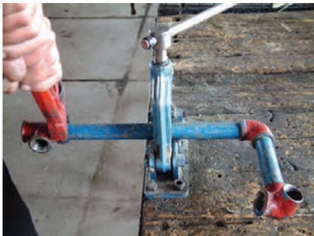
شکل ۵-۱۵۵- بستن سهراهی به ضلع دوم مدار
