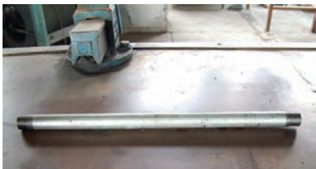
شکل ۴-۶- لوله ی دو سر دنده شده
