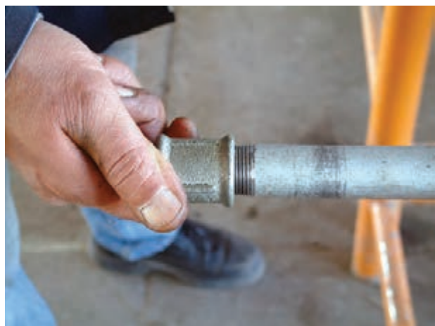
شکل ۴-۴۱- کنترل بار سردنده به وسیله‌ی یک فیتینگ
