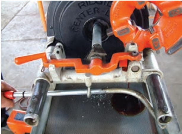
شکل ۱۳۲-۴- عمل بُرقوکاری
