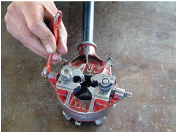
شکل ۴-۲۹- تنظیم کردن حدیده به وسیله‌ی آچار حدیده
