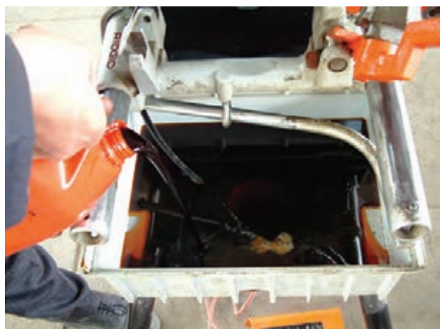
شکل ۴-۸۳- مخزن روغن حدیده‌ی ماشینی
