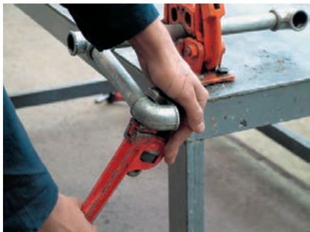
شکل ۱۰۵-۵- روش غلط سفت کردن مدار
