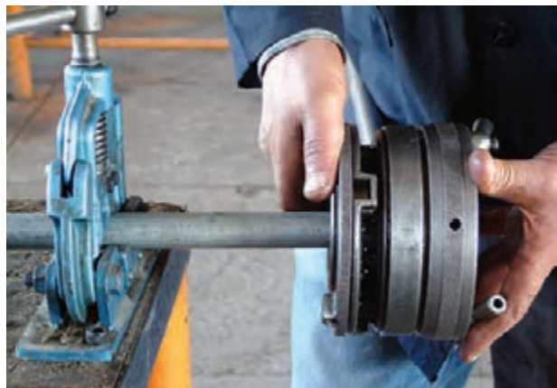
شکل ۵-۱۳۰- حدیده کردن لوله‌ها
