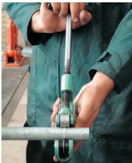
شکل ۱۳۵-۵ بریدن لوله‌های مورد نیاز
