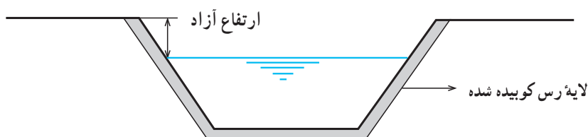
شکل ۱۶-۲. مقطع یک کانال با پوشش خاک رس
