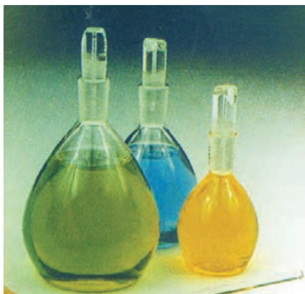
شکل ۳۳-۱ انواع پیکنومتر
