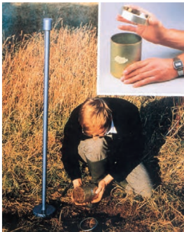
شکل ۱۶- ۱ نمونه برداری از خاک با سیلندر
