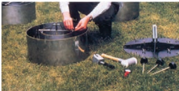
شکل ۳۰-۱ نحوه کار گذاشتن استوانه مضاعف
