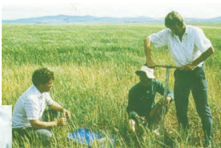
شکل ۱۳- ۱ نحوه کار با اوگر
