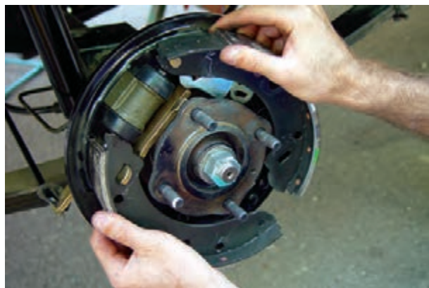
شکل ۹۳-۱- خارج کردن کفشک‌ها
