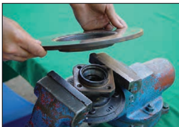
شکل ۱۲۶-۱ بازکردن دیسک ترمز
