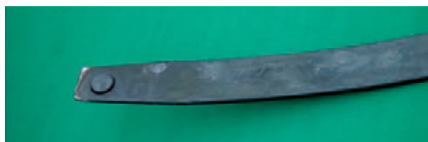
شکل ۳-۷۰- لاستیک‌های محافظ انتهایی لایه‌های فنر شمش
