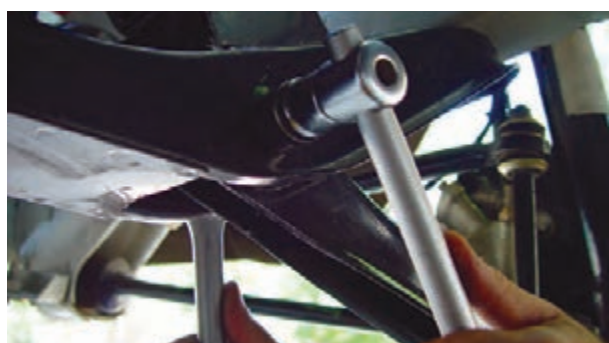
شکل ۳-۸۳ باز کردن طبق از رام
