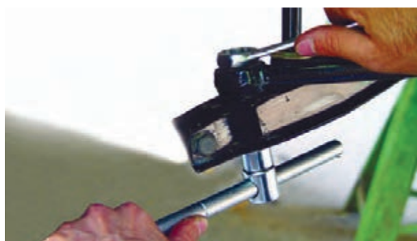
شکل ۳-۸۱- باز کردن میل تعادل از طبق
