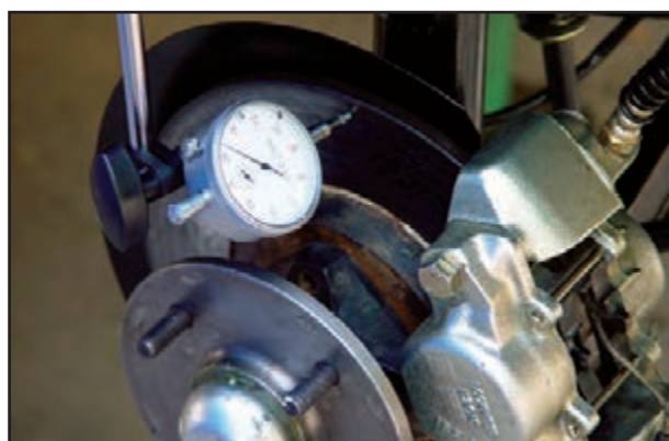
شکل ۱-۱۲۳- بررسی وضعیت دیسک
