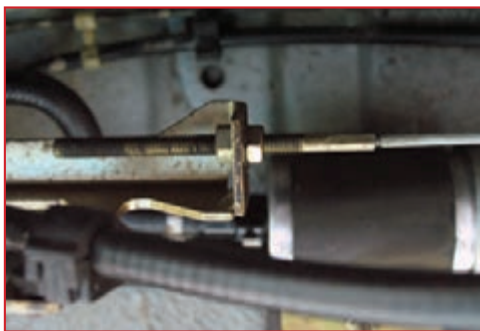
شکل ۴۸-۱- باز کردن مهره تنظیم کننده
