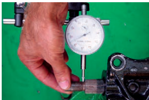
شکل ۷۱-۲ اندازه‌گیری لقی جانبی محور هزار خار
