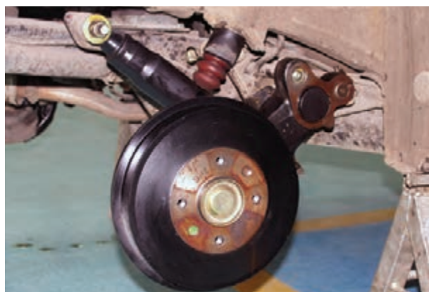
شکل ۱۷۷-۳- نصب کمک فنر
