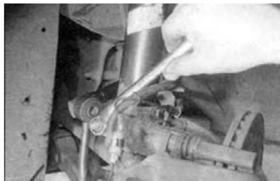
شکل ۱۱۸-۳- بستن پیچ نگه‌دارنده کمک فنر
