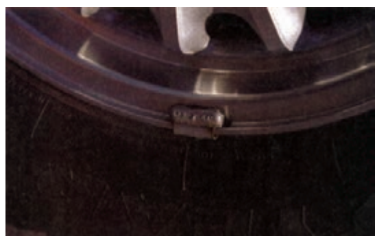
شکل ۳-۲۳۱- نصب وزنه روی رینگ
