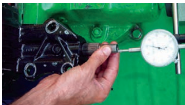
شکل ۷۰-۲ اندازه‌گیری لقی طول محور هزار خار
