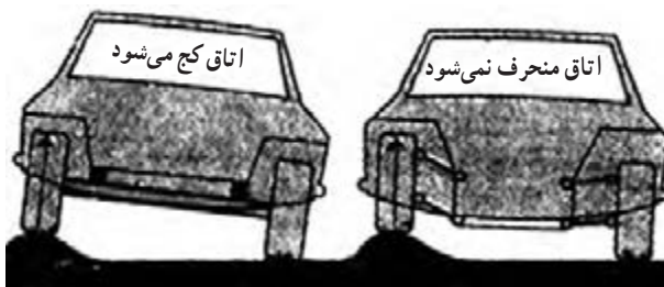
الف- تعلیق مستقل ب- تعلیق یک پارچه
