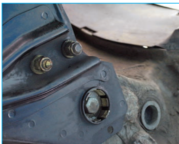
شکل ۳-۱۲۲- باز کردن پیچ های طبق
