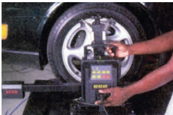
شکل ۳-۲۲۰ - نصب مجموعه حسگر دستگاه اندازه‌گیر رایانه‌ای
