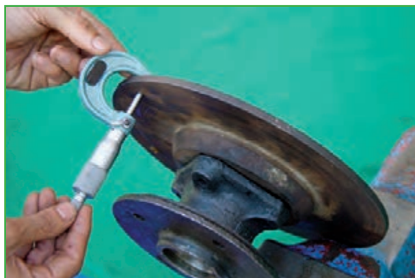
شکل ۱۲۴-۱ اندازه‌گیری ضخامت دیسک
