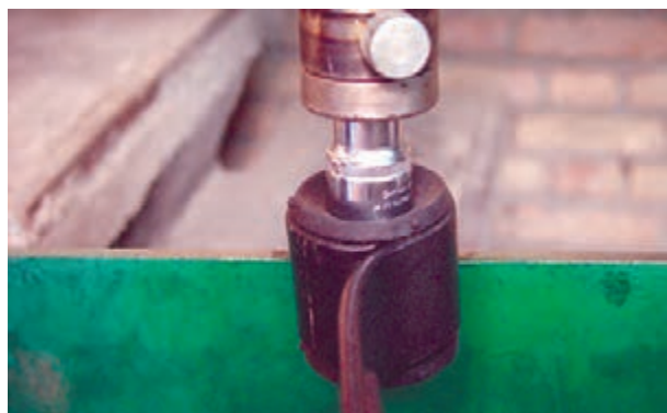
شکل ۳-۶۹- بوش لاستیکی فلزی محل اتصال شاه فنر
