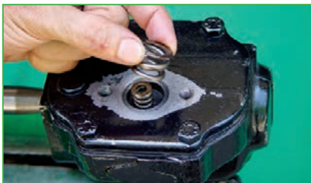
شکل ۲-۶۱ خارج کردن فنرها
