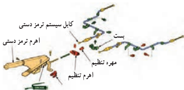
شکل ۱-۴۶ - اجزای سیستم ترمز دستی
