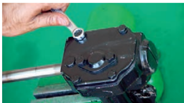
شکل ۲-۶۲ باز کردن درپوش بالایی جعبه فرمان
