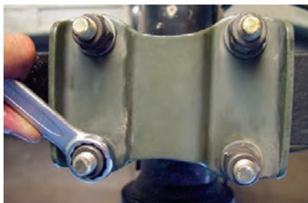
شکل ۳-۶۶- باز کردن مهره‌های کربی‌ها (پیچ‌های U شکل)
