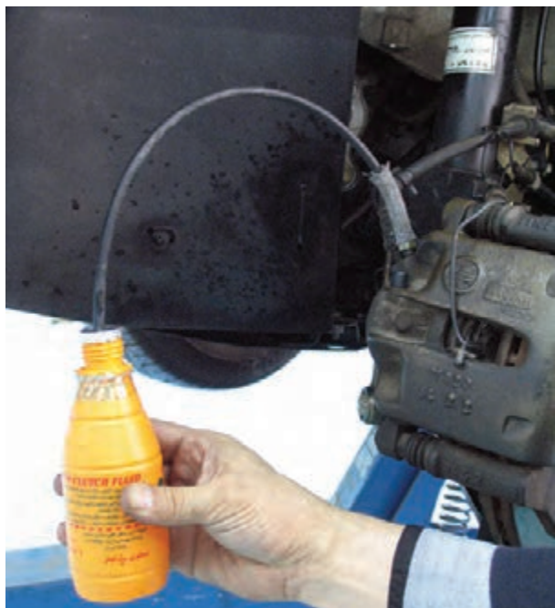
شکل ۱-۷۱- نصب لوله پلاستیکی روی پیچ هواگیری
