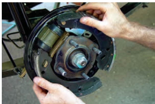
شکل ۱-۱۰۴- خارج کردن کفشک‌ها
