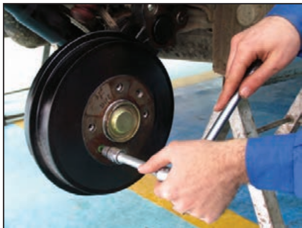
شکل ۱-۱۰۲- بستن پیچ نگه‌دارنده کاسه چرخ
