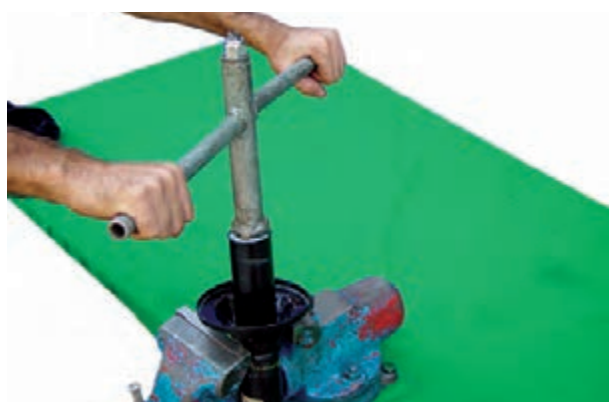
شکل ۳-۹۱- باز کردن مهره نگه‌دارنده کمک فنر
