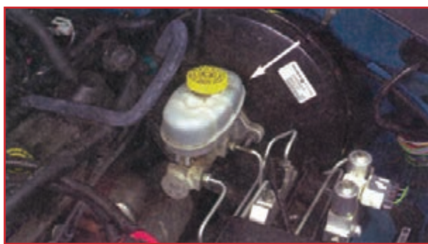
شکل ۱-۷۸- مخزن مایع ترمز و پمپ اصلی
