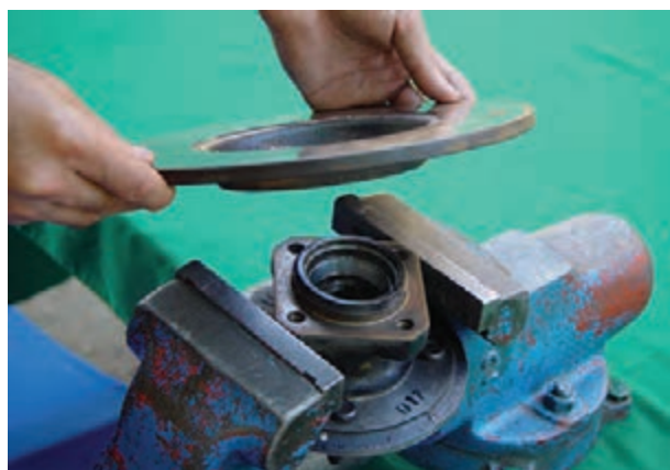
شکل ۳-۹۸- جدا کردن دیسک ترمز از تویی چرخ
