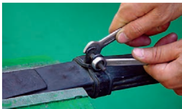
شکل ۳-۶۷- باز کردن بست‌های مجموعه فنر شمش
