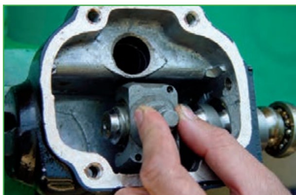
شکل ۲-۶۳ خارج کردن محفظه ساچمه‌ها
