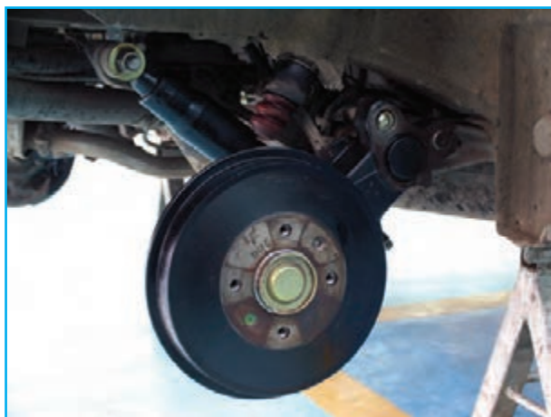
شکل ۱۸۳-۳- نصب ژامبون و متعلقات چرخ عقب
