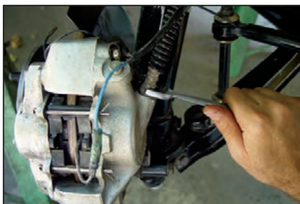
شکل ۱-۱۱۹- باز کردن شیلنگ ترمز
