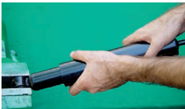
شکل ۳-۷۴- آزمایش کمک فنر
