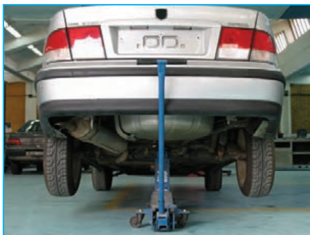
شکل ۳-۱۵۶ تنظیم ارتفاع و کنترل رام لوله‌ای
