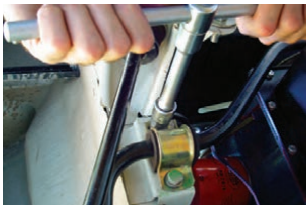
شکل ۳-۸۶- باز کردن میله ضد غلتش (موج گیر)
