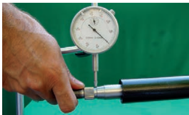
شکل ۶۹-۲ اندازه‌گیری لقی جانبی میل فرمان
