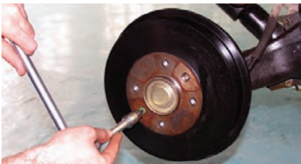
شکل ۸۹-۱ – باز کردن پیچ کاسه چرخ
