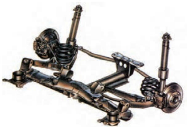
شکل ۳-۴۸- سیستم تعلیق مستقل عقب با چرخ‌های متحرک
