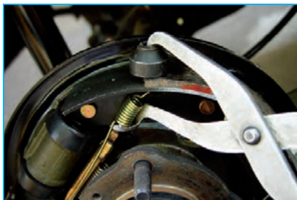
شکل ۹۱-۱- خارج کردن فنر بالایی
