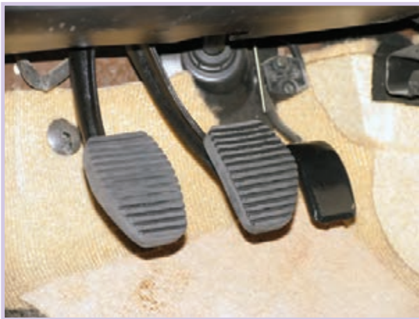
شکل ۱۵-۱- مجموعه پدال‌های ترمز و کلاچ
