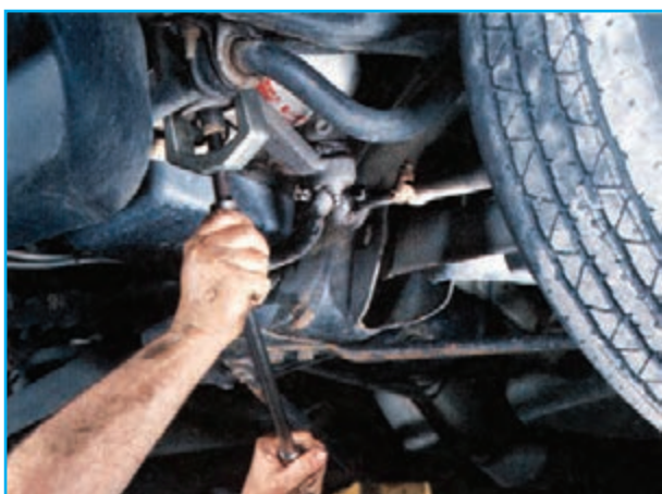
شکل ۲-۴۷- نحوه استفاده از نوعی سیبک کش
