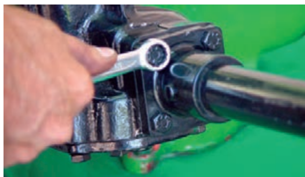
شکل ۲-۶۰ باز کردن پیچ‌های لوله فرمان
