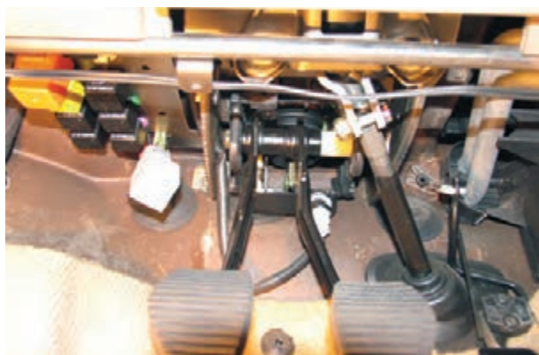
شکل ۱۵۲- کلید چراغ ترمز
