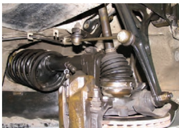
شکل ۱۳۱-۳ نصب میل موج گیر کوتاه
