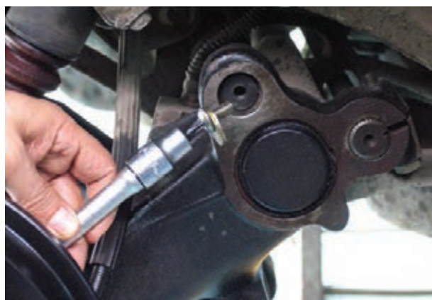
شکل ۱۷۶-۳- نصب واشر فشار و پیچ‌های انتهای میله‌ها
