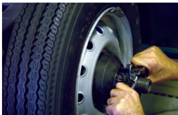
شکل ۲۳۴-۳- نصب چرخ روی دستگاه
