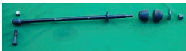
شکل ۳-۸۴ اجزای میل تعادل
