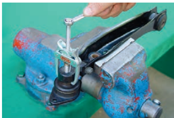
شکل ۳-۸۵ جدا کردن سیبک از بازوی اتصال
