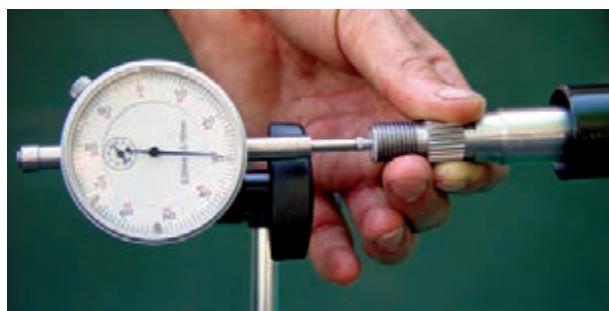
شکل ۶۸-۲ اندازه‌گیری لقی طولی میل فرمان
