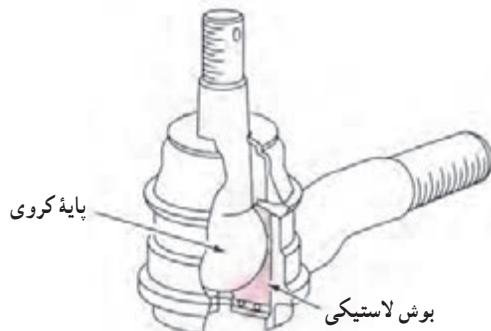
ب - سیبک با بوش لاستیکی (پلاستیکی)
