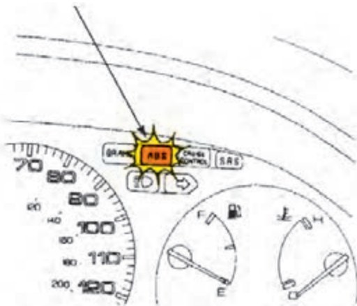
شکل ۱-۱۶۱- چراغ اخطار ترمز ضد قفل (ABS)
