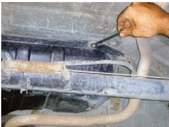
شکل ۱-۲۵ باز کردن پیچهای دور باک
