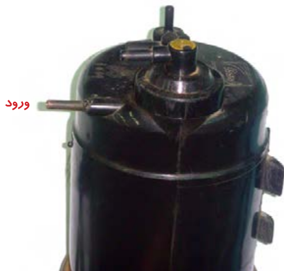
شکل ۱-۹۶ شیر ورودی سوخت‌های تبخیر شده به کنیستر
