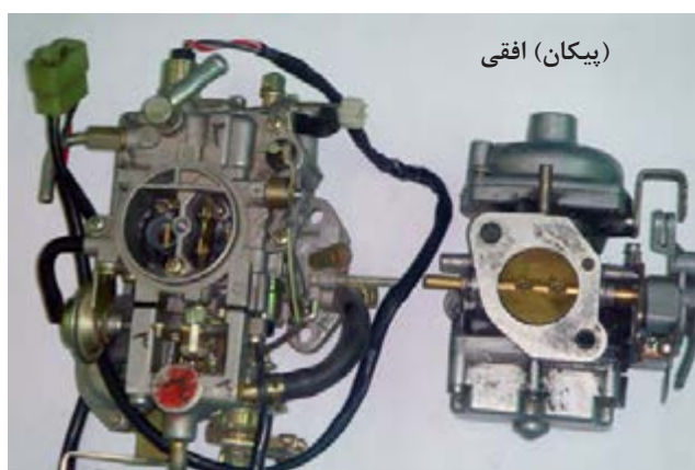
شکل ۱-۶۴ کاربراتورها از نظر حرکت سوخت (نزولی - افقی)
