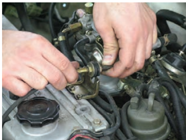
شکل ۱۱۵-۱ پیاده کردن کاربراتور
