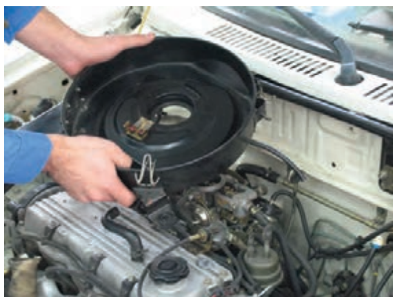
شکل ۱۱۴- ۱ پیاده کردن مجموعه هواکش
