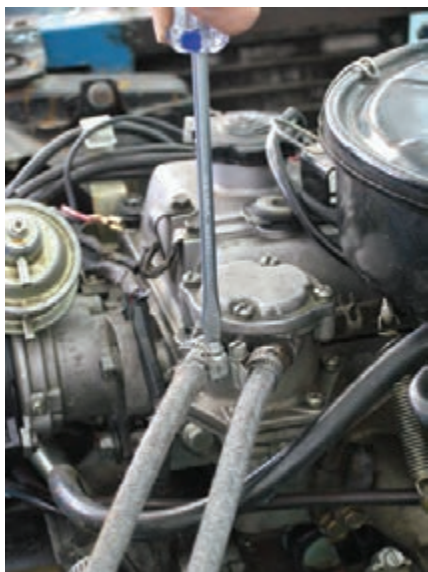
شکل ۱-۳۲ اتصال لوله سوخت به پمپ
