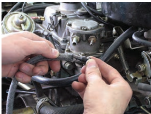
شکل ۱-۴۱ جدا کردن لوله‌ها
