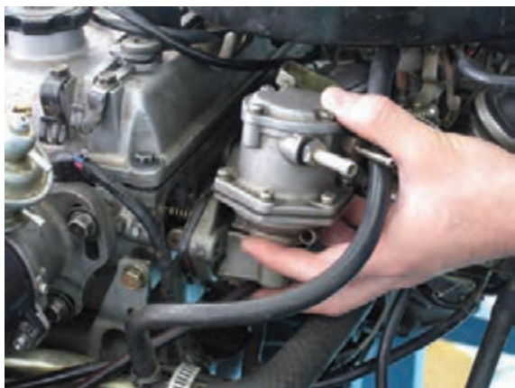
شکل ۱-۴۴ الف: نصب پمپ
