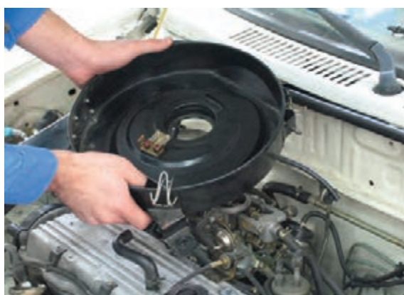
شکل ۱۰۰-۱ پیاده کردن مجموعه هواکش
