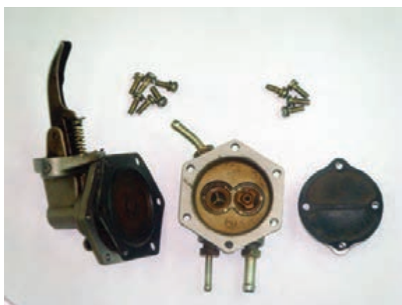
شکل ۱-۴۳ اجزای پمپ سوخت
