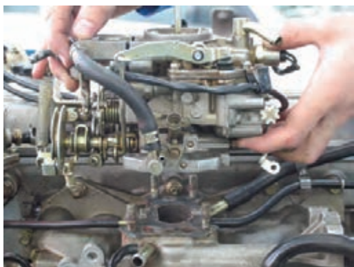
شکل ۱-۱۱۱ پیاده کردن کاربراتور
