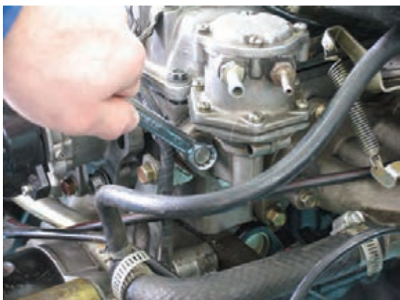
شکل ۱-۴۲ پیاده کردن پمپ
