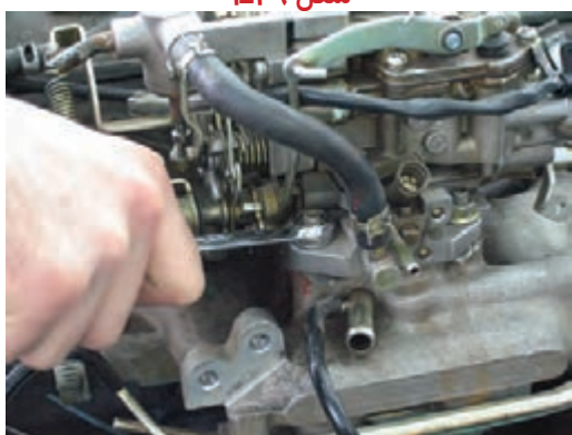
شکل ۱-۱۱۰ باز کردن پیچهای اتصال کاربراتور به موتور
