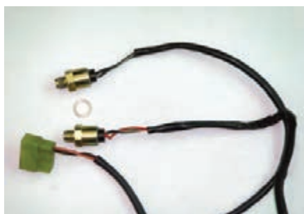
شکل ۱-۹۱ اجزای الکتریکی در یک نوع کاربراتور
