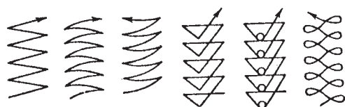
شکل ۳-۳۲- حالت‌های مختلف حرکت نوسانی نوک الکتروود
