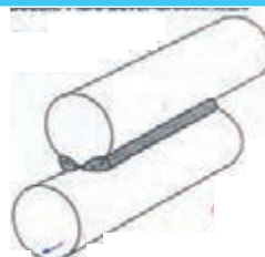
جوش شیاری V شکل لبه برگردان دوطرفه
