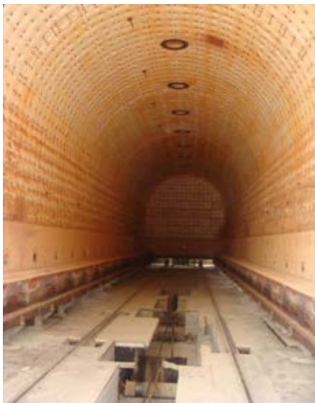
کوره عملیات حرارتی صنعتی با ابعاد بزرگ
