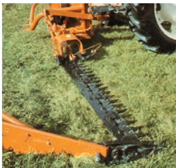
شکل ۱-۸- دروگر شانهای تراکتوری
