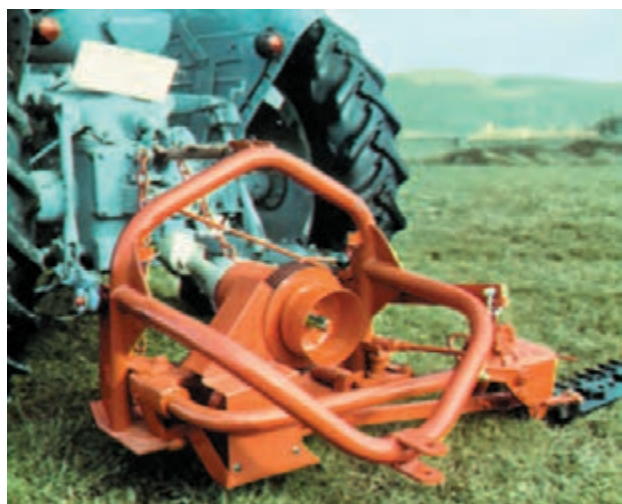
شکل ۱-۹- طرز کار دروگر شانهای
