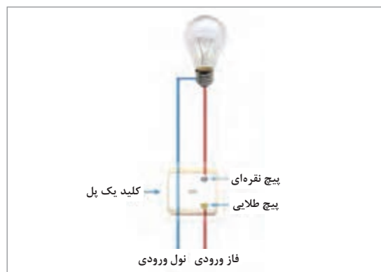
شکل ۳-۳۵- مدار الکتریکی کلید یک پل
