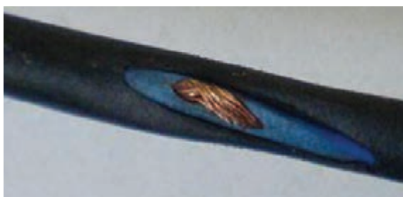
شکل ۱۸-۳- پوسیدگی و زخمی شدن سیم‌ها و کابل‌ها
