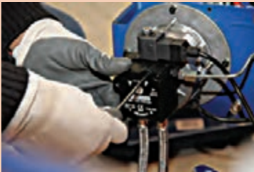
هواگیری پمپ
