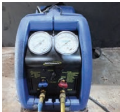
شکل ۱۵- دستگاه بازیافت گاز
