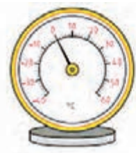
شکل ۱۰- دماسنج دوفلزی حلزونی شکل
