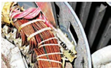
شکل ۳۶- محافظ حرارتی سیم پیچ موتور
