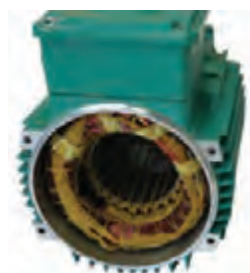
شکل ۱۰- ساختار استاتور
