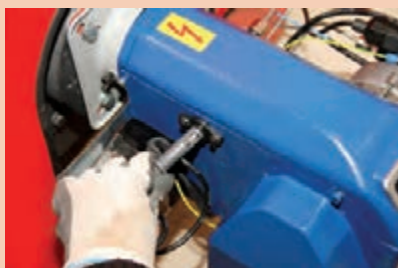
خارج کردن چشم الکتریکی
