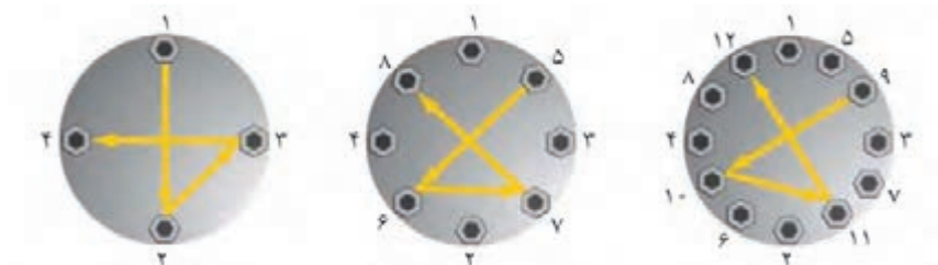
شکل ۲۳- ترتیب سفت کردن پیچ‌های فلنج
