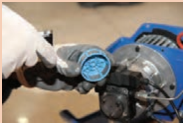
بازکردن درپوش پمپ و تمیز کردن فیلتر
