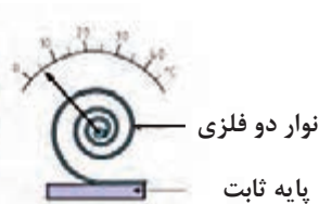
شکل ۱۰- دماسنج دوفلزی حلزونی شکل
