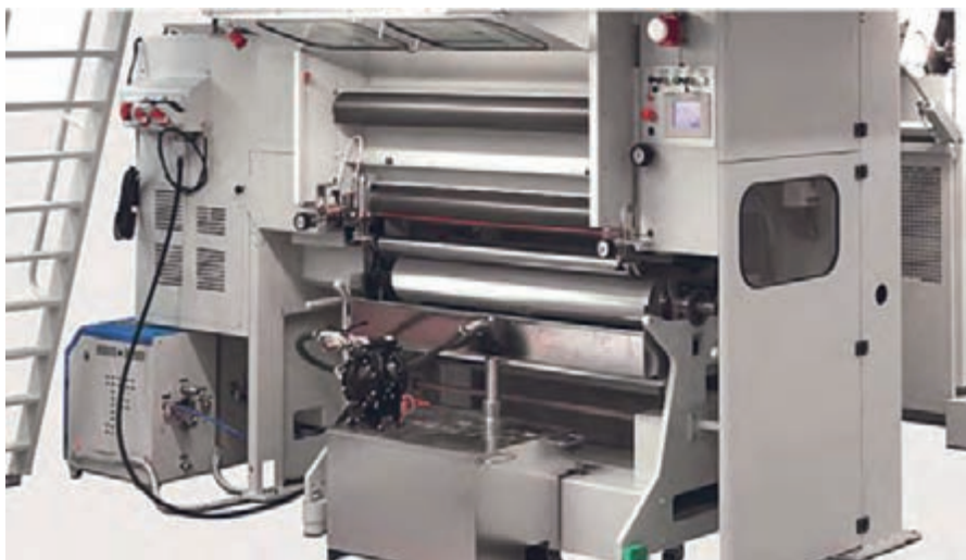
شکل ۴۰- کنترل اتوماتیک گرانروی مرکب
