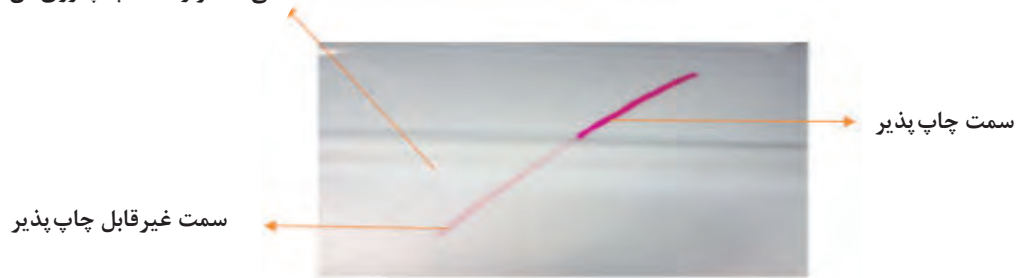
شکل ۲۲- نتیجه تست کرونا تریتمنت
