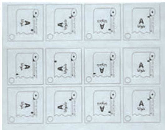
شکل ۲۱- حالت‌های مختلف پیچش رول
