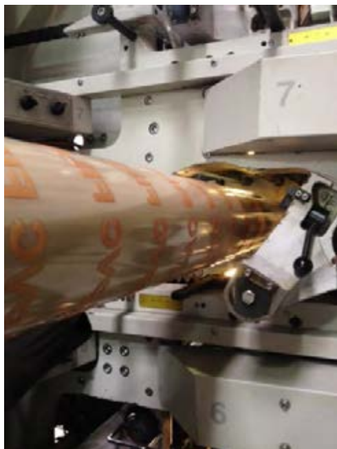
شکل ۳۵- جاگذاری سیلندر کلیشه بر روی آداپتور
