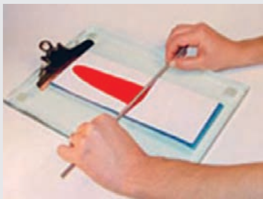
شکل ۲۹- روش کشیدن مرکب با ابزار بارکش
