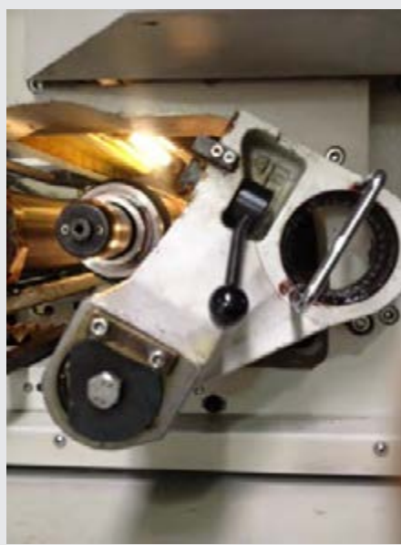
شکل ۳۶ - باز کردن و بستن قفل آداپتور
