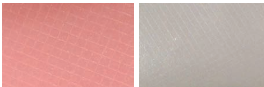
شکل ۱۲- شیاریهای موجود بر روی چسب پایه
