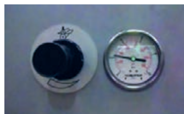
شکل ۵۴- دستگیره تنظیم فشار و گیج آن
