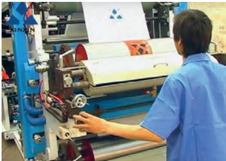
شکل ۲- تنظیم فشار پلیت و سیلندر چاپ
