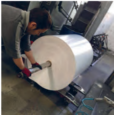
شکل ۳۴- قرار دادن شفت بادی درون بوبین دستگاه
