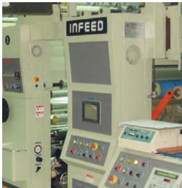
شکل ۴۴- واحد کنترل مجموعه غلتک‌های تنظیم کشش
