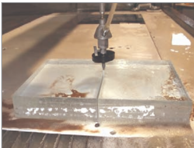
شکل ۳۱- برش شیشه با واتر جت
