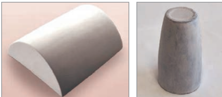
شکل ۲۷- قالب فلزی مورد استفاده در دراپینگ
