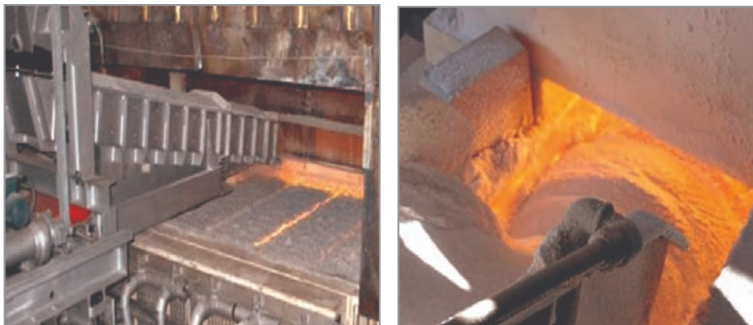
شکل ۲۳- ریختن آمیز به درون کوره
