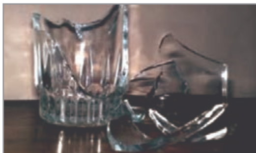
شکل ۸- شکستن شیشه سرد با ریختن مایع داغ
