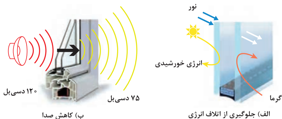
شکل ۴۲- عایق حرارتی و صوتی شیشه دو جداره
