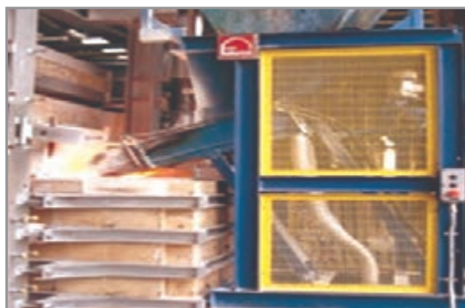
شکل ۱۶- دریچه بارریز کوره‌های شیشه ظروف و بطری
