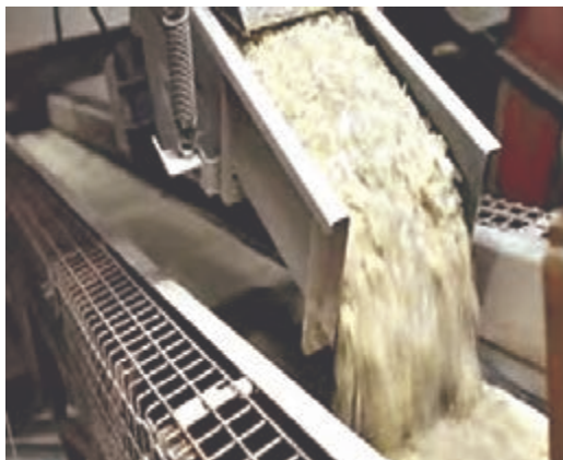
شکل ۲۶- خردایش و آهن‌گیری مواد اولیه
