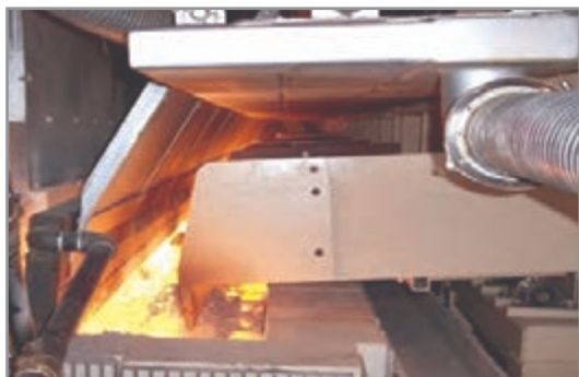
شکل ۱۷- دریچه بارریز کوره‌های شیشه تخت
