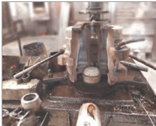
شکل ۱۳- قالب پرس بادی
