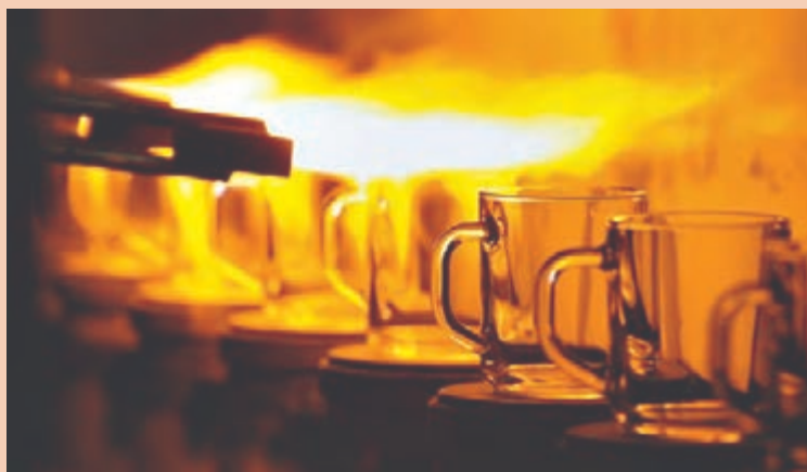
شکل ۳۵- پولیش حرارتی
