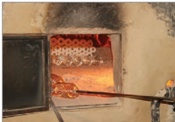
شکل ۳- گرمخانه کارگاه شیشه‌گری
