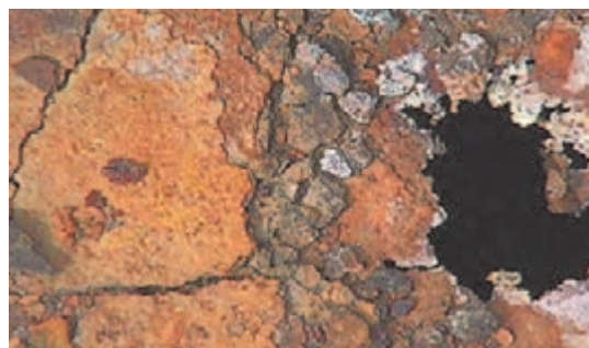
شکل ۶- نمونه‌هایی از خوردگی در دمای بالا
