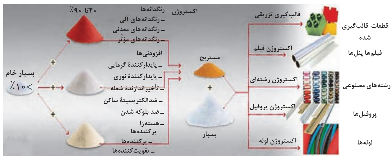
شکل ۶- فرایند تولید مستربچ و قطعات بسپاری
