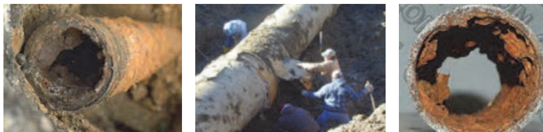
شکل ۴- نمونه‌ای از خوردگی لوله‌های دفن شده
