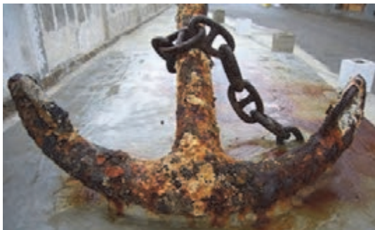
شکل ۳- نمونه‌هایی از خوردگی آب دریا
