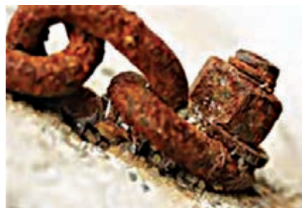
شکل ۵- نمونه‌هایی از خوردگی در قطعه‌های فلزی
