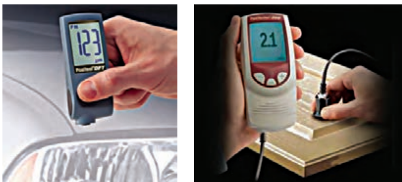
شکل ۲۲- انواع ضخامت سنج فیلم خشک رنگ (غیر تخریبی)
