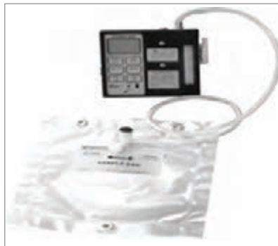
شکل ۲۵- الف) مدار نمونه گیری
