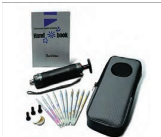
شکل ۱۶- بسته کامل لوله جاذب سطحی
