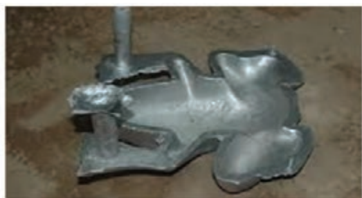
شکل ۲- یک قطعه خام با ناصافی‌ها در سطح
