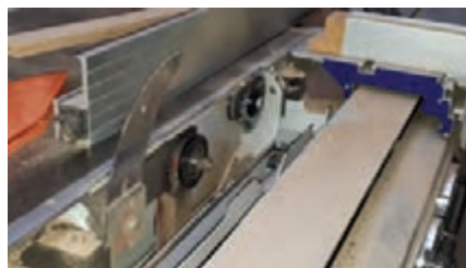
شکل ۶۳- بررسی فلنج پشت تیغه اره
