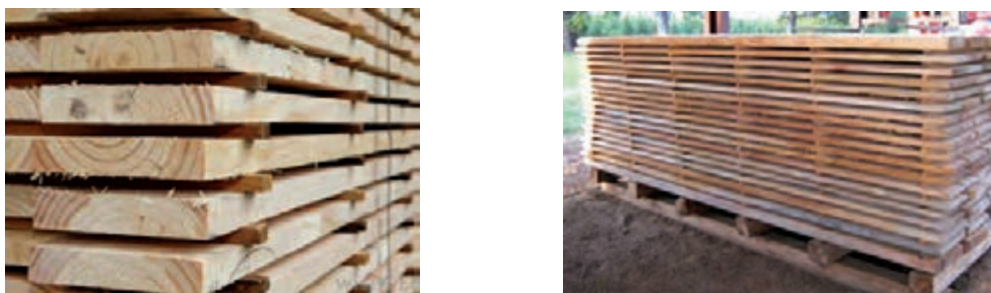
شکل ۱۳- روش چوب‌دستک‌گذاری در دسته‌های چوب
