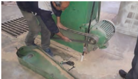
شکل ۵۹- روش باز کردن حفاظ و بررسی تسمه
