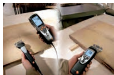
شکل ۶- دستگاه رطوبت سنج نوع دی الکتریک
