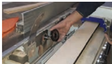
شکل ۶۲- باز کردن مهره و فلنج جلوی تیغه
