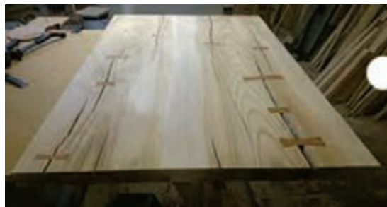
شکل ۶- اتصال دم چلچله پروانه‌ای
