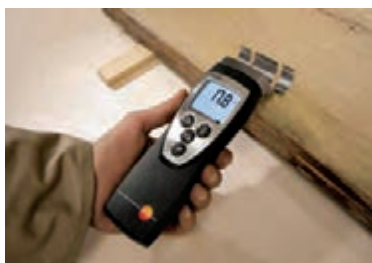
شکل ۶- دستگاه رطوبت سنج نوع دی الکتریک
