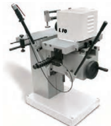
شکل ۳۷- نمونه‌ای از ماشین کم کن مته‌ای افقی
