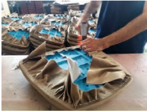
شکل ۸۰- مراحل رویه کوبی
