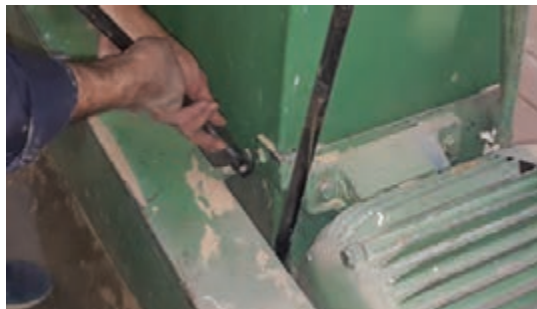
شکل ۵۹- روش باز کردن حفاظ و بررسی تسمه
