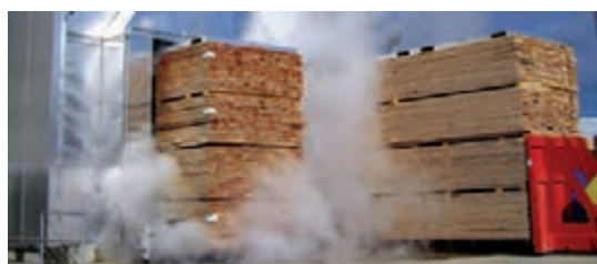
شکل ۶۴- اصول دسته‌بندی چوب روی واگن
