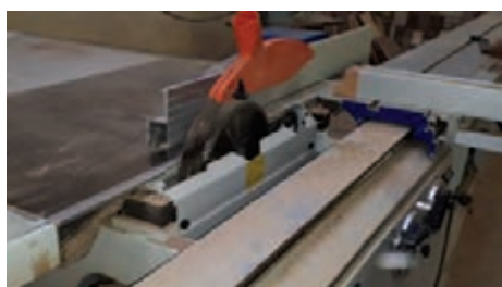
شکل ۶۷- بستن حفاظ و کاور روی تیغه اره
