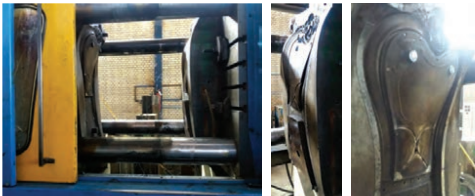
شکل ۷۴- قالب‌های مورد استفاده در ساخت مبل پلیمری
