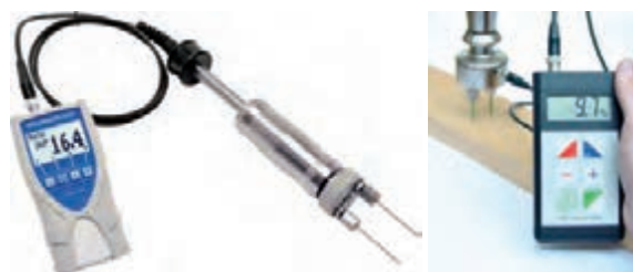
شکل ۷- دستگاه رطوبت سنج نوع مقاومت الکتریکی
