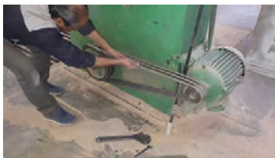
شکل ۶۰- تعویض و جایگزین کردن تسمه
