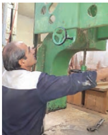
شکل ۱۷- خارج کردن تیغه از روی فلک‌های ماشین اره نواری
