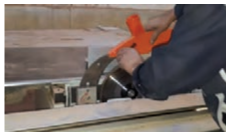
شکل ۶۷- بستن حفاظ و کاور روی تیغه اره
