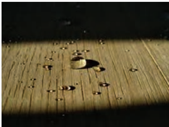
شکل ۷۲- نمونه چوب ضد آب شده با کمک نانوذرات
