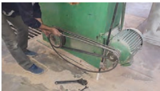
شکل ۶۰- تعویض و جایگزین کردن تسمه
