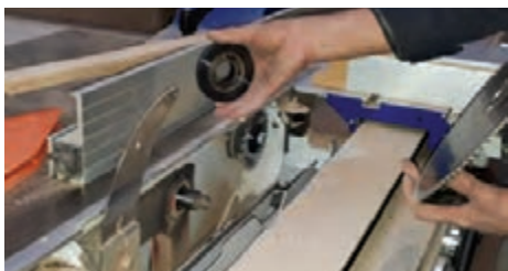
شکل ۶۳- بررسی فلنج پشت تیغه اره
