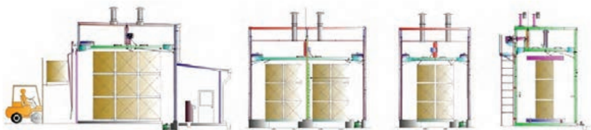
شکل ۲۱- اندازه‌های مختلف کوره حجره‌ای (اتاقکی)
