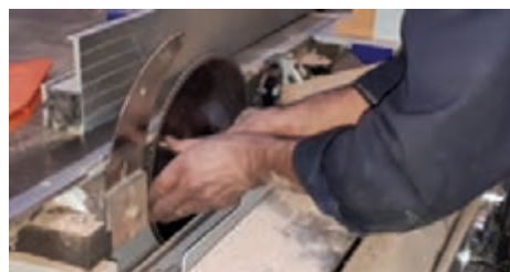
شکل ۶۵- بستن تیغه نو و نصب فلنج جلوی تیغه اره
