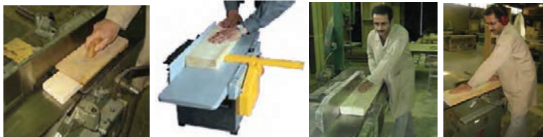
شکل ۲۹- نحوه رندیدن صحیح قطعه کار چوبی
