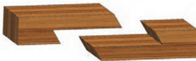
شکل ۳۸- اتصال طولی نیم ونیم
