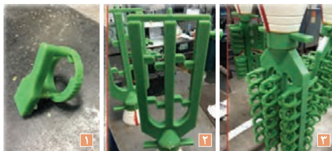
شکل ۱۹- شماره ۱: مدل مومی با راهباره به تنهایی شماره ۲: راهگاه به تنهایی شماره ۳: مدل خوشه‌ای
