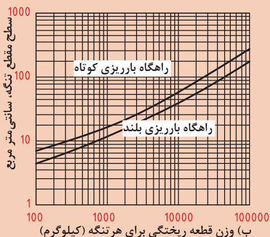
شکل ۱۴- محاسبه سطح مقطع تنگه بر اساس وزن قطعه ریختگی
