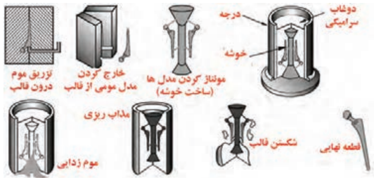
شکل ۲۳- مراحل مختلف ریخته‌گری دقیق به روش توپر
