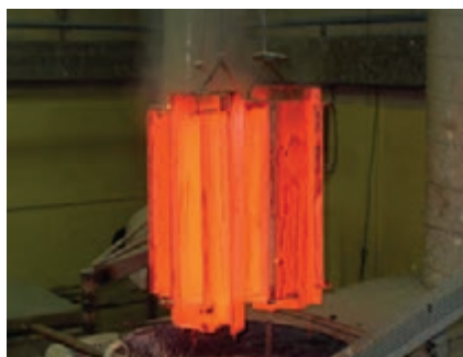
شکل ۳۰- کربوره کردن مایع در حمام نمک
