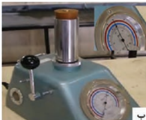
شکل ۳۳- مراحل انجام آزمایش قابلیت نفوذ گاز
