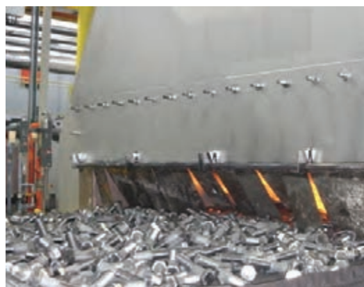
شکل ۶- کوره عملیات حرارتی مداوم
