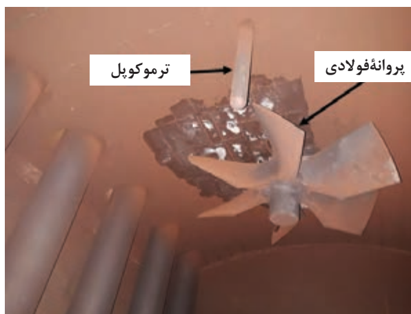
شکل ۱۴- فن گردش هوا در داخل کوره
