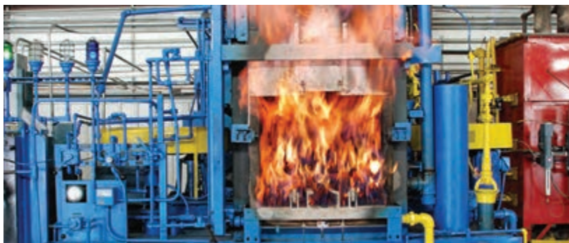
شکل ۵- کوره با اتمسفر کنترل شده
