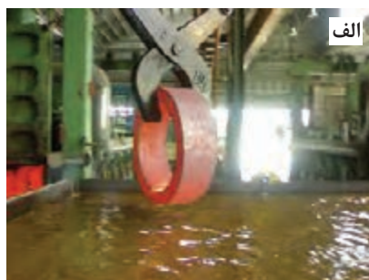
شکل ۲۳- وارد کردن قطعات به محیط خنک کننده
