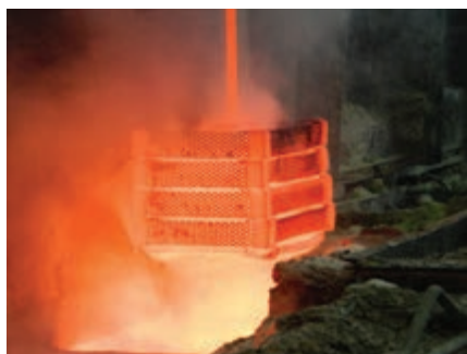
شکل ۳۰- کربوره کردن مایع در حمام نمک
