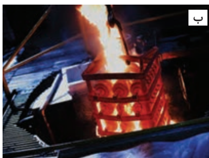
شکل ۲۳- وارد کردن قطعات به محیط خنک کننده
