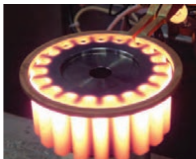
شکل ۳۳- سخت کردن چرخ دنده به روش القا
