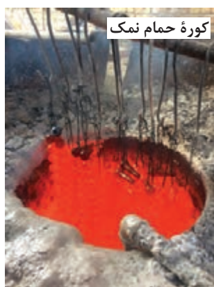
شکل ۲۱- هم‌دما کردن قطعات در کوره‌ها
