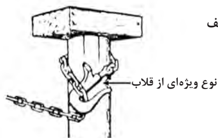
الف) نحوه بستن قلاب به دور پایه
