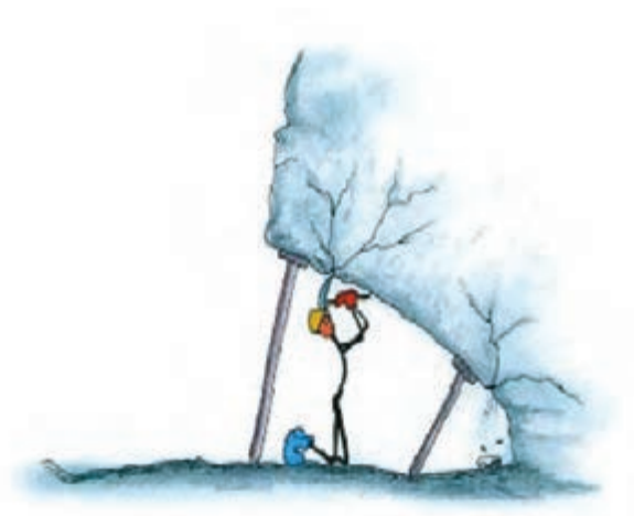
ایجاد زیر برش با نصب وسیله نگهدارنده
