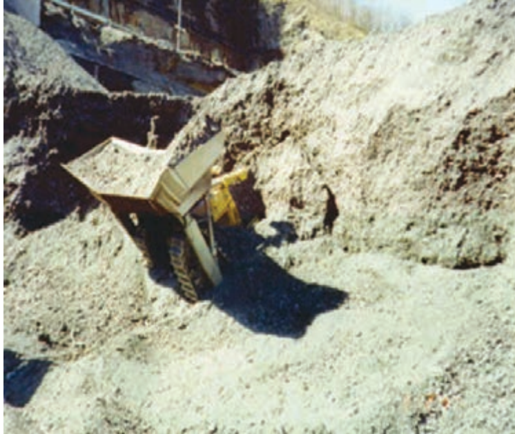
ریزش خاک‌های نرم بر روی ماشین معدنی
