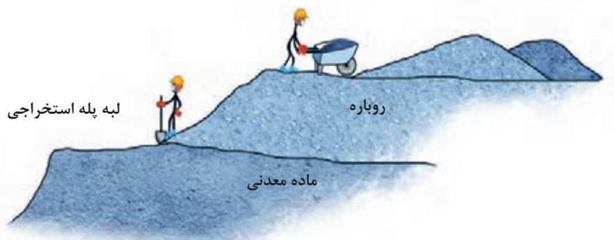
نحوه برداشت روباره در معادن روباز
