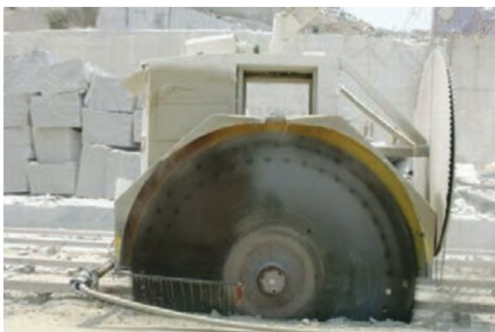
دستگاه دیسک برنده در حال برش سنگ
