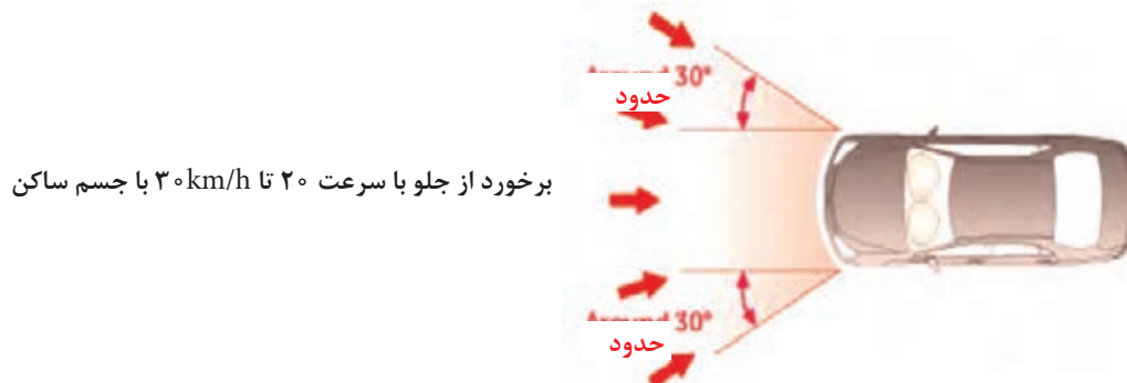
شکل ۵۴- شرایط فعال کردن کیسه هوای ایمنی (در برخورد از جلوی خودرو)
