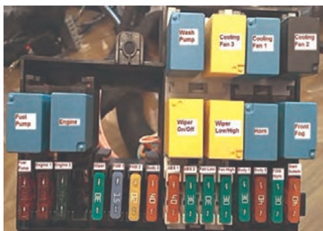
شکل ۲۰- جعبه فیوز یک خودرو
