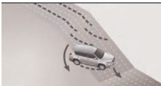
شکل ۲۸- خودروی فاقد سیستم DAC، در سراسیمه‌های تند در زمان ترمزگیری چرخ‌ها را قفل می‌کند.
