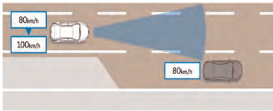
شکل ۳۳- کنترل سرعت شتاب در سرعت‌های کم
