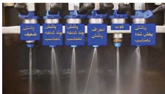
شکل ۷۷- انواع احتمالی پاشش سوخت در انژکتور
