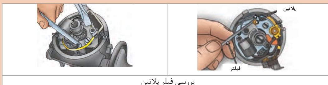
شکل ۳۰- برخی نکات مهم در باز کردن، بررسی و تنظیم دلكو
