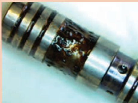
شکل ۴۵- خرابی انژکتور در اثر بودن آب در سوخت
