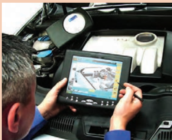
شکل ۴۴- بستن انژکتور الکترومکانیکی جدید با دستگاه عیب‌یاب
