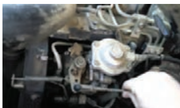
شکل ۸۱- بازدید، بررسی و تنظیم اهرم‌بندی گاز و خاموش کن
