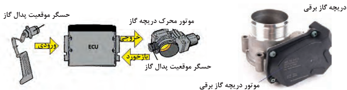
شکل ۳۱- دریچه گاز برقی و سیستم کنترل آن
