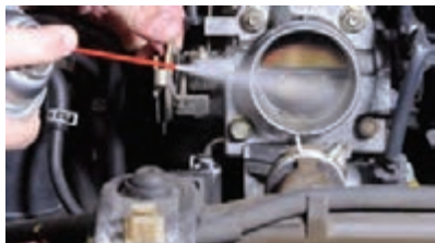
شکل ۸۱- سرویس دریچه گاز
