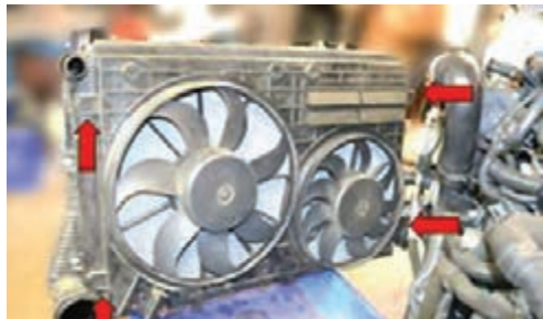
جداکردن رادیاتور خنک کن هوا از مجموعه سینی فن
