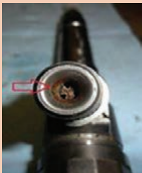
شکل ۴۵- خرابی انژکتور در اثر بودن آب در سوخت
