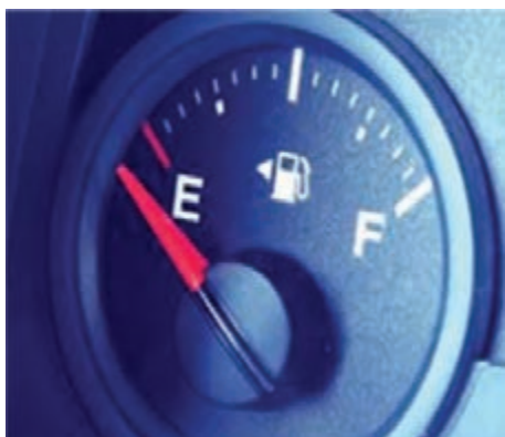
شکل ۹۱- نمایشگر سوخت آنالوگ (عقربه ای)
