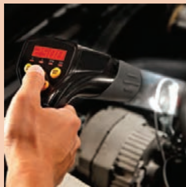
شکل ۲۱- روش کاربری چراغ تایمینگ
