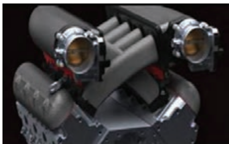
شکل ۳۶- دو نمونه مانیفولد متغیر هوای ورودی
