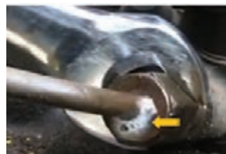
شکل ۸۴- انواع مکانیزم‌های هواگیری در سیستم‌های سوخت‌رسانی دیزل
