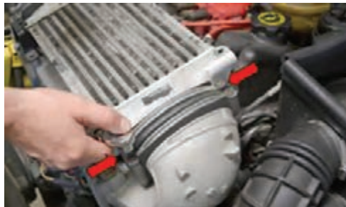
بازکردن اتصالات مجموعه خنک کن
