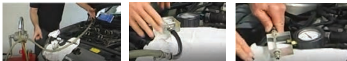
ادامه شکل ۷۶- بررسی و تعویض فیلتر سوخت
