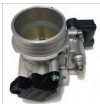
شکل ۲۹- مجموعه کامل دریچه گاز
