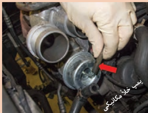
شکل ۲۷- پمپ خلأ مکانیکی
