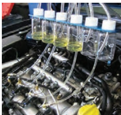
شکل ۴۰- تست اندازه گیری مقدار سوخت برگشتی انژکتورها
