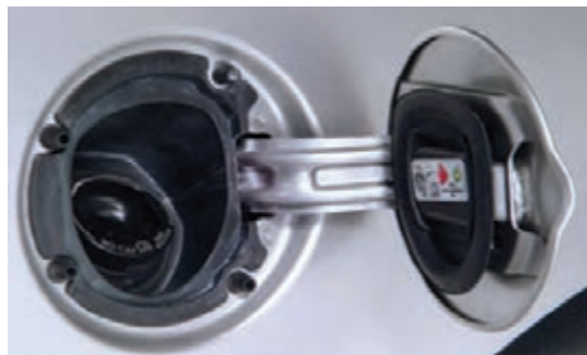
شکل ۷۲- در مخزن سوخت
