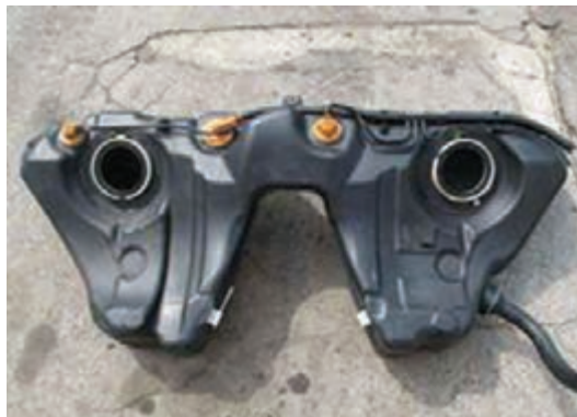
شکل ۷- مخزن سوخت با سوپاپ واژگونی
