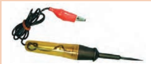
شکل ۵۴- دو نمونه تست لامپ
