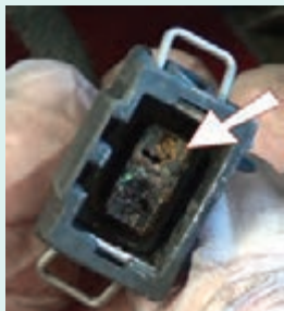
شکل ۶۲- یک نمونه سوکت معیوب
