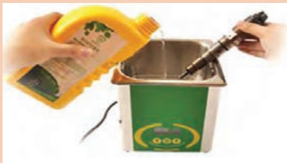
شکل ۸۳- تمیز کردن سوراخ انژکتور با دستگاه اولتراسونیک
