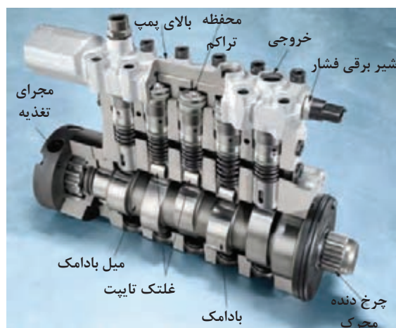
شکل ۱۰- یک نمونه پمپ انژکتور ردیفی
