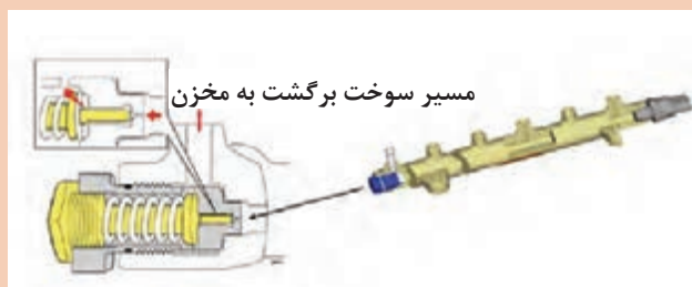
شکل ۱۵- سوپاپ کنترل فشارمکانیکی در تزریق ریل مشترک
