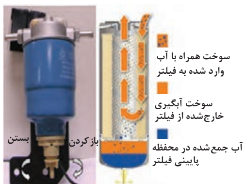
شکل ۷۸- فیلتر اولیه سوخت دیزل با پیچ تخلیه آب
