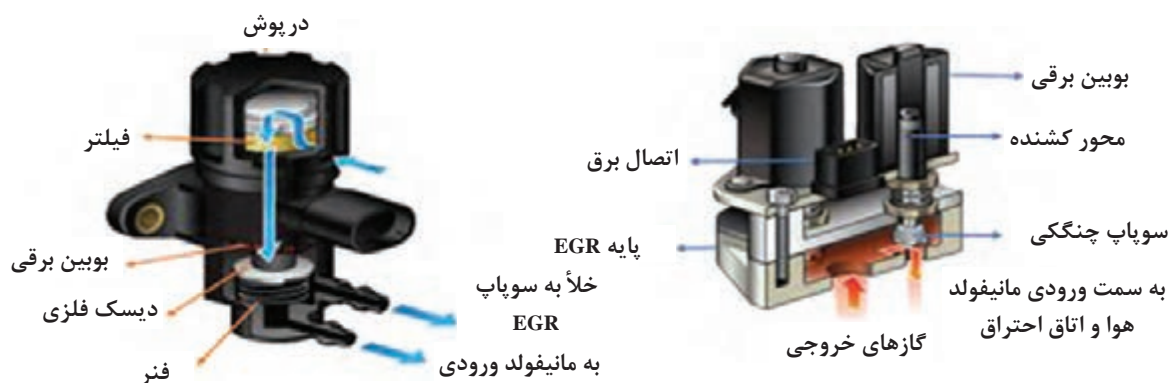
شکل ۱۶- شیر برقی EGR مدل بیرونی و داخلی
