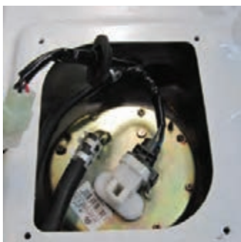
اتصال با پیچ و واشر لاستیکی
