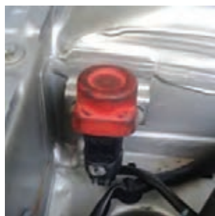
شکل ۲۳- یک نوع سوئیچ اینرسی
