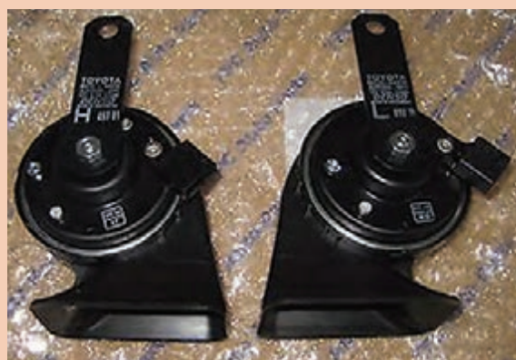
شکل ۴۸- درج L و H روی دستگاه بوق
