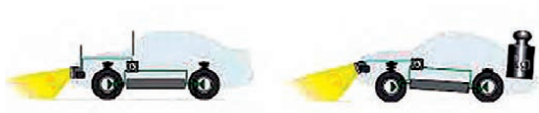
شکل ۹- دلیل نیاز به سیستم تنظیم ارتفاع چراغ
