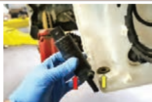
شکل ۳۰- مراحل تعویض پمپ شیشه شوی
