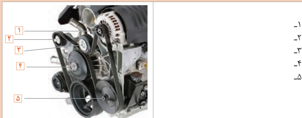
شکل ۵۶- اجزای محرک آلترناتور (روش انتقال گشتاور به پولی)
