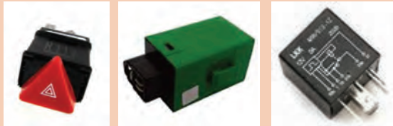
شکل ۱۶- برخی از انواع اتوماتیک راهنما و فلاشر
