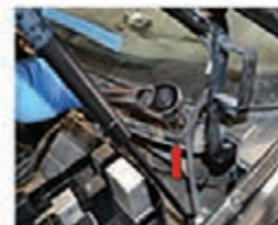
۹- اتصال اهرم‌بندی به بدنه را تمیز باز کنید.
