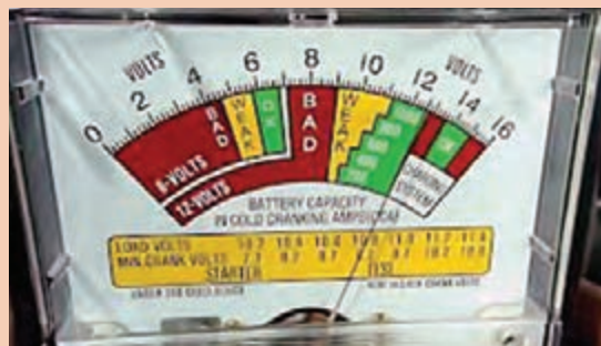
شکل ۵۱- نشان دهنده دستگاه آزمایش باتری
