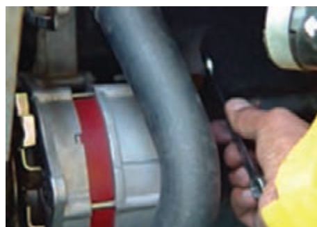
باز کردن پیچ‌های پایه آلترناتور
