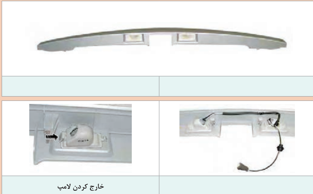
شکل ۳۵- روش باز کردن و بستن چراغ پلاک
