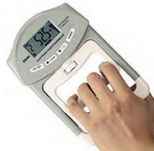
تصویر اندازه‌گیری قدرت عضلات دست با دینامومتر
