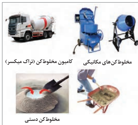
شکل ۱۳- انواع روش های اختلاط بتن
