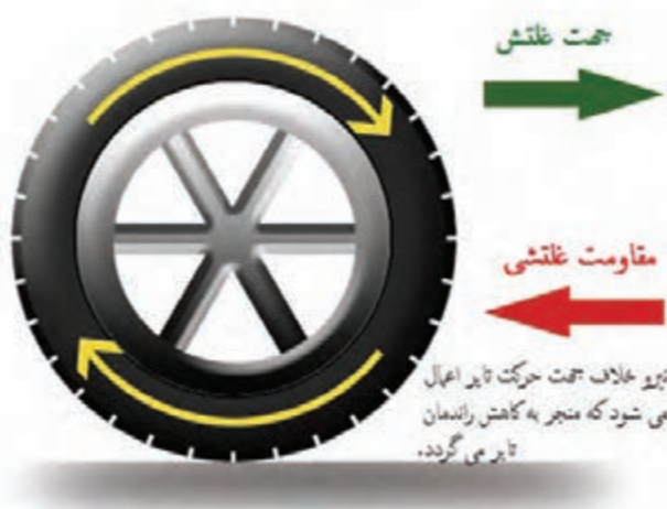
شکل ۱- جهت غلتش تأیر و مقاومت غلتشی
