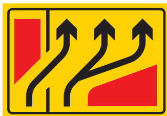
شکل ۴۵- نمونه‌ای از تابلوهای اخباری انحراف مسیر
