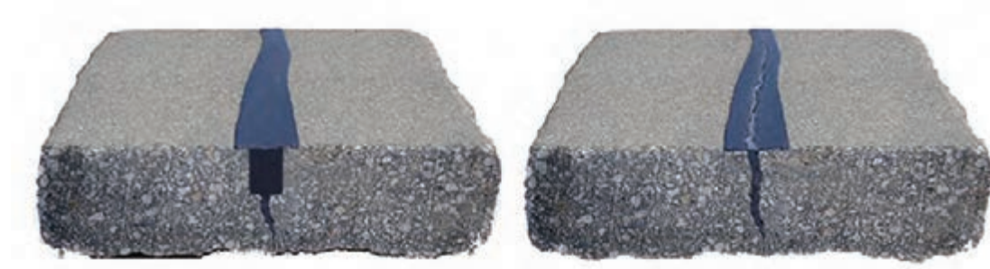
شکل ۱۰- سمت راست: درزگیری ترک با روش پرکردن، سمت چپ: درزگیری ترک با روش آب بندی (برش ترک و ایجاد مخزن برای ماده درزگیر)
