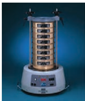
شکل ۸- دستگاه شیکر یا لرزاننده
