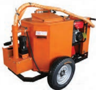
شکل ۲۳- نمونه‌ای از دستگاه درزگیر آسفالت
