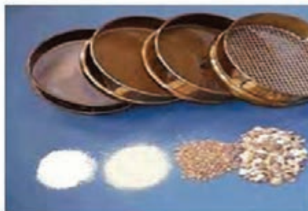
شکل ۷- سری الک های استاندارد دانه بندی خاک
