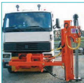
شکل ۳۶- نمونه‌هایی از نصب چکش‌های هیدرولیکی گاردریل کوب و چگونگی حمل آنها
