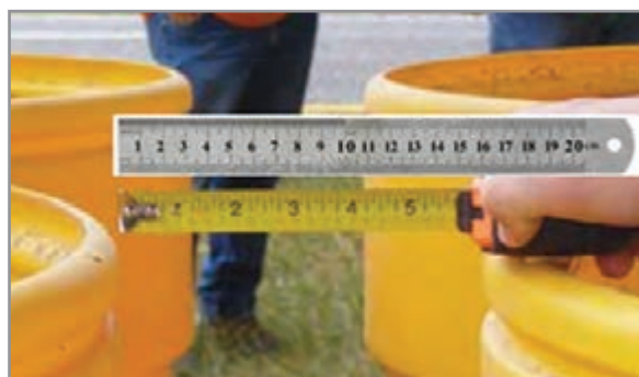
شکل ۲۶ - حداقل فاصله بین بشکه‌ها و بین بشکه تا حفاظ سخت انتهایی
