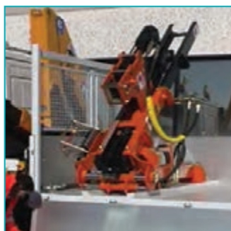
شکل ۳۶- نمونه‌هایی از نصب چکش‌های هیدرولیکی گاردریل کوب و چگونگی حمل آنها
