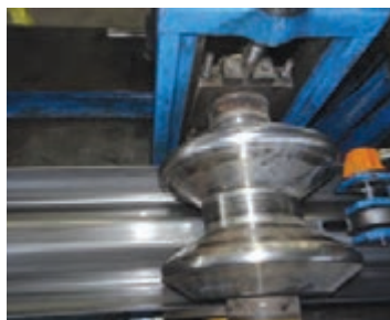
شکل ۴- ساخت و تولید گاردریل به روش نورد
