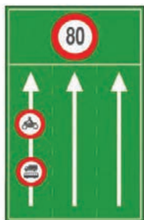
شکل ۳۶- تابلوی ترکیبی محدودیت سرعت به همراه ممنوعیت تردد کامیون اتوبوس و موتورسیکلت از خط سبقت در بزرگراه
