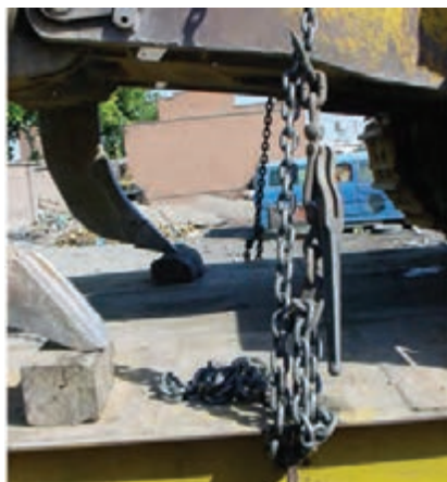
شکل ۲۷- بستن قسمت‌های مفصلی ماشین آلات راه‌سازی
