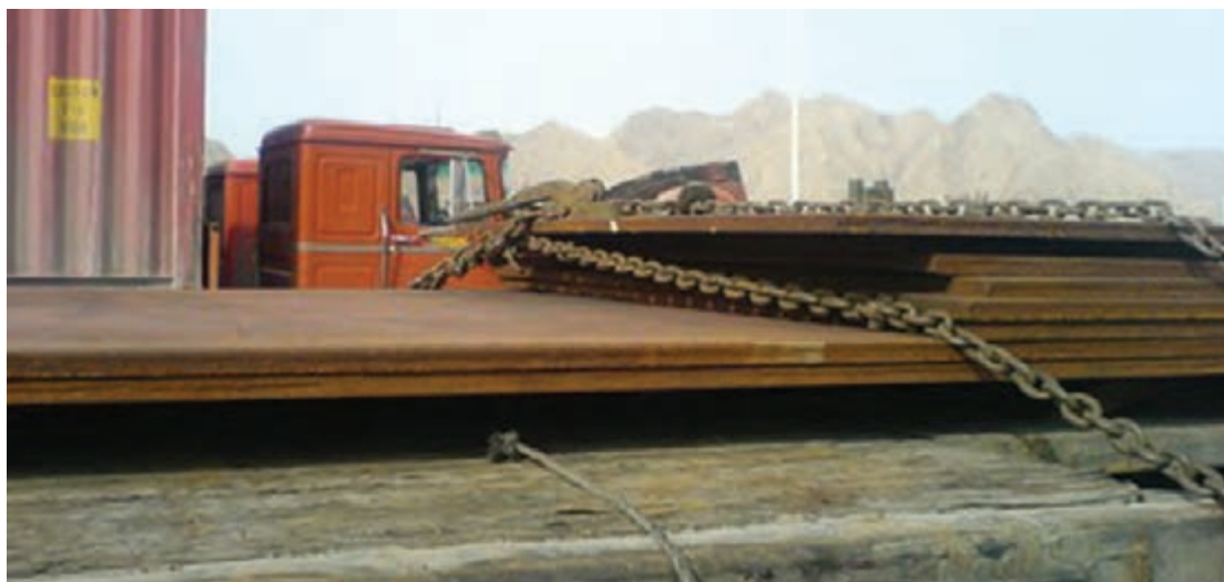
شکل ۳۴- نمونه‌ای از مهر نادرست ورق (بار تخت) توسط زنجیر
