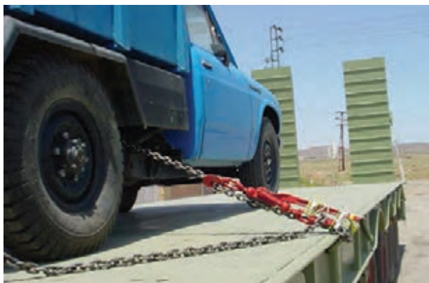
شکل ۲۲- نمونه‌ای از مهار نادرست یک اتومبیل
