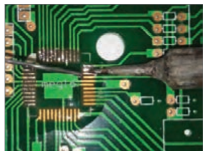
شکل ۵۰- قلع اندود کردن محل پایه ها با هویه و سیم لحیم
