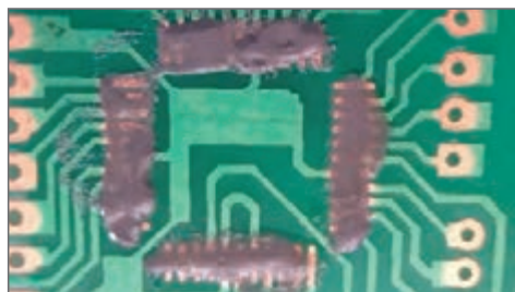
شکل ۵۴- قرار گرفتن خمیر قلع روی تمامی پدها
