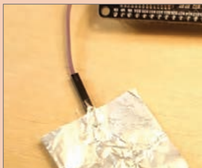
شکل ۳۹- سنسور لمسی با فویل آلومینیومی
