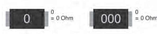
شکل ۱۴- اتصال کوتاه‌کننده صفر اهمی / مقاومت‌های SMD
