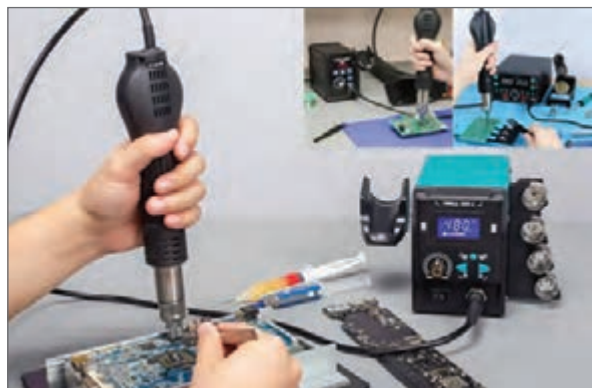
شکل ۳۲- دمونتاژ برد با تکنولوژی SMT
