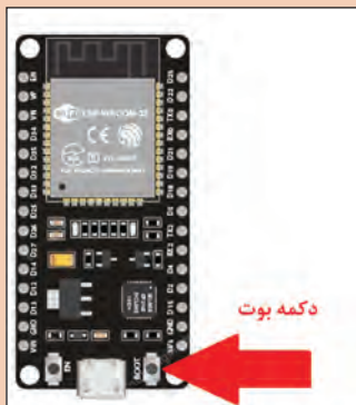
شکل ۳۸- دکمه Boot در برخی بُردها هنگام آپلود برنامه باید نگه داشته شود.
