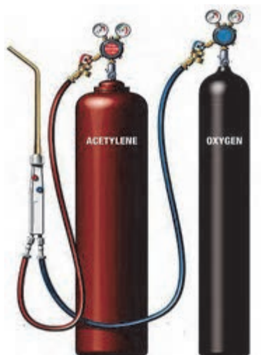
شکل ۲۹- یک واحد جوش کاری گاز
