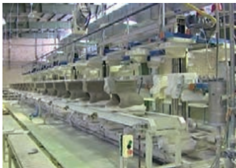
شکل ۴۲- بیرون آوردن قطعه از قالب به روش ماشینی
