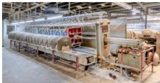
شکل ۷- ریخته‌گری دوغابی با فشار پایین
