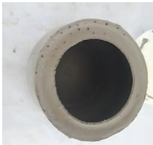
شکل ۶۸- عیب سوراخ‌های سنجاقی در سطح قطعه
