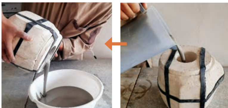
شکل ۳- ریخته‌گری دوغابی توخالی به روش دستی
