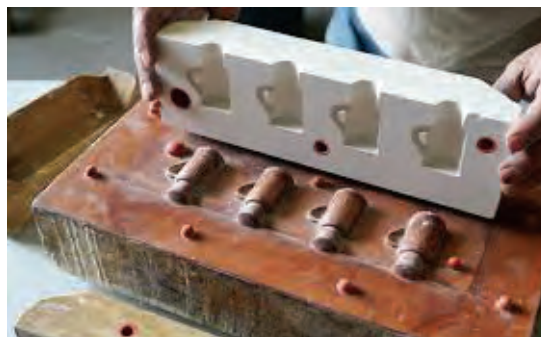
شکل ۱۰- قالب گچی با قابلیت ریخته‌گری چهار قطعه
