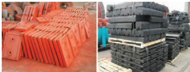
شکل ۲۴- آستر لاستیکی بال میل
