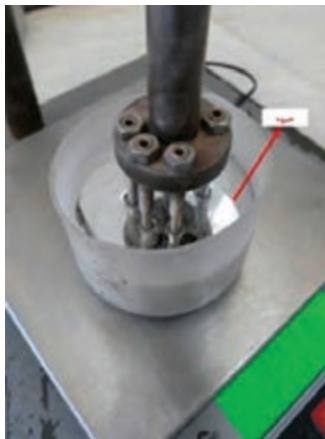
شکل ۱۱- محاسبه حجم به روش غوطه‌وری نمونه در جیوه
