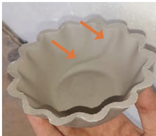
شکل ۷۱- عیب چین و شکن (هلالی شکل) در سطح داخلی قطعه
