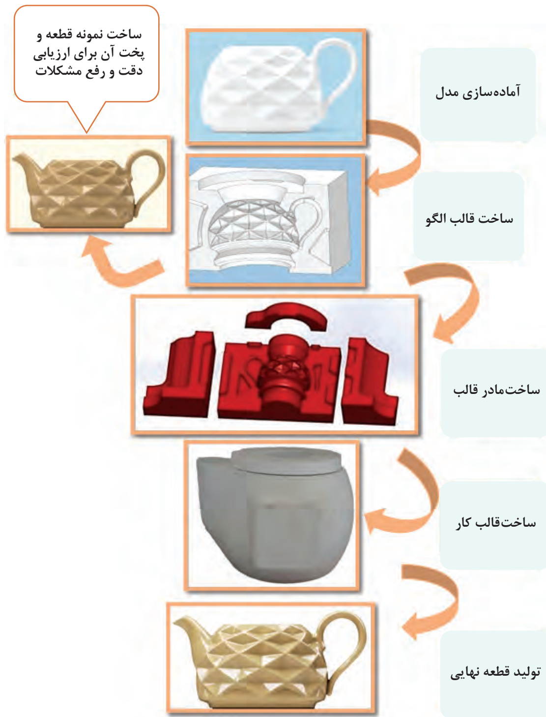
شکل ۲- مراحل ساخت قطعه سرامیکی
