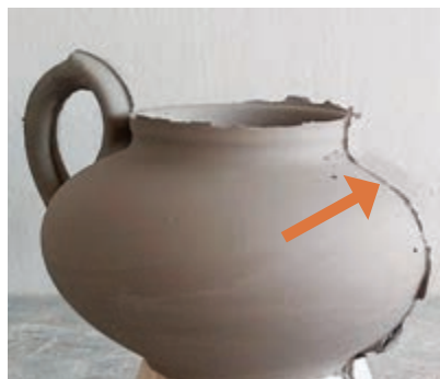
شکل ۷۲- عیب درز قالب
