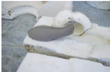
شکل ۵۳- شکل‌دهی جداگانه لوله و بدنه قوری
