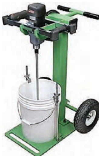
شکل ۲۲- هم زدن دوغاب قبل از ریخته‌گری
