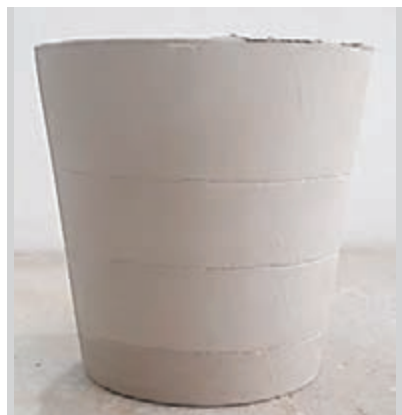
شکل ۷۴- عیب رگه‌رگه شدن در سطح بیرونی قطعه
