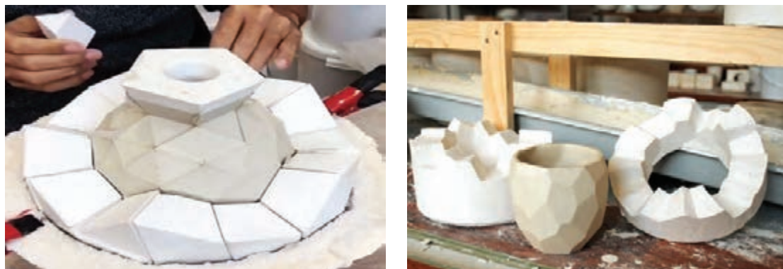
شکل ۱۵- قالب‌های گچی با پیچیدگی زیاد
