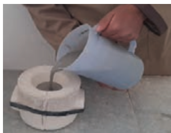
شکل ۲۴- ریختن دوغاب درون قالب
