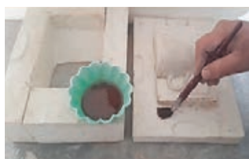
شکل ۸- نفوذناپذیر کردن مادر قالب با مایع مناسب
