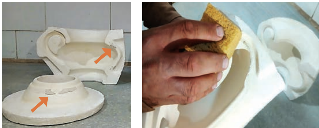
شکل ۱۳- بررسی قالب و جدا کردن لایه‌های دوغاب خشک شده از آن
