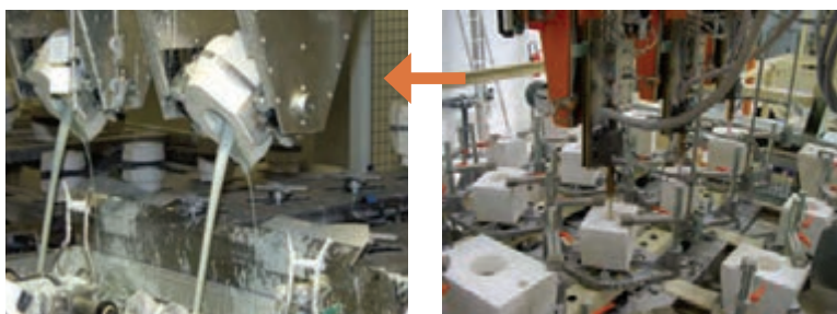
شکل ۴- ریخته‌گری دوغابی توخالی به روش دستگاهی
