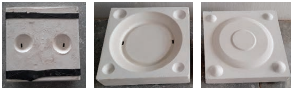
شکل ۳۳- بررسی قالب و بستن آن
