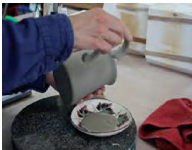
شکل ۵۴- دوغاب با روانی کم برای مونتاژکاری
