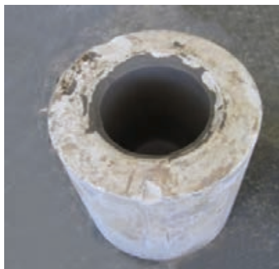
شکل ۶۴- قالب نمونه برای تعیین سرعت ریخته گری
