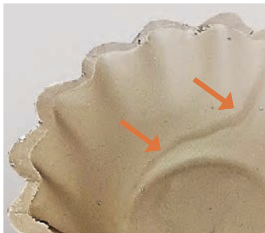
شکل ۷۱- عیب چین و شکن (هلالی شکل) در سطح داخلی قطعه
