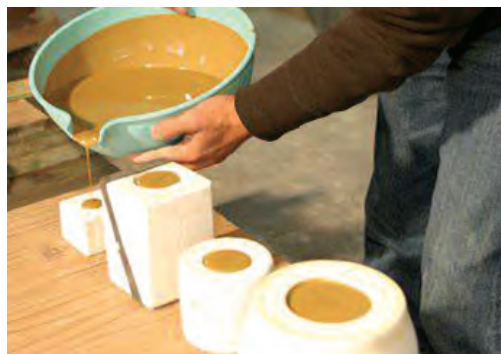
شکل ۶۹- پر کردن قالب با سرعت مناسب
