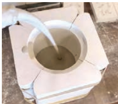
شکل ۲۵- شیوه صحیح ریختن دوغاب درون قالب
