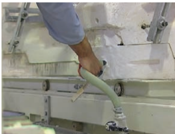
شکل ۲۷- مجرای زیر قالب جهت تخلیه دوغاب
