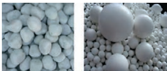
الف) آلومینایی ب) فلینتی شکل ۲۱- گلوله‌های آلومینایی و فلینتی بال میل
