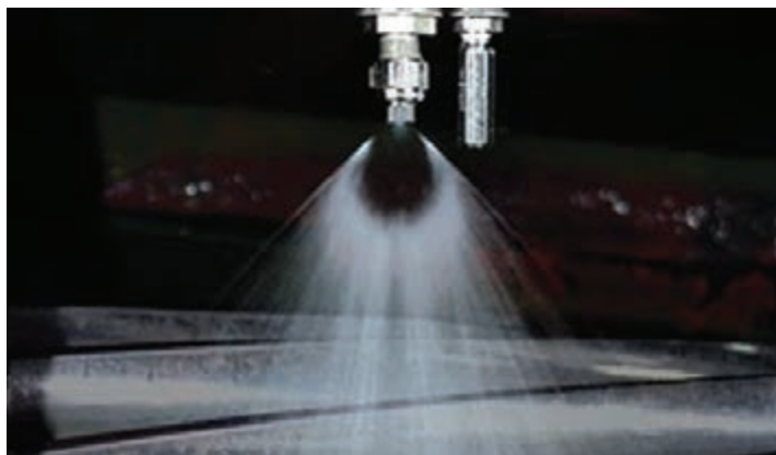
شکل ۱۵- روغن کاری پاششی
