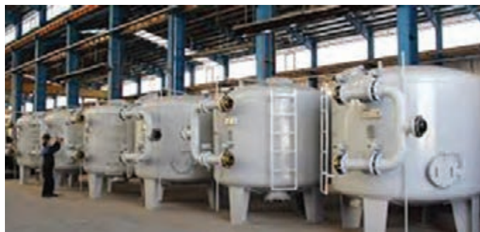
شکل ۴- نمای درونی و بیرونی صافی صنعتی
