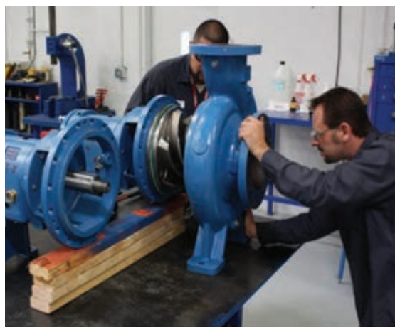
شکل ۲- تعمیر اساسی پمپ در کارگاه مکانیک
