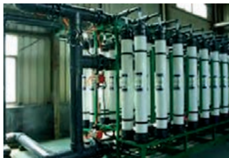
شکل ۱۰- نمایی ساده و واقعی از فرایند اولترافیلتراسیون
