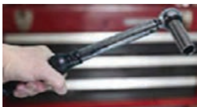
شکل ۲۳- آچار ترک یا آچار گشتاور
