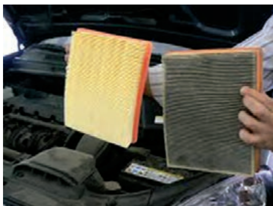
شکل ۱۹- فیلتر هوای تمیز و کار کرده
