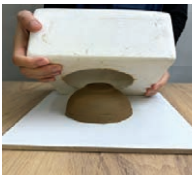
شکل ۳۴- خارج کردن قطعه از درون قالب
