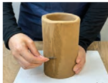
شکل ۲۶- پرداخت دیواره با تیغ اره
