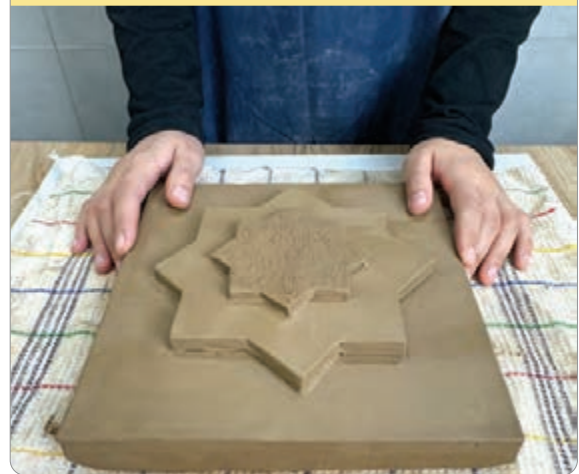
شکل ۴۲- کاشی نقش برجسته با روش اتصال نقش افزوده
