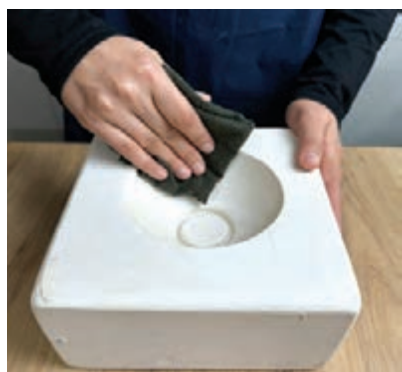
شکل ۲۲- پاک کردن سطح قالب
