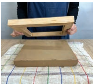
شکل ۱۸- خارج کردن خشت از کلاف بدون کفه
