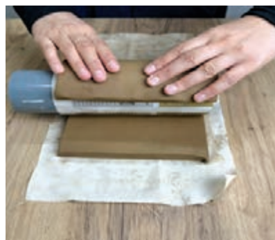
شکل ۵۶- پیچیدن ورقه گل به دور لوله
