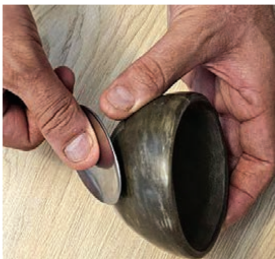
شکل ۱۴- چگونگی داغدار کردن سطح بدنه
