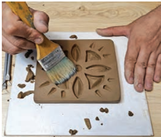
شکل ۳۷- تمیز کردن سطح خشت با قلم‌مو
