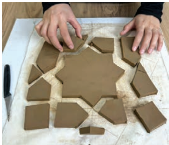
شکل ۴۶- جدا کردن قطعات بریده شده
