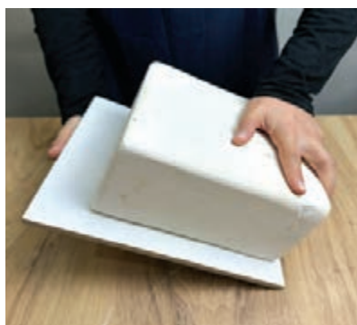
شکل ۳۳- برگردان قالب بر روی سطح زیرکار
