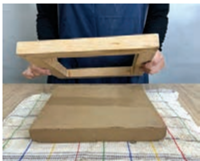
شکل ۲۸- کلاف جدا شده از قالب
