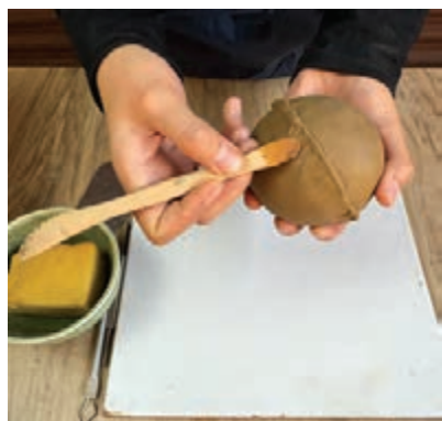
شکل ۶۹- محو کردن نوار گلی با ابزار افزاینده
