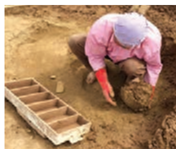
شکل ۸- ساخت آجر درون قالب چوبی
