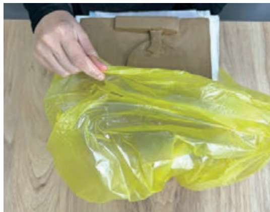
شکل ۶۱- قرار دادن خشت درون نایلون
