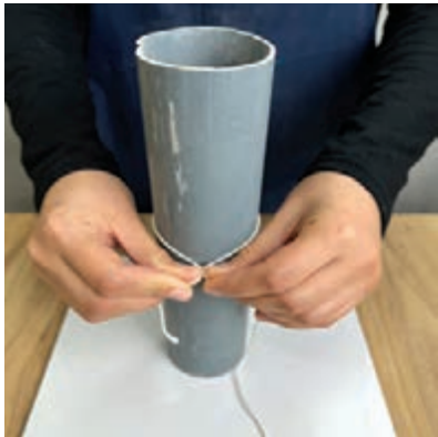
شکل ۵۳- اندازه‌گیری قطر استوانه با نخ
