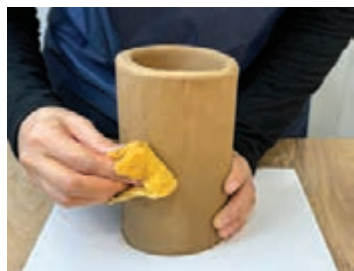
شکل ۲۸- پرداخت دیواره با ابر
