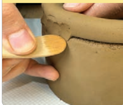
شکل ۱۵- اتصال فتیله‌ها با ابزار
