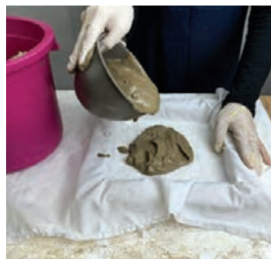
شکل ۲۷- ریختن دوغاب گل جهت آبگیری
