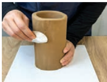
شکل ۲۷- پرداخت دیواره با لیسه
