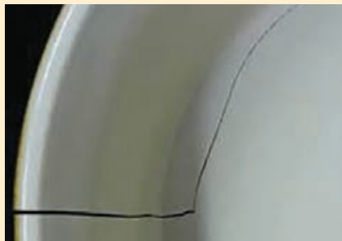
ترک خوردن قطعه به دلیل ضخامت زیاد لعاب در بخش بیرونی
