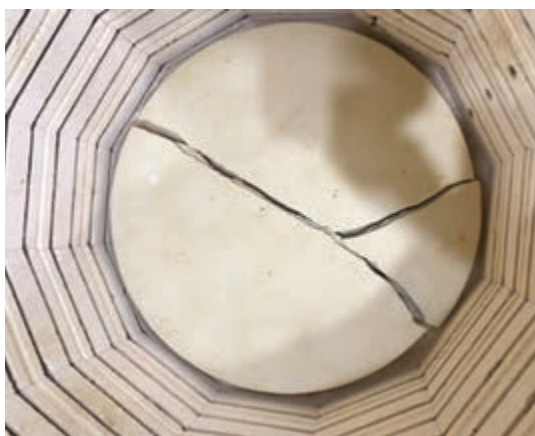
شکل ۳۹- شکستن صفحه کوره به علت وزن بیش از اندازه
