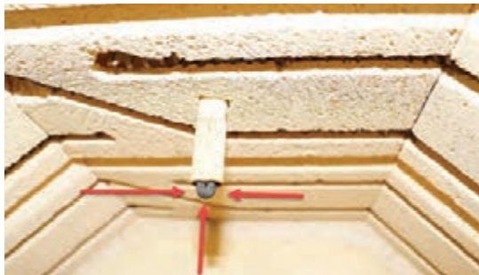
شکل ۲۱- محل قرارگیری ترموکوپل در داخل کوره الکتریکی
