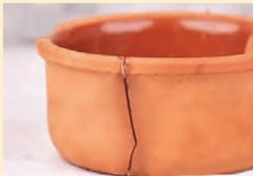
ترک خوردن قطعه به دلیل ضخامت زیاد لعاب در بخش داخلی
