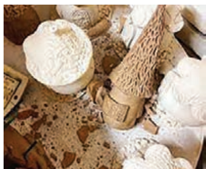
شکل ۵۳- قطعات شکسته شده در هنگام پخت
