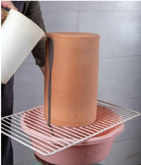
شکل ۱۹- ریختن روی سطح بیرونی قطعه قرار گرفته روی سطح ثابت یا پایه گردان
