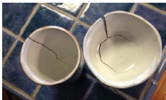
شکل ۵- ایجاد ترک بعد از لعاب
