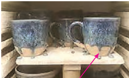
شکل ۷- شره کردن لعاب و صدمه به طبقات کوره
