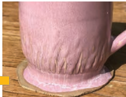
شکل ۸- جدا شدن پایه از کف قطعه
