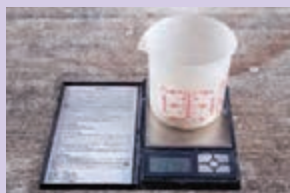
سنجش وزن ۱۰۰ cc دوغاب مراحل توزین با ترازوی دیجیتال
