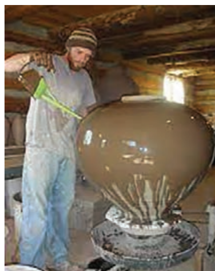
شکل ۲۴- نحوه قرارگیری قطعات بزرگ روی پایه گردان و ریختن لعاب
