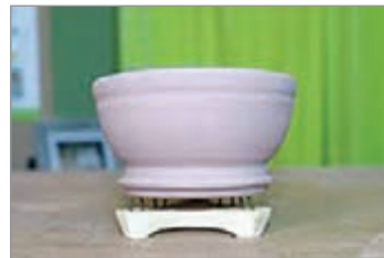
شکل ۱۳- قرار گرفتن قطعه لعابدار روی سه پایه شکل ۱۴- اثر سه پایه روی قطعه لعابدار
