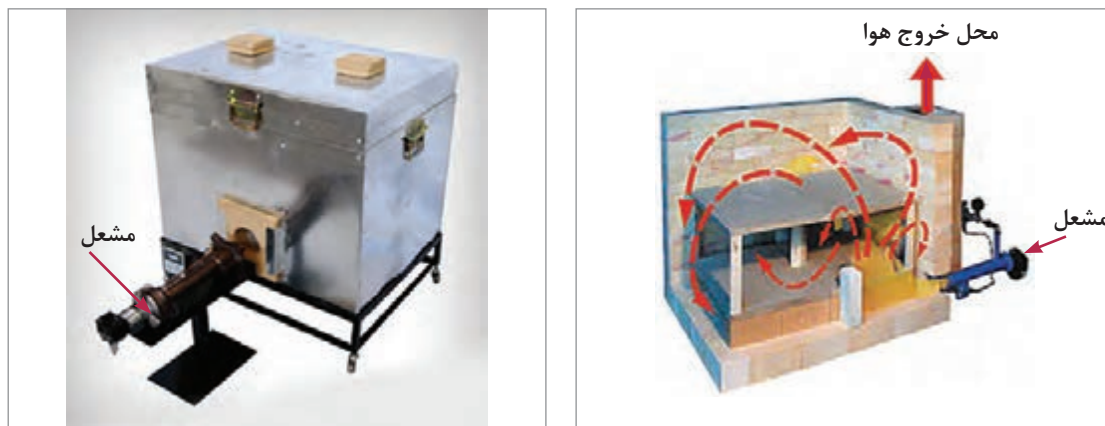
شکل ۱۶- ساختار کوره گازسوز مشعلی و محل خروج هوا
