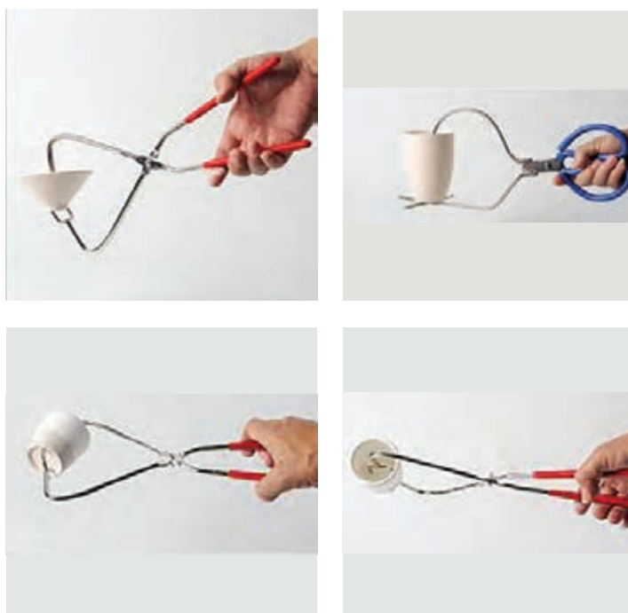
شکل ۲۶- انبر و روش‌های گرفتن قطعه با آن
