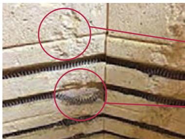
شکل ۳۵- آسیب دیدن دیواره کوره و المنت‌ها به دلیل چسبیدن قطعات به دیواره
