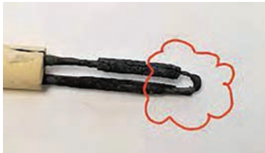
شکل ۲۰- ترموکوپل اکسید شده
