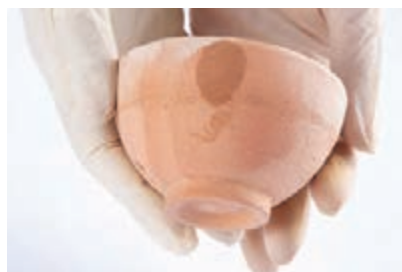
شکل ۱۰- اثر چربی روی قطعه سرامیکی
