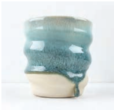
شکل ۱۶- شره کردن بخشی از لعاب ناشی از چگالی زیاد دوغاب
