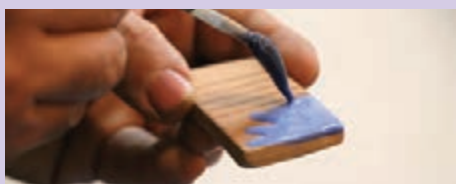
پوشش سطح قطعه با لعب به وسیله قلم مو
