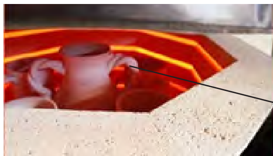
شکل ۴۱- رعایت فاصله قطعه از المنت
