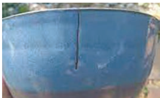
شکل ۴- اثر ترک‌های سطحی بعد از لعاب
