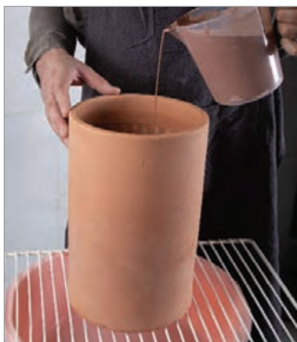
شکل ۱۶- ریختن لعاب داخل قطعه قرار گرفته روی سطح ثابت یا پایه گردان
