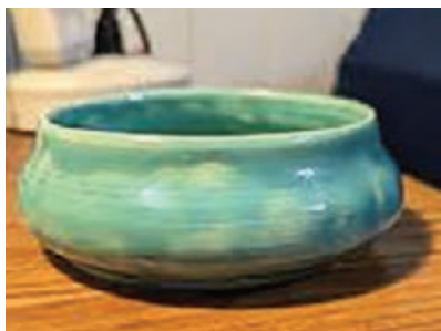
شکل ۱۵- تشکیل لعاب با ضخامت نازک ناشی از چگالی کم دوغاب
