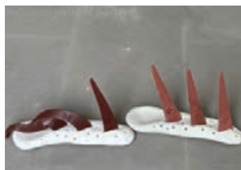
شکل ۲۷- مخروط‌های حرارتی پس از پخت در کوره لعاب
