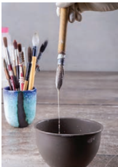
شکل ۳۱- خط ممتد ریزش لعاب
