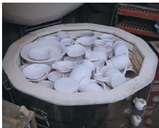
شکل ۴۰- پر کردن بیش از اندازه کوره
