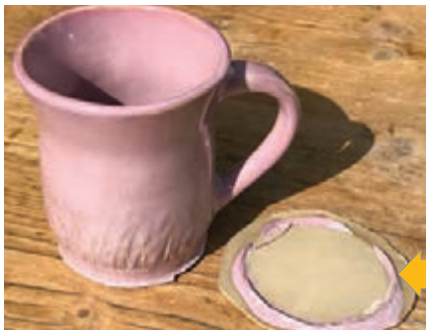
شکل ۸- جدا شدن پایه از کف قطعه
