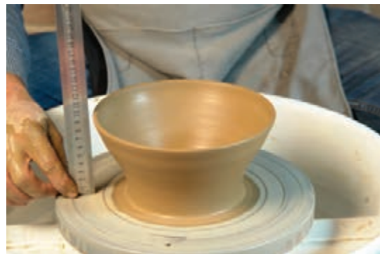
شکل ۱۶- اندازه‌گیری ارتفاع کاسه با خط‌کش
