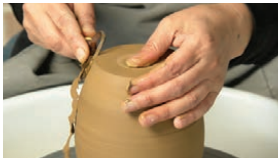
شکل ۳۷- تراش سطح بیرونی ظرف شکم‌دار در قسمت کف
