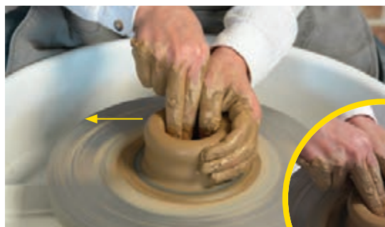
شکل ۲۹- صاف کردن کف ظرف با دو انگشت
