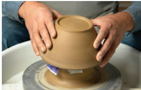
شکل ۴۷- برداشتن کاسه از روی پایه گلی
