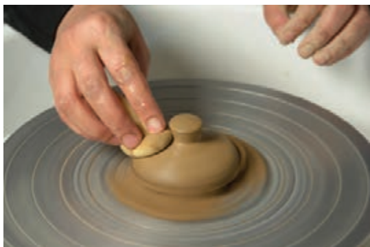
شکل ۶۴- پرداخت در با اسفنج
