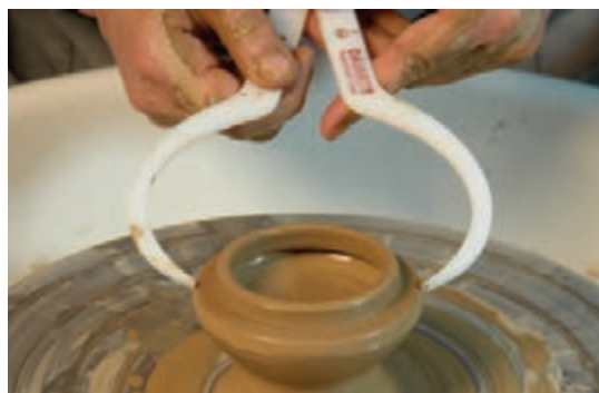
شکل ۵۱- اندازه‌گیری قسمت خارجی در
