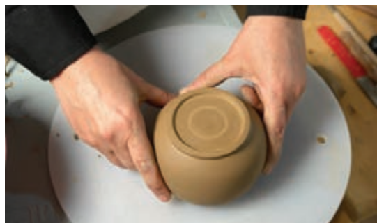
شکل ۳۶- قرار دادن ظرف روی صفحه زیر کار
