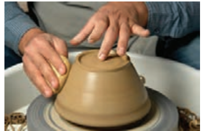
شکل ۴۴- پرداخت دیواره کاسه با اسفنج مرطوب
