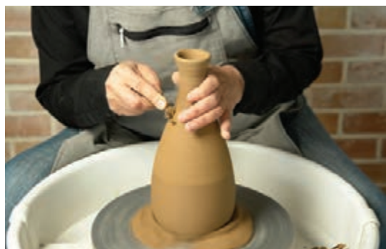
شکل ۳۹- تراش دیواره و گردن ظرف با ابزار
