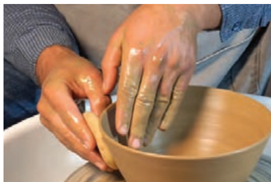
شکل ۲۲- پرداخت جداره خارجی کاسه با اسفنج
