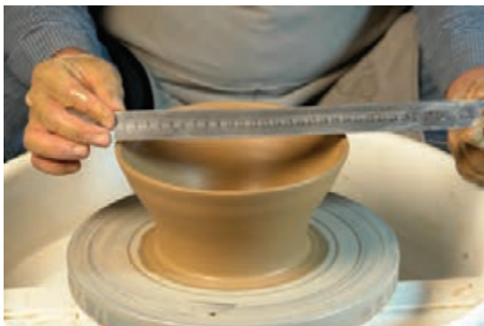
شکل ۱۷- اندازه‌گیری دهانه کاسه با خط‌کش
