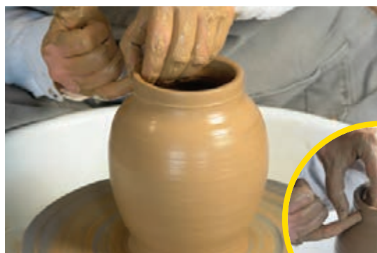
شکل ۱۷- مشخص کردن مرز میان گردن و شکم با استفاده از انگشتان
