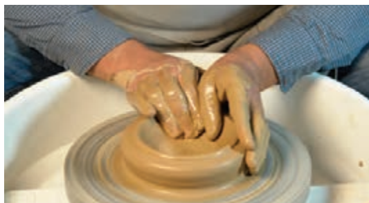
شکل ۶- شکل دادن به توده گل باز شده
