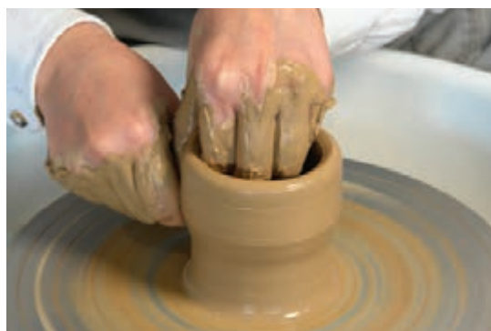
شکل ۳۴- کم کردن ضخامت دیواره با قلاژ کشیدن
