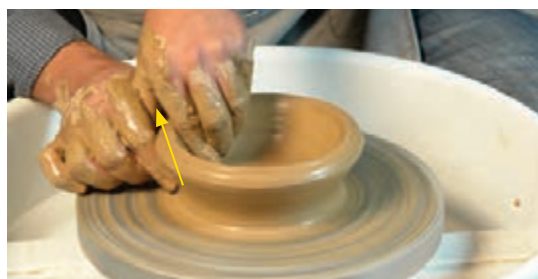
شکل ۸- بالا کشیدن و نازک کردن دیواره
