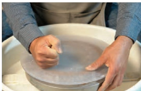
شکل ۶۰ - ایجاد ضربه و اطمینان از اتصال صفحه جدا شونده
