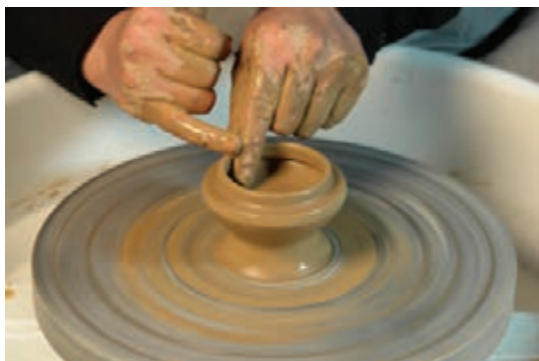
شکل ۴۸- صاف کردن لبه نگه دارنده
