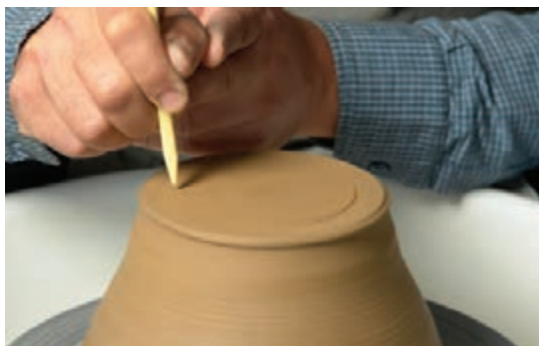
شکل ۳۴- ایجاد خط روی کف کاسه برای تشخیص مرکز بودن آن
