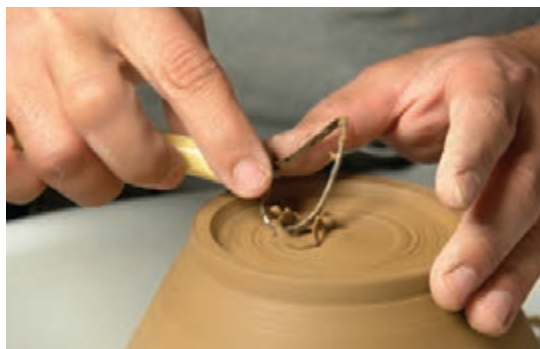
شکل ۴۱- تراش کف کاسه از مرکز به بیرون
