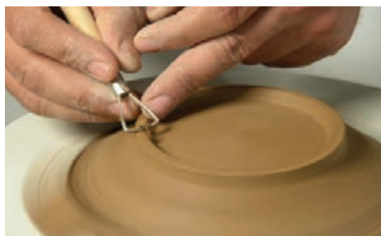
شکل ۹۴ - صاف کردن سطح رکاب با ابزار
