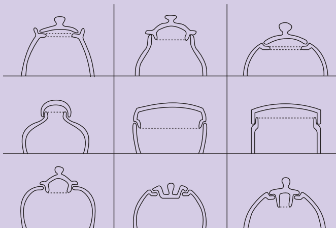
نمونه‌هایی از ظرف با لبه نگه‌دارنده و درهای مختلف
