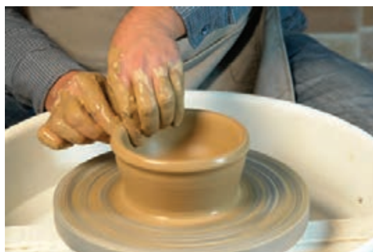
شکل ۱۱- نازک کردن دیواره تا حدود یک سانتی‌متر
