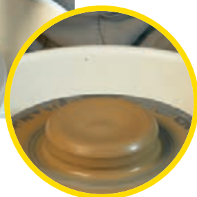
شکل ۴- گل پهن شده روی صفحه چرخ
