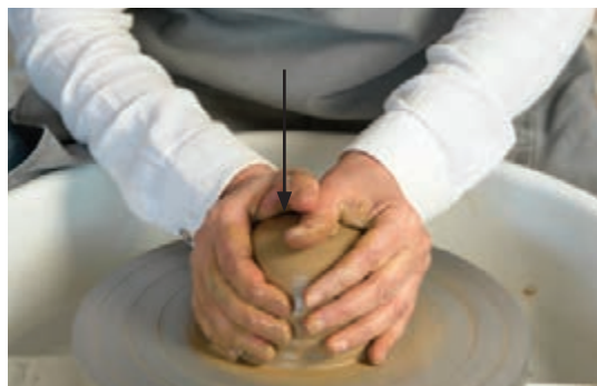
شکل ۷- فشار گل به سمت پایین
