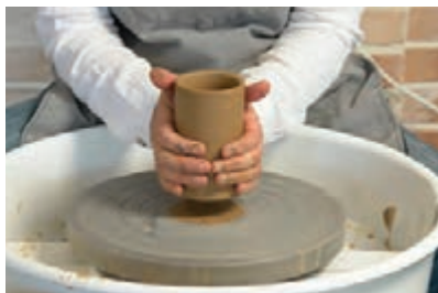
شکل ۴۸- بلند کردن استوانه از روی صفحه با دو دست
