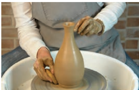
شکل ۳۱- از بین بردن رد ابزار با اسفنج
