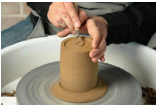
شکل ۶۳- تراش کف از قسمت مرکز به سمت بیرون
