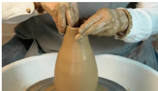
شکل ۲۲- جمع کردن دهانه با استفاده از سه انگشت
