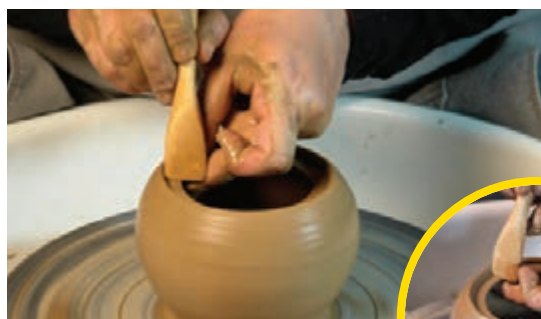
شکل ۱۵- گونیا کردن لبه نگه دارنده
