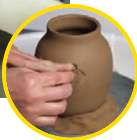
شکل ۳۱- تراش بدنه ظرف شکم‌دار
