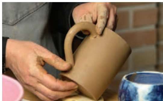
شکل ۷۹- اطمینان از محل اتصال دسته
