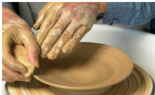
شکل ۷۲ - از بین بردن ناصافی‌ها در قسمت لبه با استفاده از اسفنج
