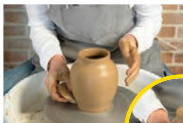
شکل ۲۱- پرداخت دیواره ظرف با اسفنج
