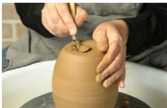
شکل ۳۸- تراش کف ظرف به صورت لایه‌لایه از مرکز به سمت بیرون
