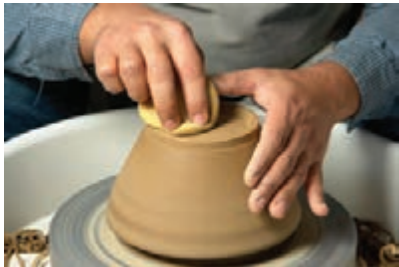
شکل ۴۶- پرداخت کف کاسه با اسفنج مرطوب
