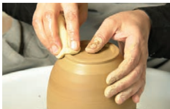
شکل ۴۳- پرداخت کف با اسفنج
