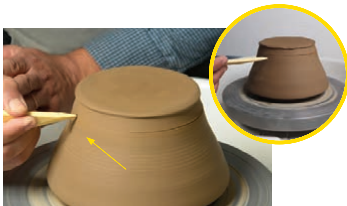
شکل ۳۳- ایجاد خط روی دیواره کاسه برای تشخیص مرکز بودن آن
