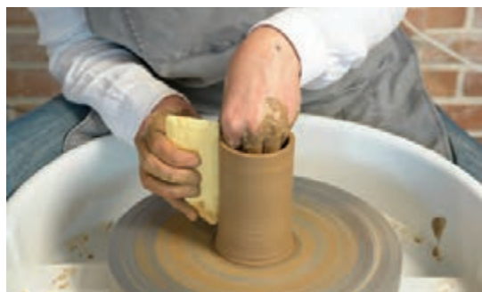
شکل ۴۲- صاف کردن دیواره با لیسه پلاستیکی
