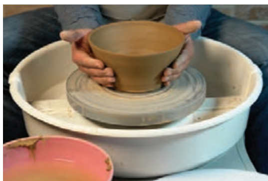
شکل ۲۵- بلند کردن کاسه از روی صفحه چرخ
