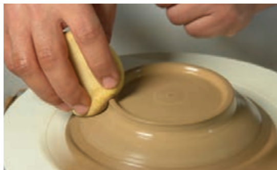
شکل ۹۶- پرداخت کف بشقاب با اسفنج
