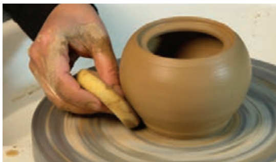
شکل ۲۱- از بین بردن رد ابزار با اسفنج
