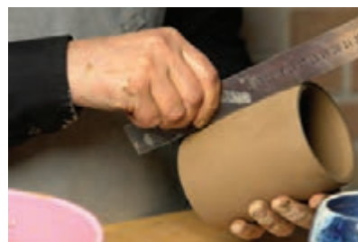
شکل ۷۵- مشخص کردن محل دسته با خط کش
