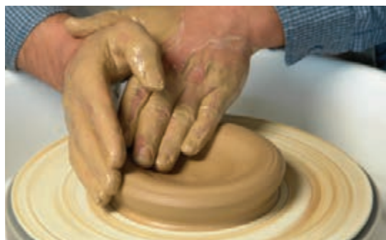
شکل ۶۶- باز کردن گل در سطح افقی
