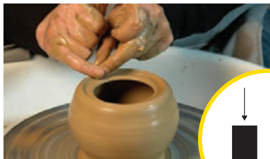
شکل ۱۴- صاف کردن لبه ایجاد شده
