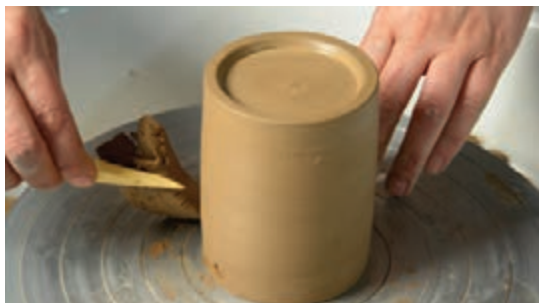
شکل ۶۷- برداشتن فتیله گلی از روی صفحه چرخ سفالگری
