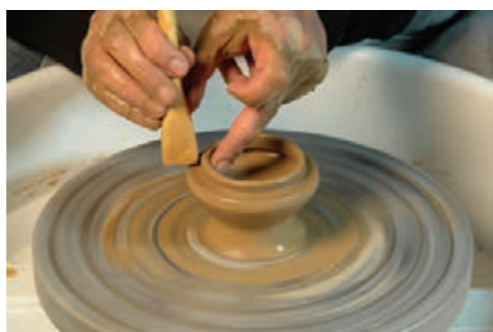
شکل ۵۳- گونیا کردن لبه
