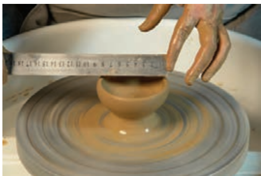
شکل ۴۳- اندازه‌گیری قطر دهانه
