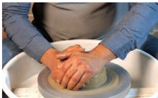
شکل ۶۳- پهن کردن چانه گل روی صفحه چرخ
