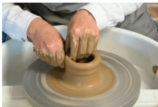
شکل ۳۲- قلاژ کشیدن دیواره به سمت بالا
