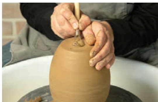
شکل ۳۸- تراش کف ظرف به صورت لایه‌لایه از مرکز به سمت بیرون
