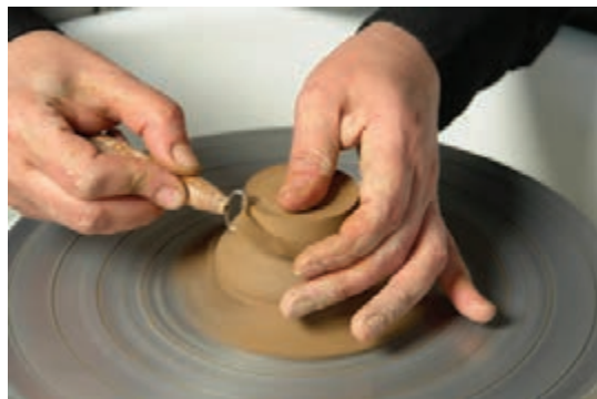
شکل ۶۱- برداشتن گل اضافی قسمت دستگیره با تراش
