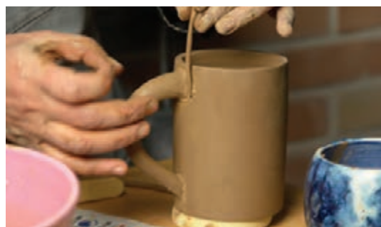
شکل ۸۰- قرار دادن فتیله در محل اتصال دسته
