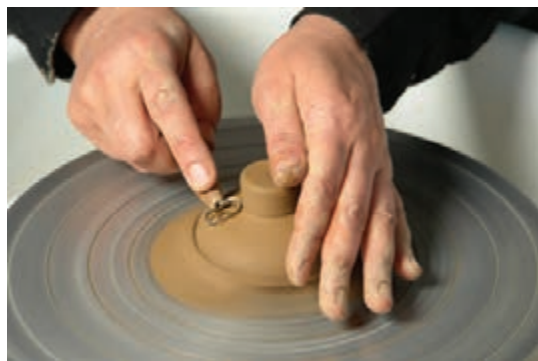
شکل ۶۳- شکل دادن به دستگیره در
