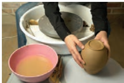
شکل ۴۶- قرار دادن ظرف شکم‌دار از قسمت لبه روی صفحه زیر کار
