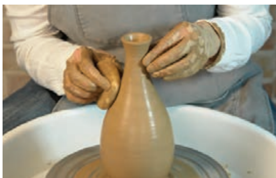
شکل ۲۹- پرداخت بدنه با اسفنج
