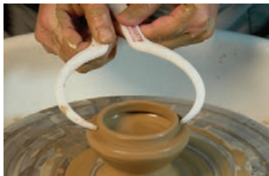
شکل ۴۹- اندازه‌گیری قسمت بیرونی در
