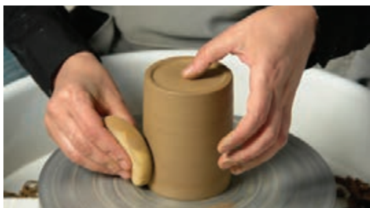
شکل ۶۸- پرداخت لبه لیوان با اسفنج مرطوب
