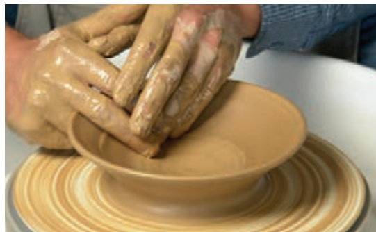
شکل ۷۰ - قلاژ کشیدن با استفاده از پره میان انگشتان
