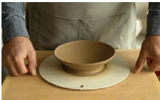
شکل ۷۸ - جدا کردن بشقاب با استفاده از سیم برش
