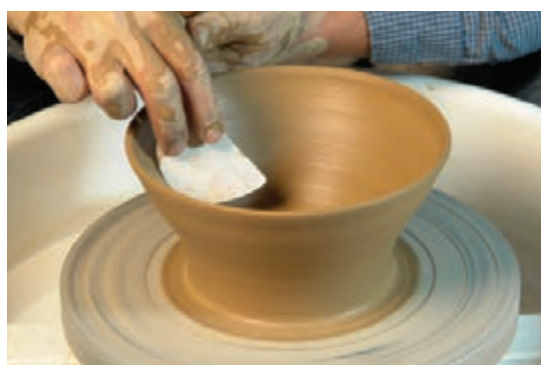
شکل ۱۹- فرم دهی دیواره داخلی کاسه با لیسه پلاستیکی
