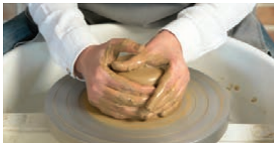
شکل ۲- مرکز کردن چانه گل
