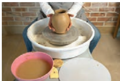
شکل ۲۴- بلند کردن ظرف شکم‌دار از روی صفحه
