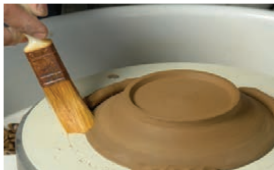
شکل ۹۵- برداشتن تراشه‌های گل با قلم‌مو
