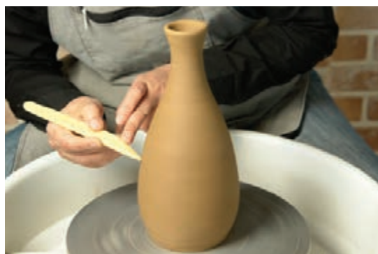
شکل ۳۸- ایجاد خط روی بدنه برای اطمینان از مرکز بودن آن
