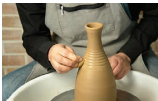
شکل ۴۳- پرداخت خطوط ایجاد شده با استفاده از اسفنج
