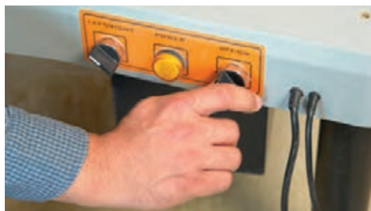
شکل ۱۲- کلید روشن و خاموش در راست و کلید تغییر جهت چرخش در چپ
