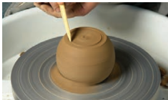
شکل ۲۹- مشخص کردن محل تراش پایه
