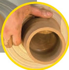
شکل ۳۱- محل قرارگیری انگشت شست
