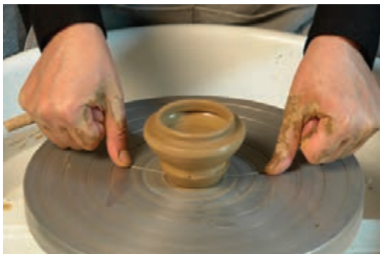
شکل ۵۶- جدا کردن در از روی صفحه چرخ
