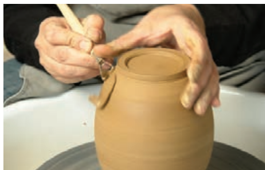
شکل ۴۰- تراش سطح بیرونی بدنه با ابزار
