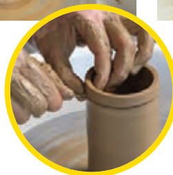
شکل ۳۸- وارد کردن سوزن به دیواره
