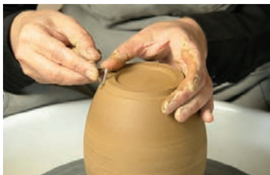
شکل ۳۹- تراش رکاب ظرف شکم‌دار با ابزار
