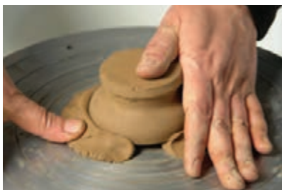
شکل ۶۰- قرار دادن فتیله گل در اطراف در
