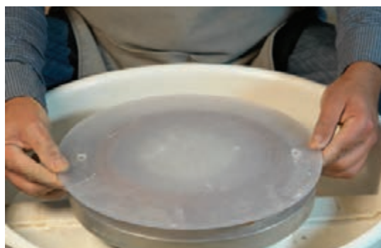
شکل ۵۹ - قراردادن صفحه جدا شونده روی فتیله گل
