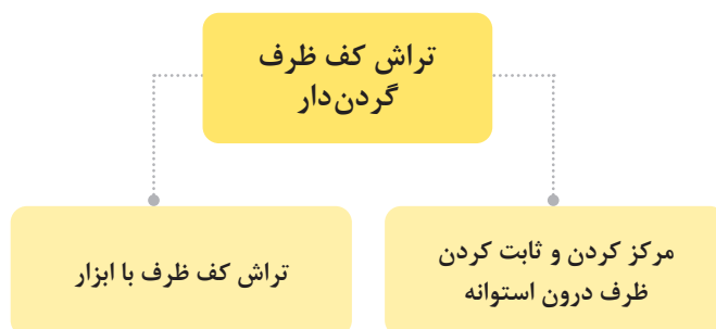
شکل ۵۴- نمودار مراحل تراش کف ظرف گردن دار
