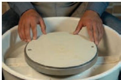
شکل ۵۳- قرارگیری صفحه جداشونده به صورت کامل روی صفحه چرخ
