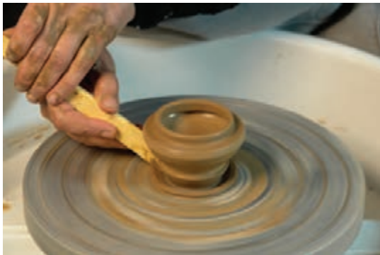
شکل ۵۴- برداشتن گل اضافی پایین در
