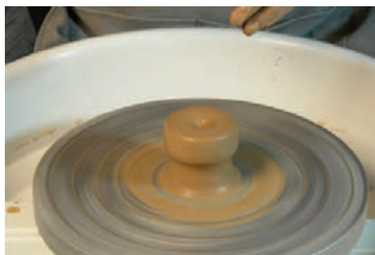
شکل ۴۰- توده گل مرکز شده روی چرخ
