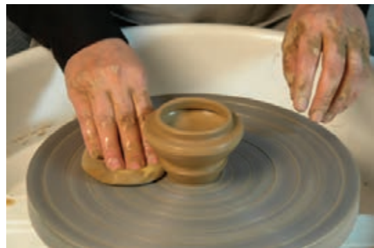
شکل ۵۵- تمیز کردن صفحه چرخ
