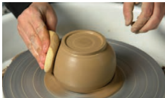
شکل ۳۵- پرداخت دیواره با اسفنج
