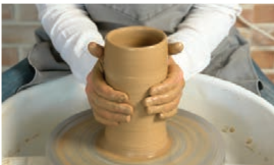
شکل ۵- کنترل استوانه میان دو دست
