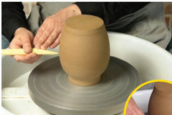
شکل ۳۳- ایجاد خط روی بدنه ظرف برای اطمینان از مرکز بودن آن
