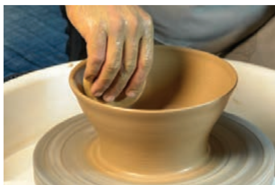
شکل ۲۰- از بین بردن رد به جا مانده از دست و لیسه با استفاده از اسفنج مرطوب
