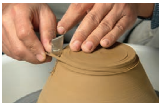
شکل ۳۸- تراش سطح بیرونی پایه برای ایجاد رکاب
