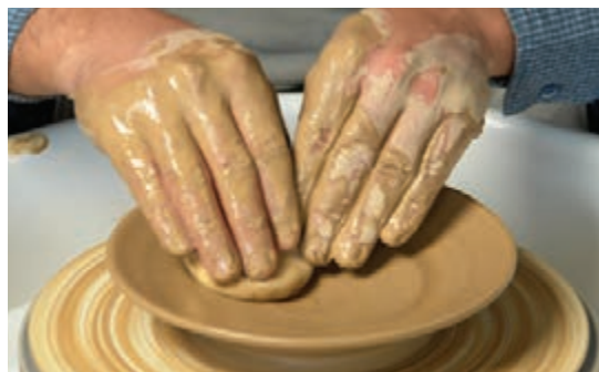
شکل ۷۳ - صاف کردن کف بشقاب با اسفنج
