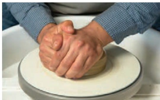
شکل ۶۲- مرکز کردن چانه گل
