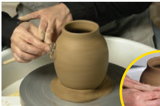
شکل ۳۱- تراش بدنه ظرف شکم‌دار
