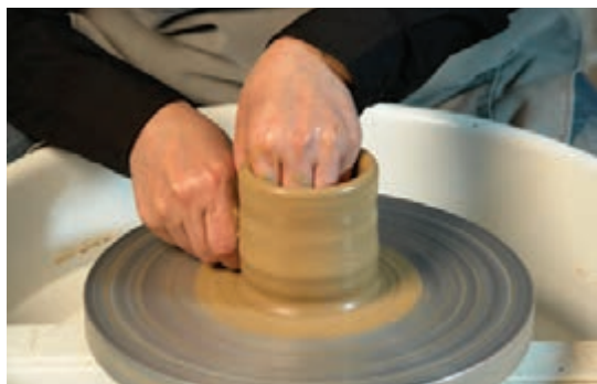
شکل ۴- قلاژ کشیدن دیواره
