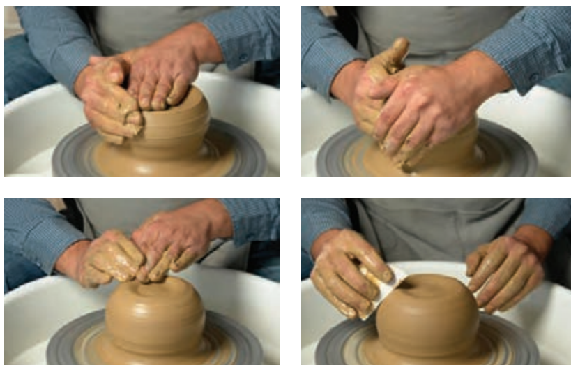
شکل ۲۹- ساخت پایه تو پر گلی
