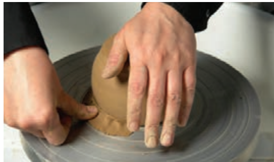
شکل ۲۷- ثابت کردن ظرف با فتیله
