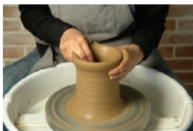
شکل ۵۰- قلاژ کشیدن دیواره
