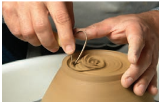
شکل ۴۰- تراش تدریجی کف کاسه با ابزار
