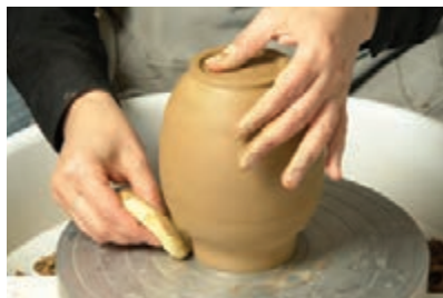
شکل ۴۵- از بین بردن رد فتیله گلی با استفاده از اسفنج
