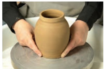
شکل ۲۸- قرار دادن ظرف شکم‌دار در مرکز صفحه چرخ
