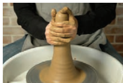
شکل ۴۶- فشار به گل و حرکت آن به سمت بالا
