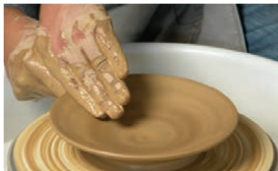
شکل ۷۱ - حالت دادن به لبه بشقاب
