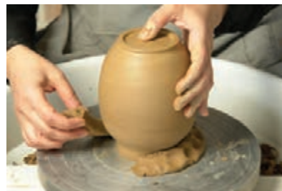
شکل ۴۴- برداشتن فتیله گل از اطراف ظرف
