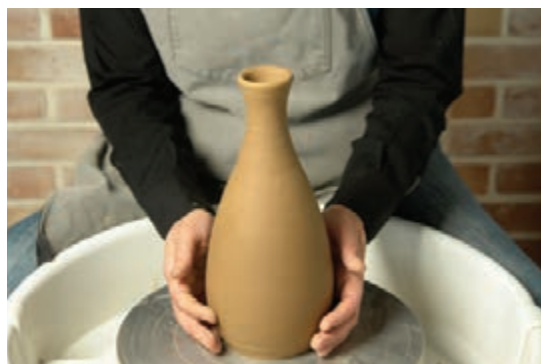
شکل ۳۶- قرار دادن ظرف در مرکز صفحه
