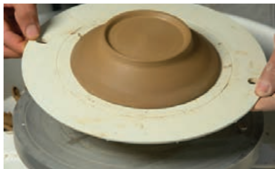
شکل ۹۸- برداشتن صفحه جدا شوند از روی صفحه چرخ
