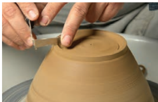
شکل ۴۳- تراش قسمت لبه پایه کاسه
