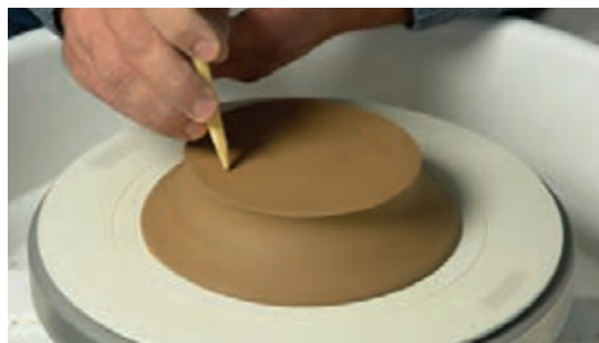
شکل ۸۳ - ایجاد خط در قسمت کف برای اطمینان از مرکز بودن بشقاب
