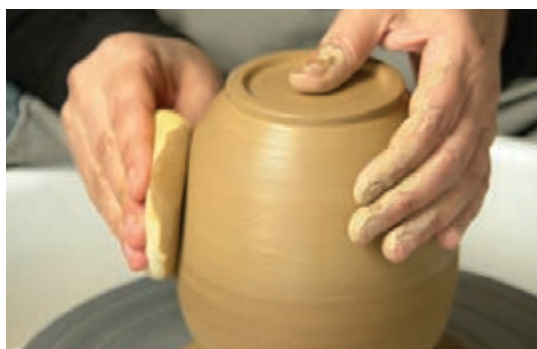
شکل ۴۲- پرداخت دیواره با اسفنج
