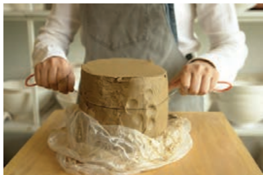
شکل ۸- جدا کردن توده گل با سیم برش
