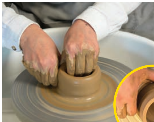
شکل ۳۰- شروع قلاژ کشیدن دیواره
