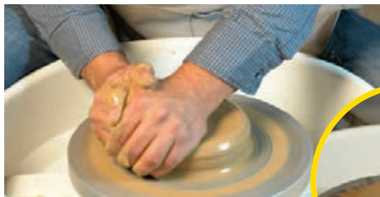
شکل ۳- پهن کردن گل روی صفحه چرخ
