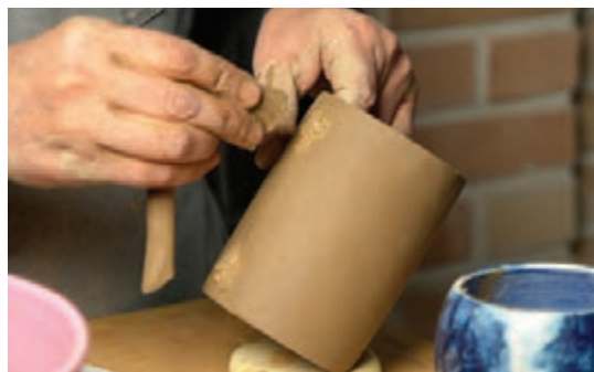
شکل ۷۸- اتصال دسته به بدنه
