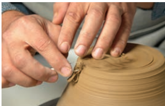
شکل ۳۶- تراش گل اضافی قسمت کف
