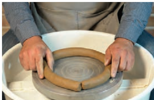
شکل ۵۵- قرار دادن فتیله گل روی صفحه چرخ
