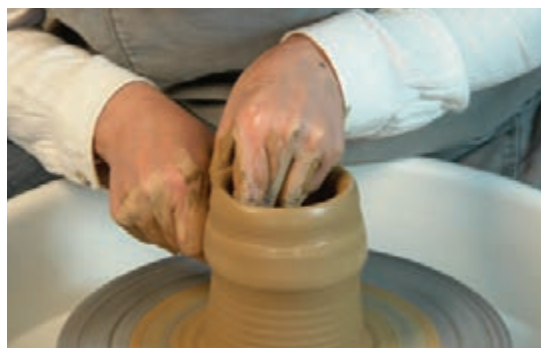
شکل ۱۰- قلاژ کشیدن دیواره با مقدار گل بیشتر
