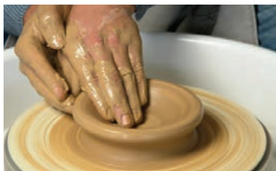
شکل ۶۷- قلاژ کشیدن دیواره به سمت خارج و بالا
