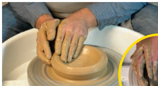
شکل ۷- شکل دادن به جداره داخلی کاسه
