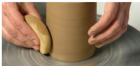
شکل ۴۳- پرداخت دیواره و از بین بردن رد ابزار با اسفنج
