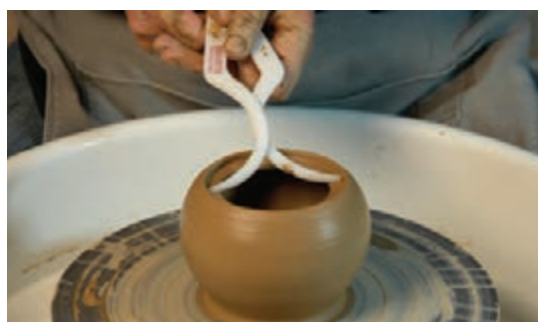
شکل ۱۸- اندازه گیری قسمت پله ایجاد شده
