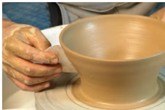
شکل ۱۸- فرم دهی به دیواره بیرونی کاسه با لیسه پلاستیکی
