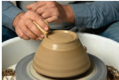
شکل ۴۵- پرداخت رکاب کاسه با اسفنج مرطوب
