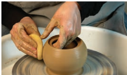
شکل ۲۲- پرداخت دیواره ظرف با اسفنج
