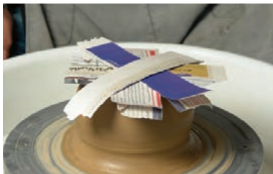
شکل ۳۰- قرار دادن روزنامه بر روی پایه گلی توپر
