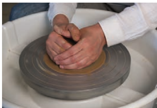
شکل ۱۹- فشار چانه گل به صفحه چرخ سفالگری
