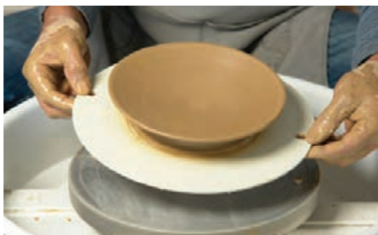
شکل ۷۷ - جدا کردن صفحه جدا شونده از روی صفحه چرخ
