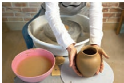
شکل ۲۵- قرار دادن ظرف شکم‌دار روی صفحه زیر کار
