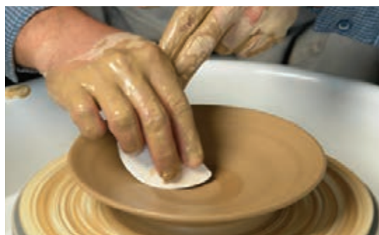
شکل ۷۴ - صاف کردن کف بشقاب با لیسه پلاستیکی
