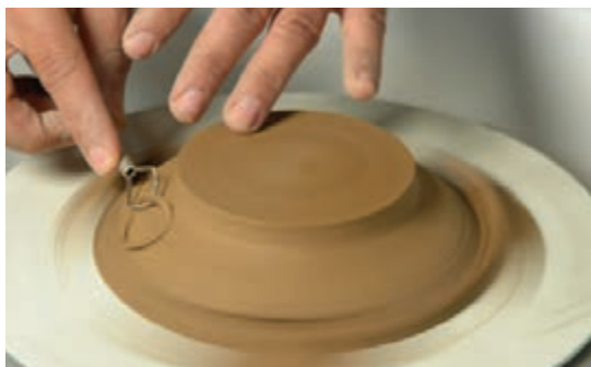
شکل ۹۲- تراش بشقاب با ابزار
