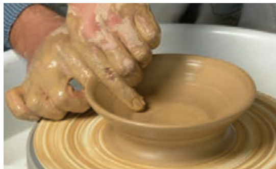
شکل ۶۸ - قلاژ کشیدن دیواره از کف بشقاب
