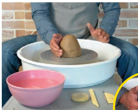
شکل ۱۷- اتصال چانه گل به صفحه چرخ سفالگری
