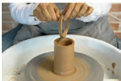
شکل ۳۹- بلند کردن گل اضافی از قسمت لبه
