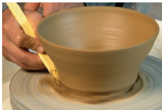
شکل ۲۱- برداشتن گل اضافی قسمت پایین کاسه با ابزار
