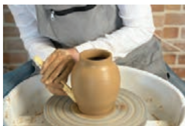
شکل ۲۰- برداشتن گل اضافی پایین ظرف
