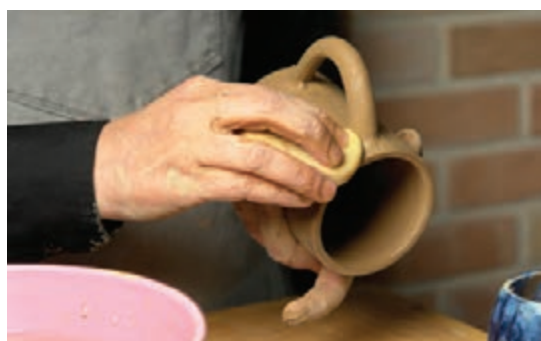
شکل ۸۲- پرداخت محل اتصال با اسفنج مرطوب
