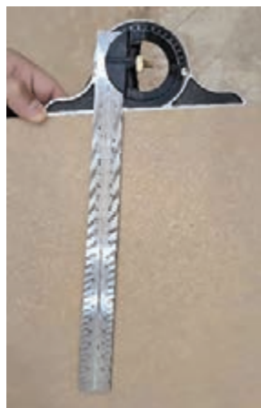
شکل ۳- استخراج زاویه پایه‌ها از روی نقشه و ترسیم زاویه پایه جهت ساخت الگو
