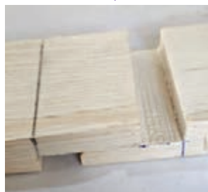
شکل ۱۵- مراحل کار با اره پشت دار برای ساخت اتصال نیم و نیم طولی
