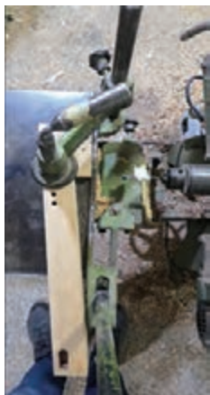
شکل ۲۲- سوراخ کاری محل اتصال دوبل
