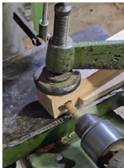
شکل ۱۶- اجرای کام با دستگاه کام‌کن
