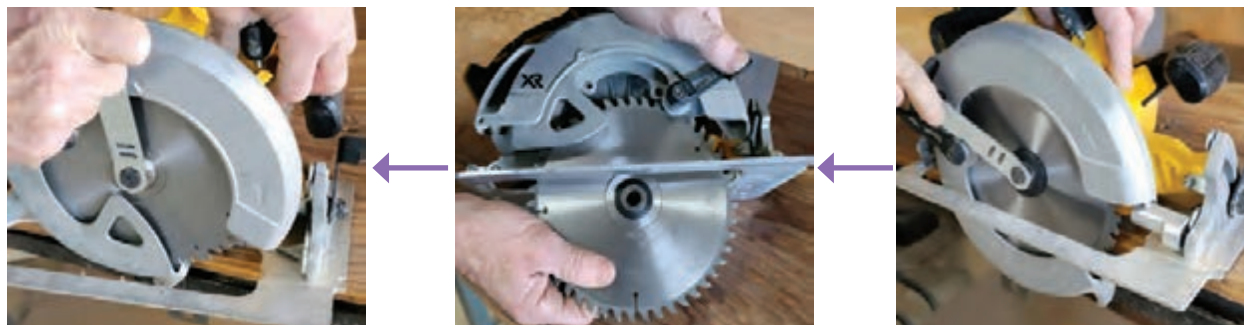
شکل ۳۸- مراحل نصب تیغه اره گرد متحرک
