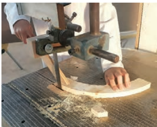
شکل ۶۴- برش قوس بیرونی و استفاده از کارگیر
