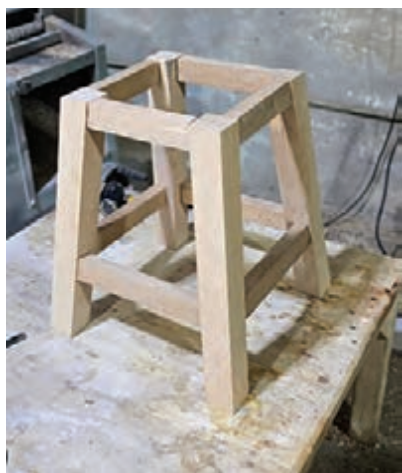
شکل ۲۵- سر هم کردن چهارپایه
