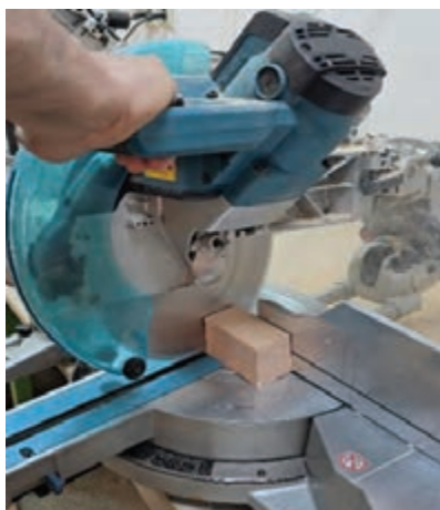
شکل ۹- برش عرضی قطعات با فارسی‌بر
