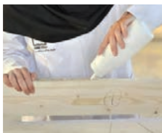
شکل ۲۳- خراشیدن و چسب زدن نر تخته‌های صفحه
