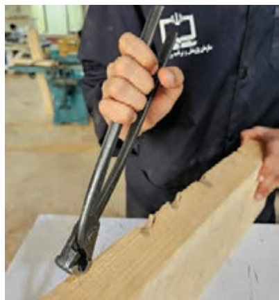
شکل ۴- خارج کردن میخ از الوار
