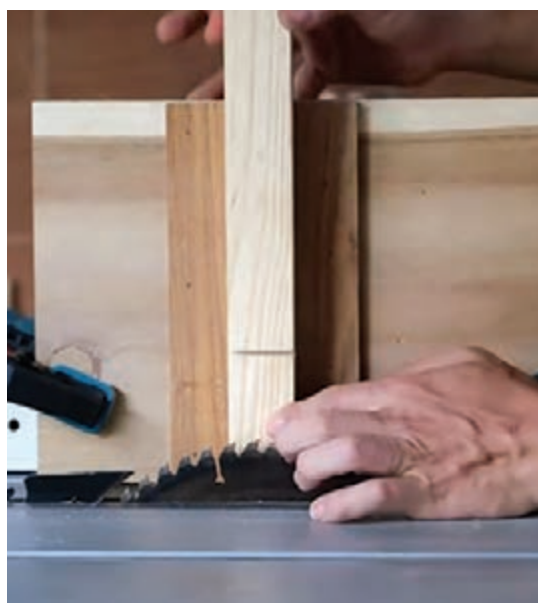
شکل ۲۰- مراحل برش طول زبانه‌ها تنظیم ارتفاع اره جهت برش طولی زبانه‌ها
