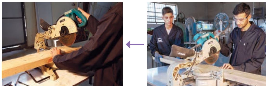
شکل ۷- برش عرضی قطعات با اَره فارسی بر
