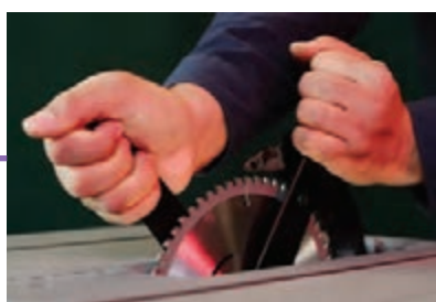
شکل ۳۷- مراحل نصب تیغه اره گرد میزی (ثابت)
