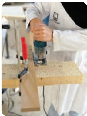
شکل ۴۶- برش با اره چکشی بدون ریل و با ریل راهنما (چوب بررسی)
