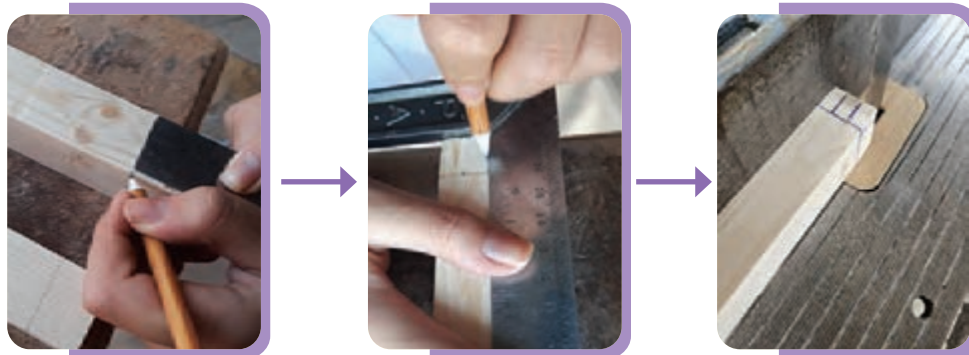
شکل ۱۳- رسم خطوط برش زبانه
