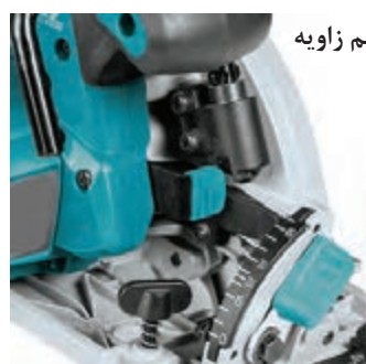
شکل ۴۰- تنظیم عمق و زاویه برش
