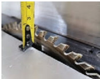
شکل ۱۰- تنظیم ارتفاع تیغه اره (ارتفاع برش)
