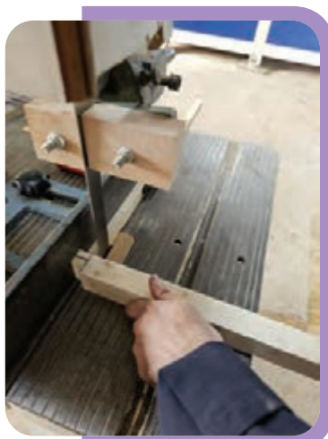
شکل ۱۵- بستن قالب برای برش عرضی
