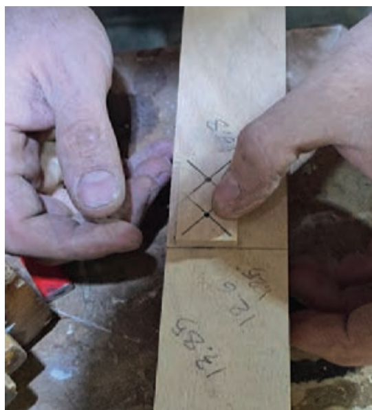
شکل ۱۲- تعیین محل اتصال دوبل به وسیله الگو
