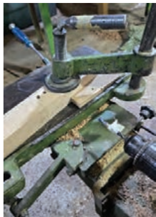
شکل ۲۲- سوراخ کاری محل اتصال دوبل
