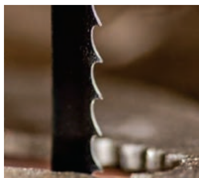
شکل ۲۰- جهت قرارگیری دندان‌های تیغه آره فلکه
