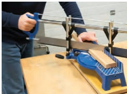
شکل ۱۷- برش فارسی با اره فارسی بر دستی
