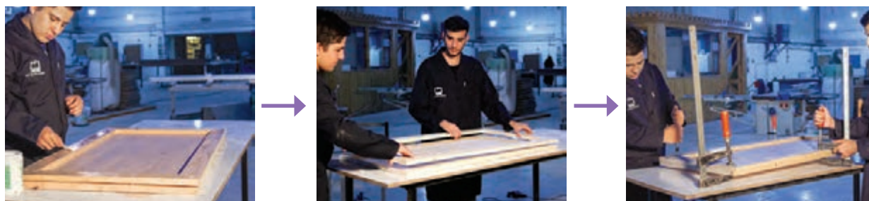
شکل ۲۵- نصب قاب پشتیبان به صفحه
