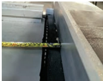
شکل ۹- فاصله قسمت داخلی تیغه اره تا گونیای دستگاه (عرض برش)
