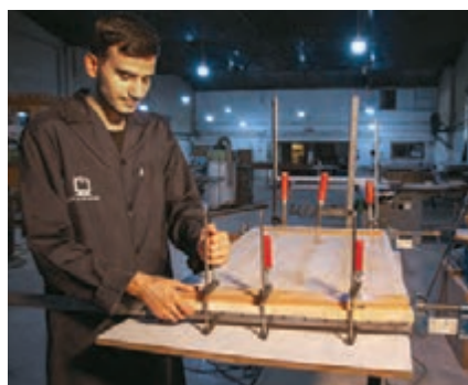
شکل ۲۴- بستن صفحه و مهار کردن آن
