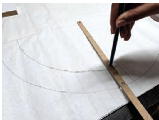
شکل ۴۳- رسم قطر قاب به وسیله پرگار
