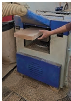
شکل ۷- شیوه ایستادن پشت دستگاه گندگی
