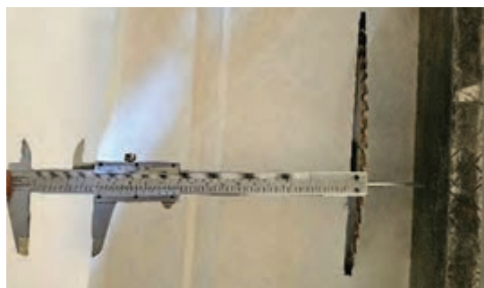
شکل ۴۲- اندازه‌گیری عرض برش (فاصله بین گونیا تا پشت تیغه) با کولیس
