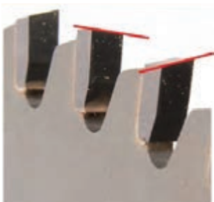
شکل ۳۴- تیغه با دندان‌های نوع ATB
