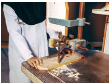
شکل ۲۹- برش خطوط عمودی بر خط منحنی
