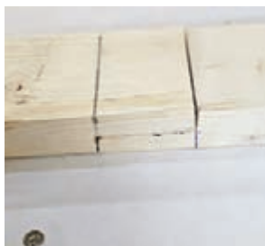
شکل ۱۵- مراحل کار با اره پشت دار برای ساخت اتصال نیم و نیم طولی
