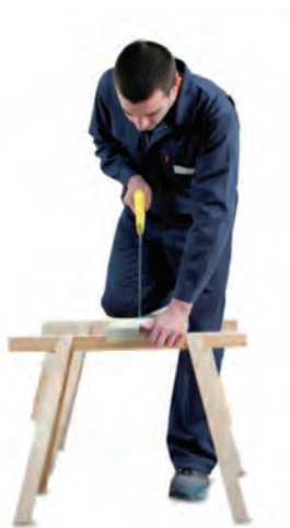
شکل ۱۲- برش طولی بر روی میز و خرک
