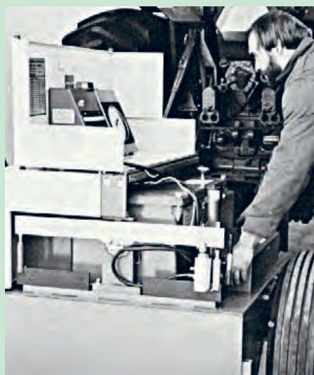
شکل ۳۶- اندازه‌گیری توان یک تراکتور با دینامومتر
