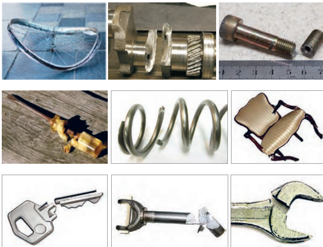
شکل ۱-۴- خرابی و شکستگی در قطعات و سازه‌ها
