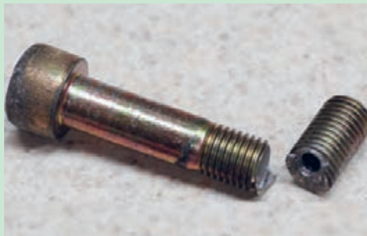
شکل ۴-۳۵- یک پیچ بریده شده بر اثر بارگذاری پیچشی
