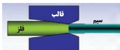
شکل ۵-۲۵- تولید سیم به روش کشش
