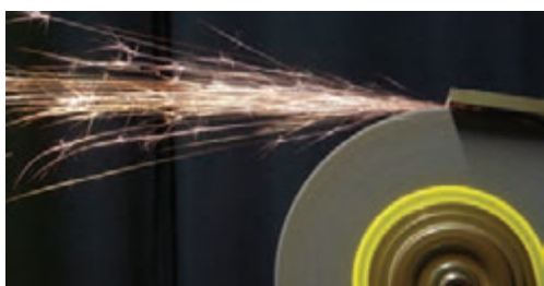
شکل ۴۸-۵- جرقه‌های حاصل از سنگ زدن فلزات
