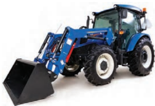
شکل ۶۲- اتصال ثابت بیل به تراکتور
