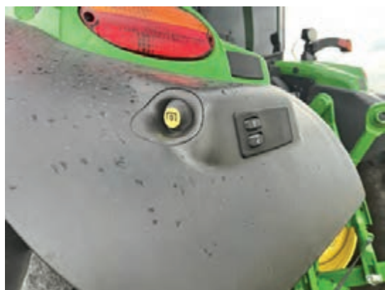
شکل ۵۰- کنترل کننده های بازوهای هیدرولیک نصب شده روی گلگیر عقب
