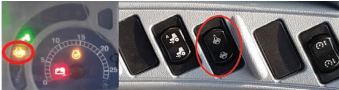
شکل ۳۵- فعال کردن قفل دیفرانسیل دستی و اتوماتیک در تراکتور نیوهلند T6090
