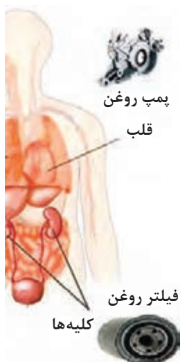
شکل ۴۴- تشابه سیستم روغن‌کاری موتور با سیستم گردش خون
