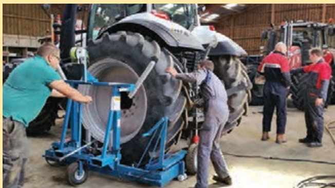
شکل ۷۱- جابه‌جایی چرخ عقب با ابزار مخصوص
