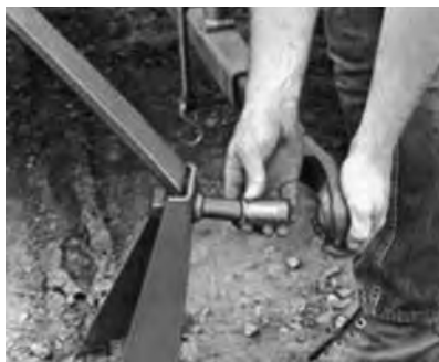
شکل ۳۴- استفاده از بوش برای اتصال ماشین به تراکتور گروه بالاتر
