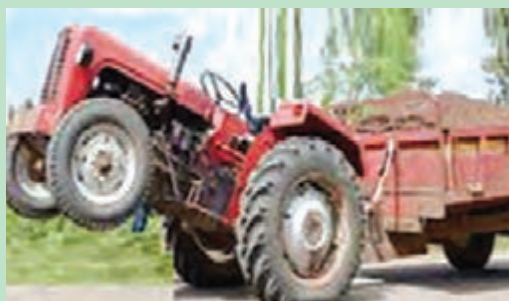
شکل ۵۹- تأثیر وزن روی چرخ‌های تراکتور در تعادل (بالانس) آن
