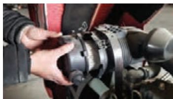
۲ بست یا مهره نگهدارنده درپوش صافی را باز کرده و درپوش را بردارید.
