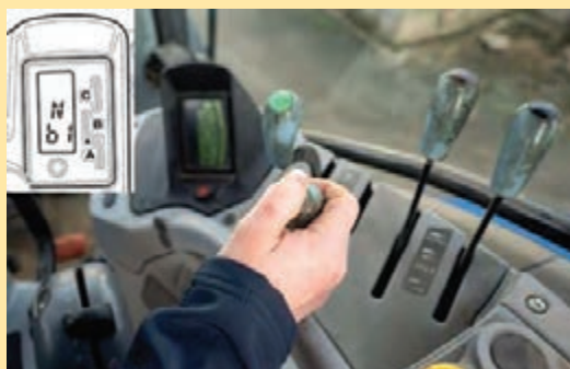
شکل ۱۹- نمایشگر جعبه دنده بعد از روشن کردن تراکتور
