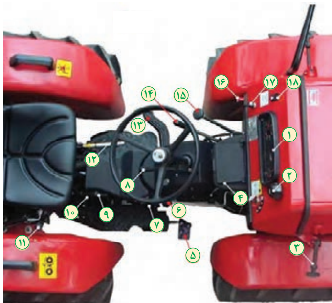
شکل ۲۰- موقعیت اهرم های کنترل و تجهیزات تراکتور ITM950
