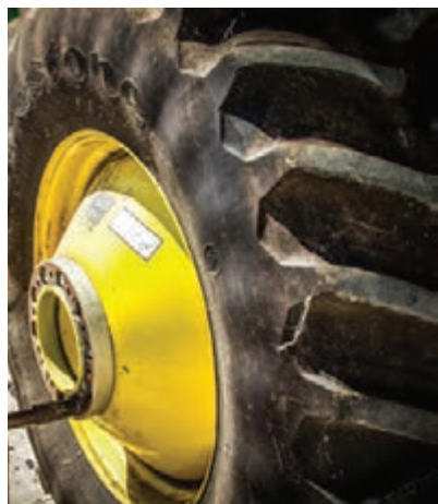
شکل ۴۶- توپی چرخ در کمترین فاصله ممکن
