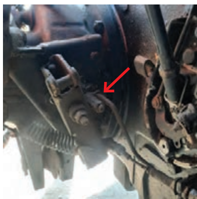
شکل ۲۷- پیچ هواگیری و محل قرارگیری آن بر روی تراکتور
