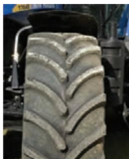
شکل ۱۵- لاستیک‌سایی در اثر تنظیم نبودن زاویه سرجمی
