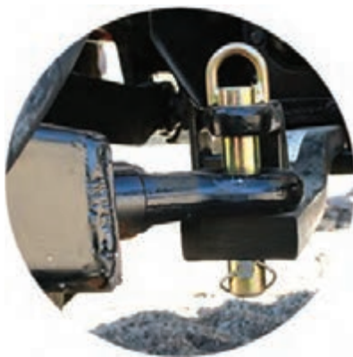
شکل ۶۰- اتصال مال بند تراکتور به ماشین با استفاده از پین استاندارد
