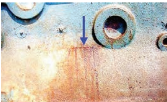
شکل ۳۴- ترکیدن بلوک سیلندر در اثر سرما
