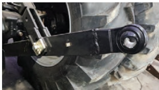
شکل ۳۹- بازوها در حالت ثابت نسبت به هم قرار دارند. با خارج کردن پین‌ها و چرخاندن ۹۰ درجه‌ای صفحه مستطیل شکل می‌توان بازوهای تحتانی را نسبت به بازوی رابط در حالت نوسانی قرار داد.
