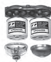
۴ مجموعه صافی را باز کرده و قسمت تحتانی کاسه صافی را تمیز کنید. ۵ واشرهای حلقوی را بازدید کنید و در صورت نیاز تعویض نمایید. ۶ برای بستن فیلتر، عکس مراحل قبل عمل کنید.
