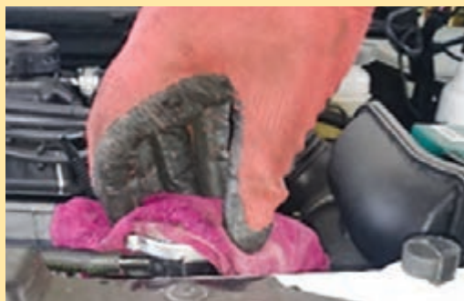
شکل ۲۷- باز کردن درب رادیاتور
