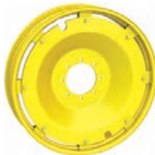
شکل ۴۷- اتصال دیسک به رینگ با پیچ و مهره
