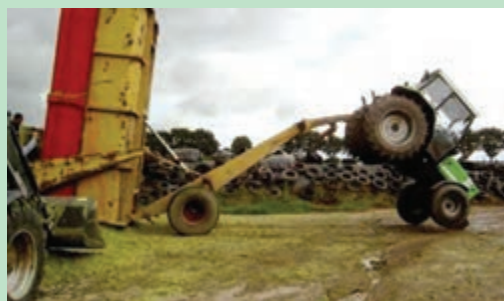
شکل ۵۹- تأثیر وزن روی چرخ‌های تراکتور در تعادل (بالانس) آن
