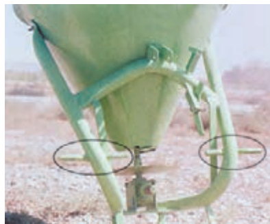
شکل ۳۳- پذیرش قابل اتصال به دو گروه از تراکتورها
