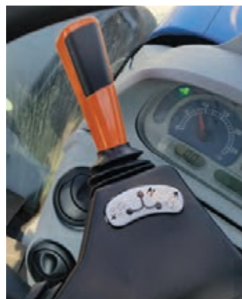
شکل ۳۱- اهرم تعیین وضعیت حرکت تراکتور نیوهلند T6090
