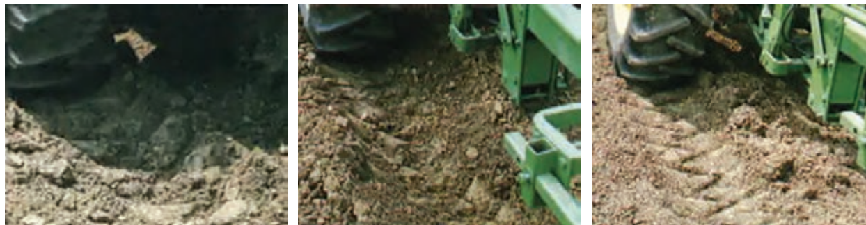
شکل ۵۵- تأثیرات وزن چرخ عقب روی رد لاستیک
