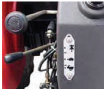
الف) محورهای توان‌دهی تراکتور باغی ب) اهرم انتخاب حالت‌های خلاص و درگیر ج) اهرم انتخاب حالت‌های چرخ‌گرد، موتور‌گرد و خلاص
