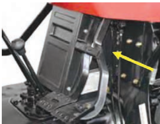
شکل ۲۶- جفت‌کن پدال‌های ترمز تراکتور ITM475
