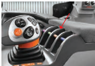
شکل ۷۲- خروجی های هیدرولیک تراکتور کلاس AXION960 و اهرم های کنترل آن
