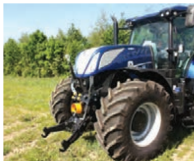
شکل ۳۵- اتصال سه نقطه جلو در وضعیت اتصال
