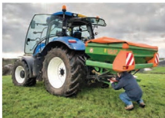
شکل ۵۳- هیچ گاه برای انجام تعمیرات و تنظیمات زیر ماشین متصل به تراکتور قرار نگیرید.
