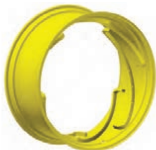
شکل ۴۸- اتصال دیسک به رینگ به صورت ریلی
