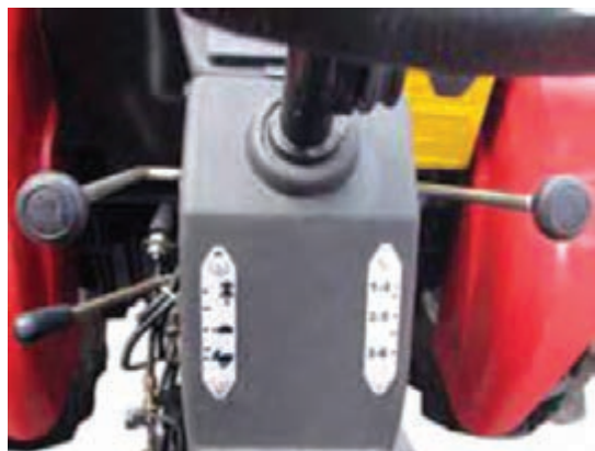
شکل ۳۰- وضعیت درگیری اهرم‌های تعویض دنده تراکتور ITM950
