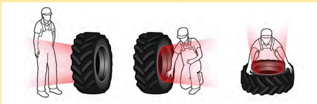
شکل ۷۲- مناطق پرخطر اطراف چرخ هنگام تنظیم باد یا خارج کردن تایر
