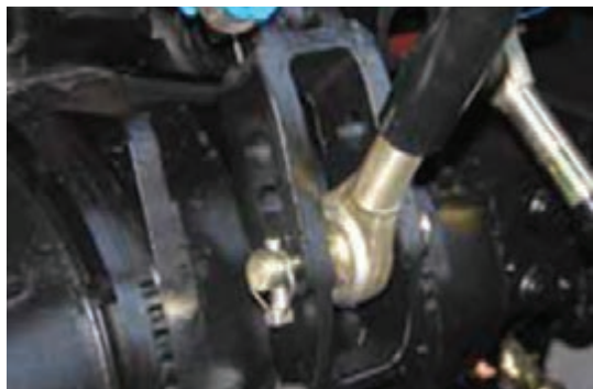
شکل ۴۱- محل نصب بازوی وسط روی تراکتور
