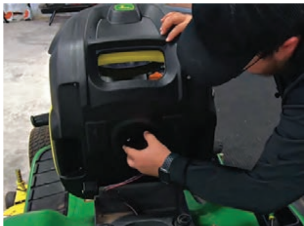
شکل ۵- سوئیچ ایمنی زیر صندلی تراکتور
