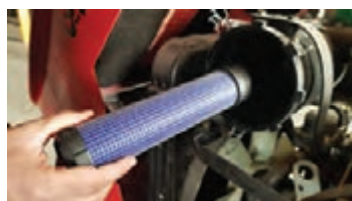
۶ صافی داخلی را در صورت لزوم تعویض کنید.
