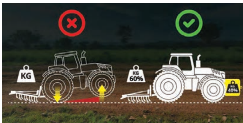
شکل ۶۰- تقسیم صحیح وزن تراکتور روی چرخ‌ها
