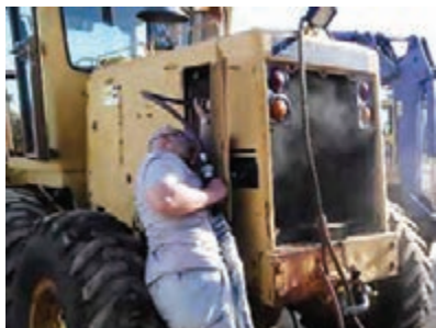
شکل ۳۲- تمیز کردن پره‌های رادیاتور
