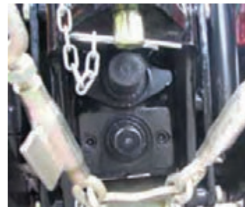
الف) محورهای توان‌دهی تراکتور باغی ب) اهرم انتخاب حالت‌های خلاص و درگیر ج) اهرم انتخاب حالت‌های چرخ‌گرد، موتور‌گرد و خلاص
