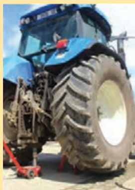
شکل ۷۰- مهار کردن صحیح تراکتور با جک و خرک
