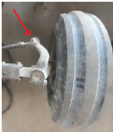
ب) محل تنظیم سرجمعی در تراکتورهای دارای فرمان نیمه هیدرولیک
