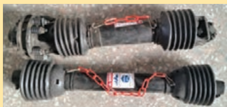
شکل ۶۸- گاردان ساده و گاردان مجهز به کلاچ ایمنی
