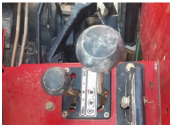
شکل ۳۹- اهرم‌های کنترل محور توان‌دهی تراکتور ITM399
