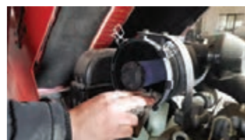
۴ داخل بدنه صافی را با پارچه تمیز کنید.
