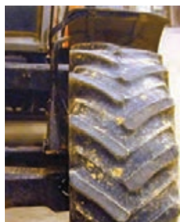
شکل ۱۵- لاستیک‌سایی در اثر تنظیم نبودن زاویه سرجمی
