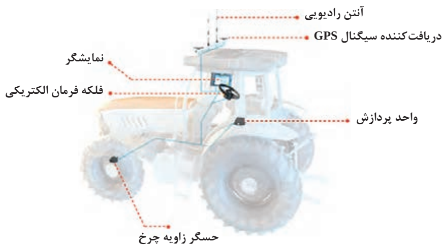
شکل ۵- یک نمونه فرمان‌گیری خودکار
