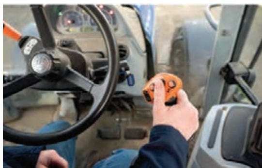
شکل ۱۸- اهرم تعیین وضعیت حرکت و جویستیک انتخاب دنده تراکتور نیوهلند T6090
