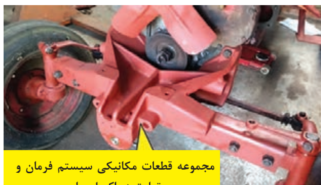
شکل ۲۱- مجموعه قطعات مکانیکی سیستم فرمان و تعلیق یک نمونه تراکتور
