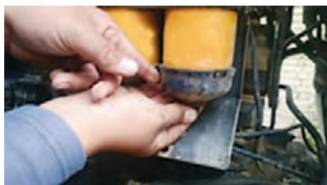
۱ شیر خروجی سوخت مخزن را ببندید. ۲ اطراف پایه صافی و روی صافی را تمیز کرده و شیر خروجی پایاله رسوب گیر را باز کنید تا سوخت پایاله تخلیه شود. ۳ یک دست را زیر فیلتر گرفته و با دست دیگر پیچ فیلتر را باز کنید.
