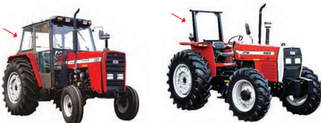
الف) تراکتور مجهز به قاب محافظ (ROPS)
