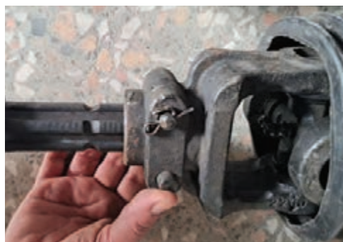
شکل ۷۰- اتصال گاردان به محور توان‌دهی
