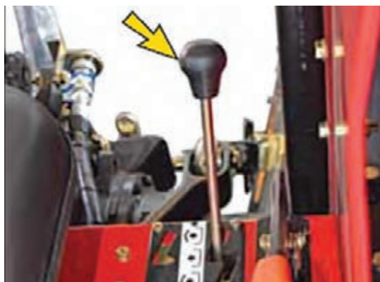
شکل ۳۸- اهرم کنترل محور توان‌دهی تراکتور ITM475
