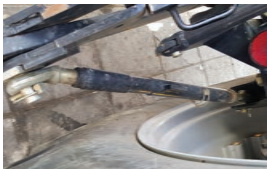
شکل ۴۲- بازوی مهارکننده تلسکوپی در حالت نوسانی
