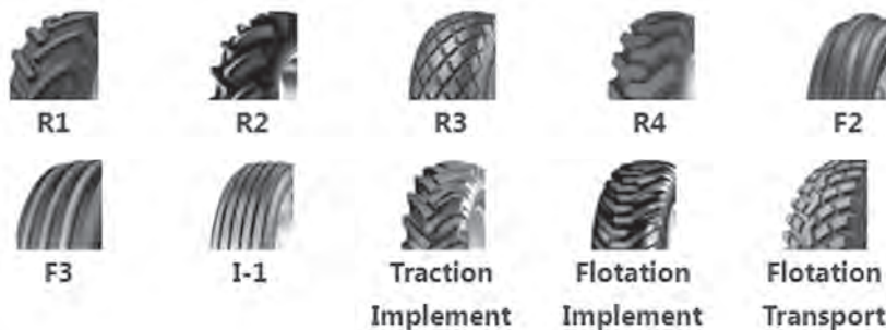
شکل ۳۵- الگوهای آج تایر تراکتورها و ماشین‌های کشاورزی
