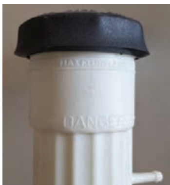
شکل ۲۵- علامت‌های روی مخزن روغن ترمز
