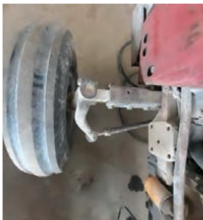
شکل ۵۲- اکسل جلو تراکتور تک دیفرانسیل
