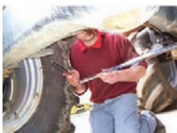
شکل ۱۶- اندازه‌گیری سرجمی به وسیله میله مخصوص
