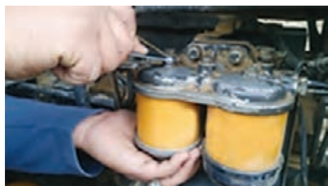
۱ شیر خروجی سوخت مخزن را ببندید. ۲ اطراف پایه صافی و روی صافی را تمیز کرده و شیر خروجی پایاله رسوب گیر را باز کنید تا سوخت پایاله تخلیه شود. ۳ یک دست را زیر فیلتر گرفته و با دست دیگر پیچ فیلتر را باز کنید.
