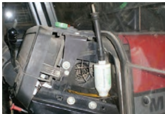
شکل ۲۶- تخلیه مایع هیدرولیک ترمز به صورت دستی
