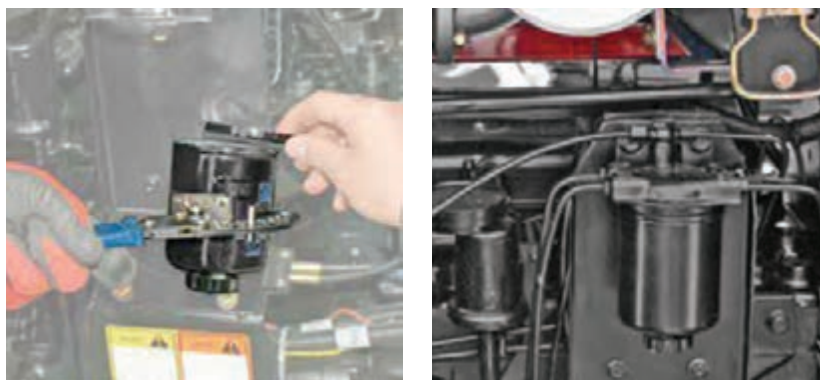
شکل ۱۵- فیلتر گازوئیل تراکتور ITM800 و نحوه باز کردن آن
