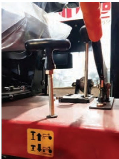
شکل ۴۱- اهرم درگیرکننده محور جلو تراکتور ITM399
