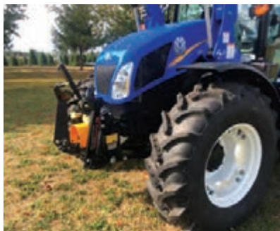
شکل ۳۶- اتصال سه نقطه جلو در وضعیت حمل و نقل
