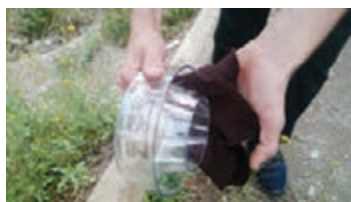
۵- با پارچه تمیز پایاله را پاک کرده و در صورت لزوم آن را با آب شسته و خشک کنید.
