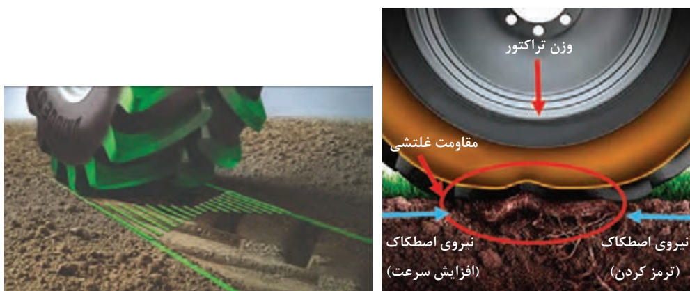
شکل ۵۷- اصطکاک بین چرخ و زمین سبب پیشروی تراکتور می‌شود.
