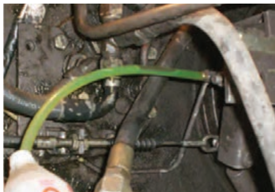
شکل ۲۶- تخلیه مایع هیدرولیک ترمز به صورت دستی
