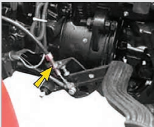
شکل ۲۰- روش تنظیم پدال کلاچ تراکتورهای ITM سری ۹۵۰
