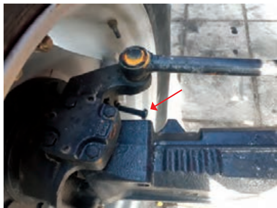
شکل ۵۴- محدودکننده فرمان تراکتورهای دو دیفرانسیل
