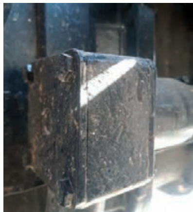
شکل ۱۶- درپوش پوسته صافی سیمی پمپ کمکی و المان صافی
