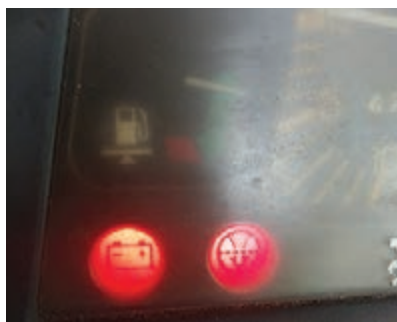
شکل ۹- حسگر صافی هوا و چراغ هشدار آن در تراکتور JD5105
