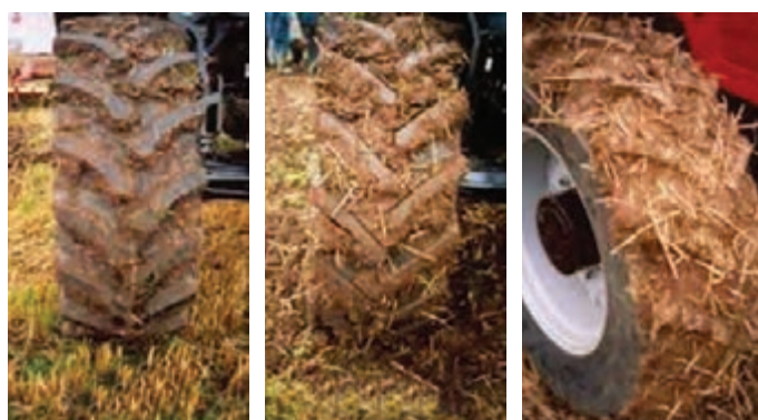
شکل ۵۶- رطوبت خاک روی بکسوات تأثیرگذار است
