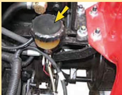
شکل ۱۲- مخزن روغن قفل دیفرانسیل تراکتور باگی G238
