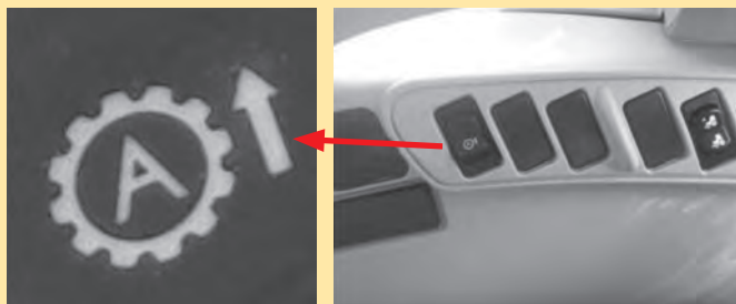
شکل ۲۰- دکمه انتخاب حالت اتوماتیک جعبه دنده تراکتور نیوهلند T6090
