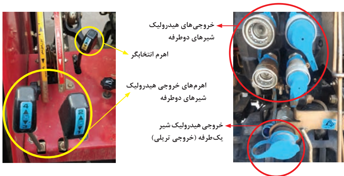
شکل ۷۴- اهرم‌های کنترل شیرهای خروجی هیدرولیک تراکتور ITM399
