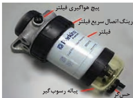
الف) پایاله رسوب گیر در تراکتورهای متداول (۱- پایاله، ۲- شیر تخلیه) ب) فیلتر آبگیر در تراکتورهای پیشرفته ج) پایاله رسوب گیر مجهز به حس گر شکل ۱۳- پایاله رسوب گیر
