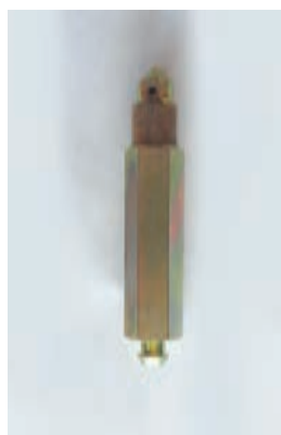
شکل ۲۷- پیچ هواگیری و محل قرارگیری آن بر روی تراکتور
