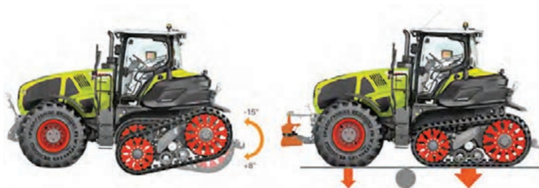
شکل ۱۰- سیستم تعلیق شنی عقب تراکتور کلاس AXION سری ۹ مدل چرخ زنجیری
