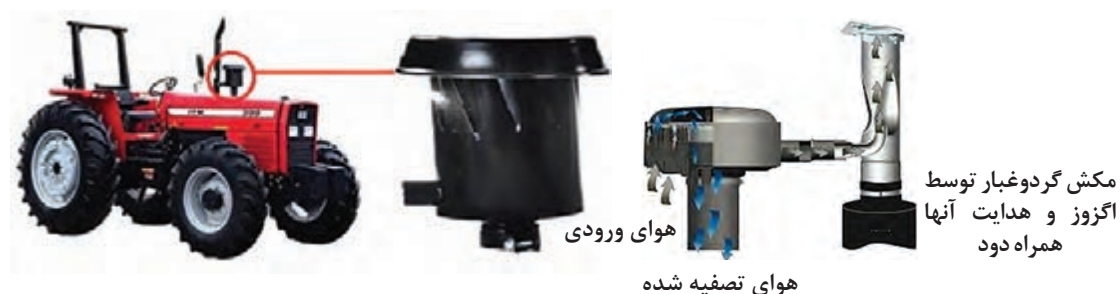
شکل ۵- پیش‌صافی بدون نیاز به مراقبت
