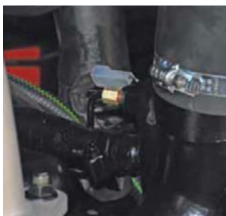
شکل ۱۱- محل نصب شمع گرم‌کن
