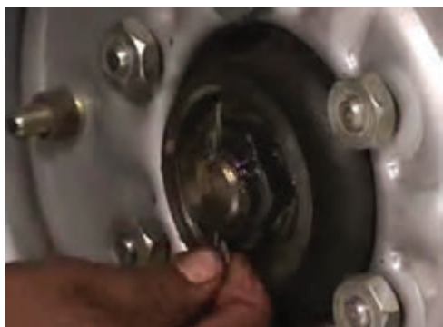
شکل ۲۸- مهره شیاردار و اشیپیل توپی چرخ جلو
