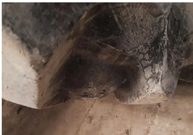
شکل ۶۷- تنظیم نبودن فشار باد تایر سبب آسیب دیدن آن می‌شود.
