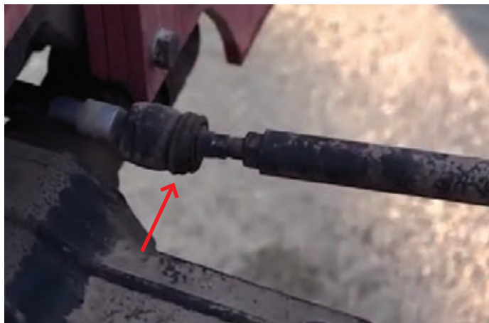
الف) محل تنظیم سرجمعی در تراکتورهای دارای فرمان هیدرواستاتیک
