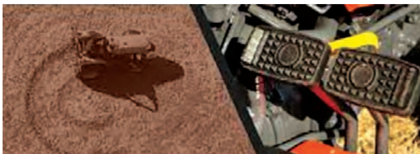
شکل ۲۸- دور زدن با تک پدال ترمز
