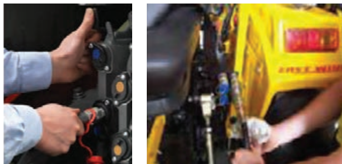
شکل ۷۶- تمیز کردن سرشیلنگی و اطراف خروجی هیدرولیک تراکتور
