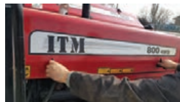
۱ شبکه‌های جلو یا بغل را برای دسترسی به صافی باز کنید.
