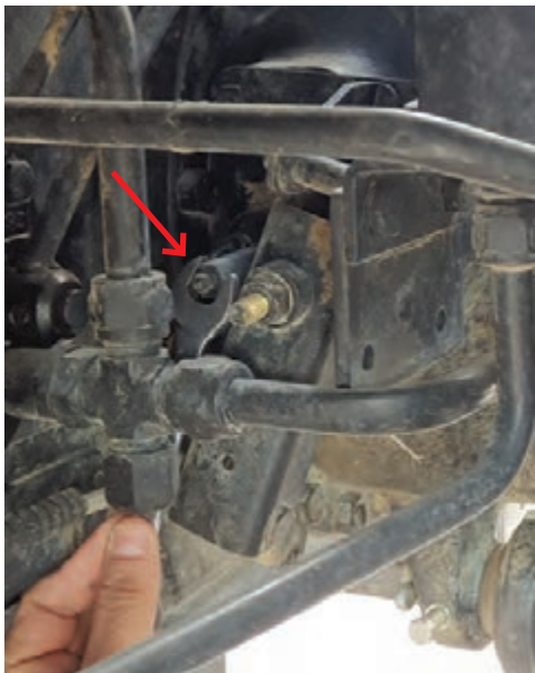
شکل ۲۸- شل و سفت کردن پیچ هواگیری ترمز
