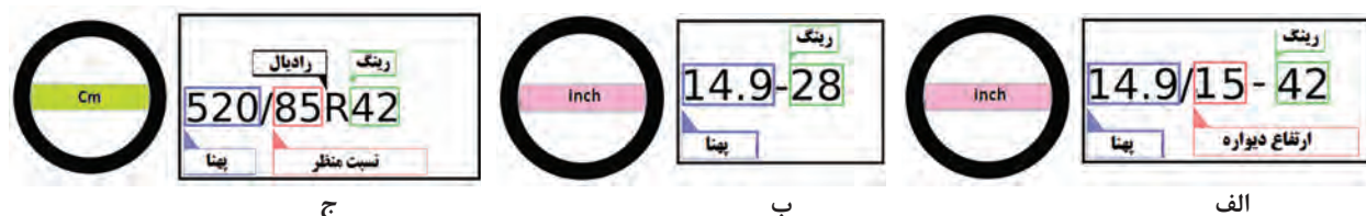
شکل ۳۷- مشخصات ابعادی سه نمونه تایر
