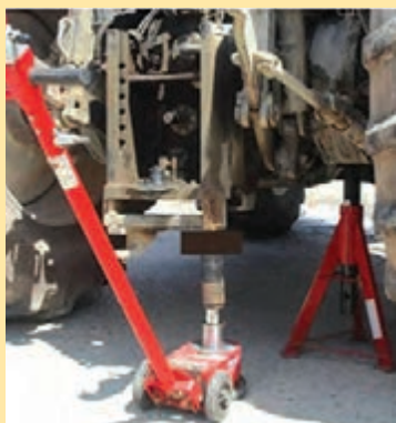
شکل ۷۰- مهار کردن صحیح تراکتور با جک و خرک
