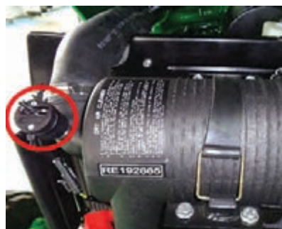
شکل ۹- حسگر صافی هوا و چراغ هشدار آن در تراکتور JD5105
