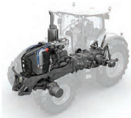
شکل ۹- تراکتور کلاس AXION سری ۹ با شاسی و سیستم تعلیق هیدرولیکی
