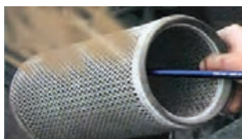
۵ صافی خارجی را مطابق توصیه کتابچه راهنما تمیز یا تعویض کنید.
