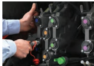
شکل ۷۲- خروجی های هیدرولیک تراکتور کلاس AXION960 و اهرم های کنترل آن
