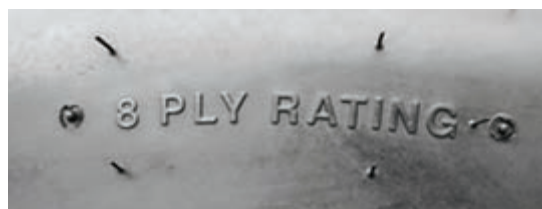
شکل ۳۳- مشخصات تعداد لایه تایر
