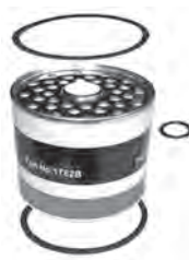
۴ مجموعه صافی را باز کرده و قسمت تحتانی کاسه صافی را تمیز کنید. ۵ واشرهای حلقوی را بازدید کنید و در صورت نیاز تعویض نمایید. ۶ برای بستن فیلتر، عکس مراحل قبل عمل کنید.
