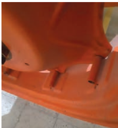
شکل ۵۱- محل اتصال دیسک به رینگ
