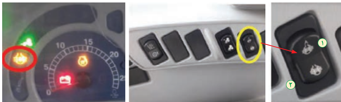
شکل ۲۳- فعال کردن قفل دیفرانسیل دستی و اتوماتیک در تراکتور نیوهلند T6090
