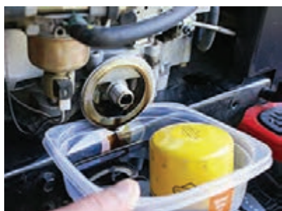
۱ با استفاده از کتاب راهنمای سرویس موتور، مکان نصب فیلتر روغن مشخص شود.
