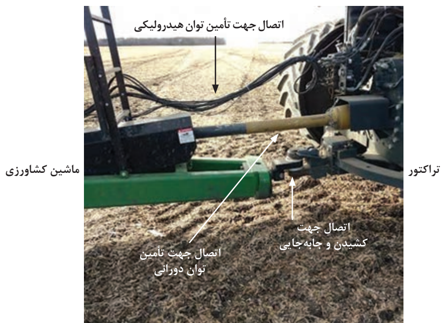
شکل ۲۹- تراکتور واحد تأمین توان ماشین‌های کشاورزی است.
