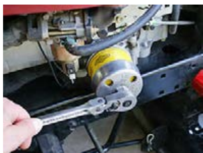
۲ با استفاده از ابزار مخصوص (آچار فیلتر) فیلتر روغن باز شود.
