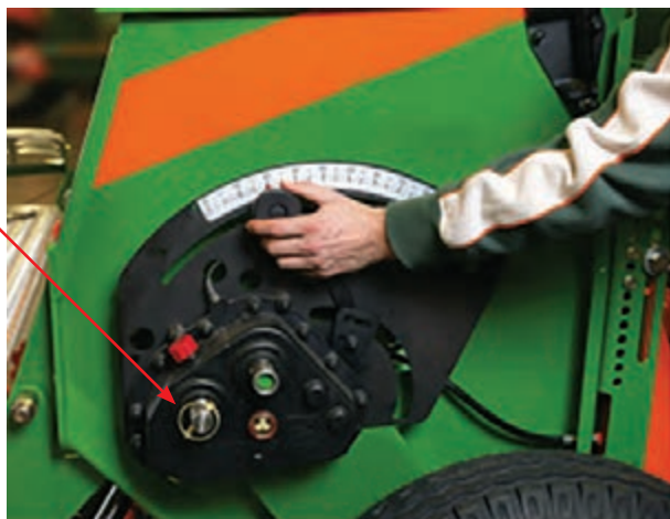
شکل ۸۶- انتخاب درجه جعبه دنده با توجه به مقدار ریزش بذر
