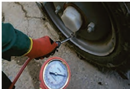
شکل ۳۸- تنظیم باد چرخ‌های دستگاه
