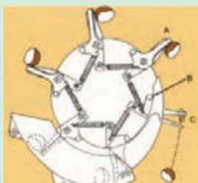
تصویر شماتیک نحوه کار موزع انگشتی
