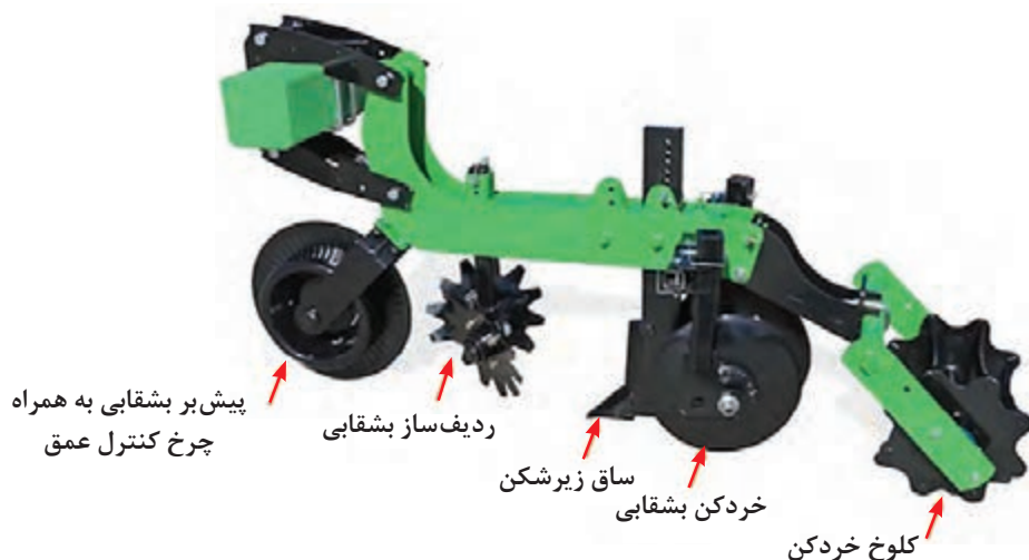
شکل ۳۸- یک واحد ماشین خاک‌ورزی نواری با پیش‌بر شیاری
