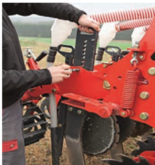
شکل ۵۴- تنظیم ساق زیر شکن با حرکت در جهت عمودی
