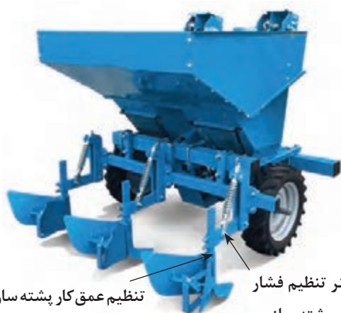
شکل ۷۱- تغییر موقعیت چرخ تثبیت عمق کاشت سیب زمینی کار
