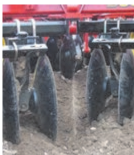
شکل ۱۹- تنظیم زاویه برش به وسیله اهرم مکانیکی شکل ۲۰- همپوشانی بشقاب‌ها
