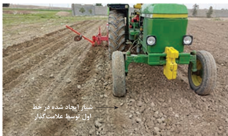
شکل ۲۸- عملیات کاشت در حالت برگشت
