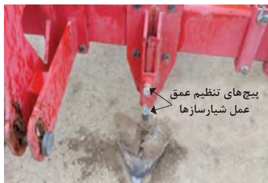
شکل ۱۷- پیچ های تنظیم عمق شیارساز
