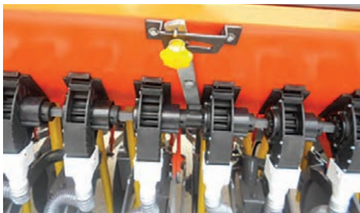
شکل ۲۷- اهرم تغییر طول استوانه شیاردار
