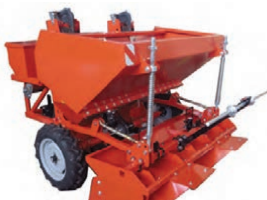
شکل ۷۳- قطعات قابل تنظیم در شکل دهنده پشته ها
