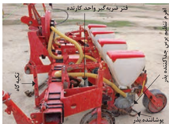
شکل ۸- ساختمان ردیف کار پنوماتیکی بدون کود کار از پهلوی دستگاه
