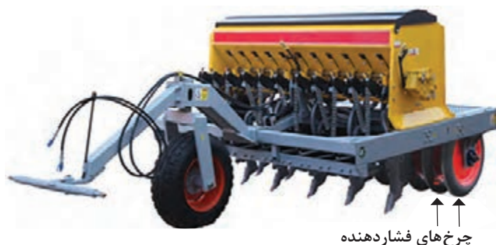
شکل ۸- چرخ‌های فشاردهنده به عنوان چرخ انتقال نیرو
