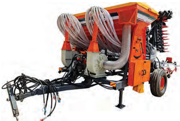
شکل ۷۵- یک نمونه خطی کار الکتروپنوماتیک که در داخل کشور تولید و مونتاژ می‌شود.
