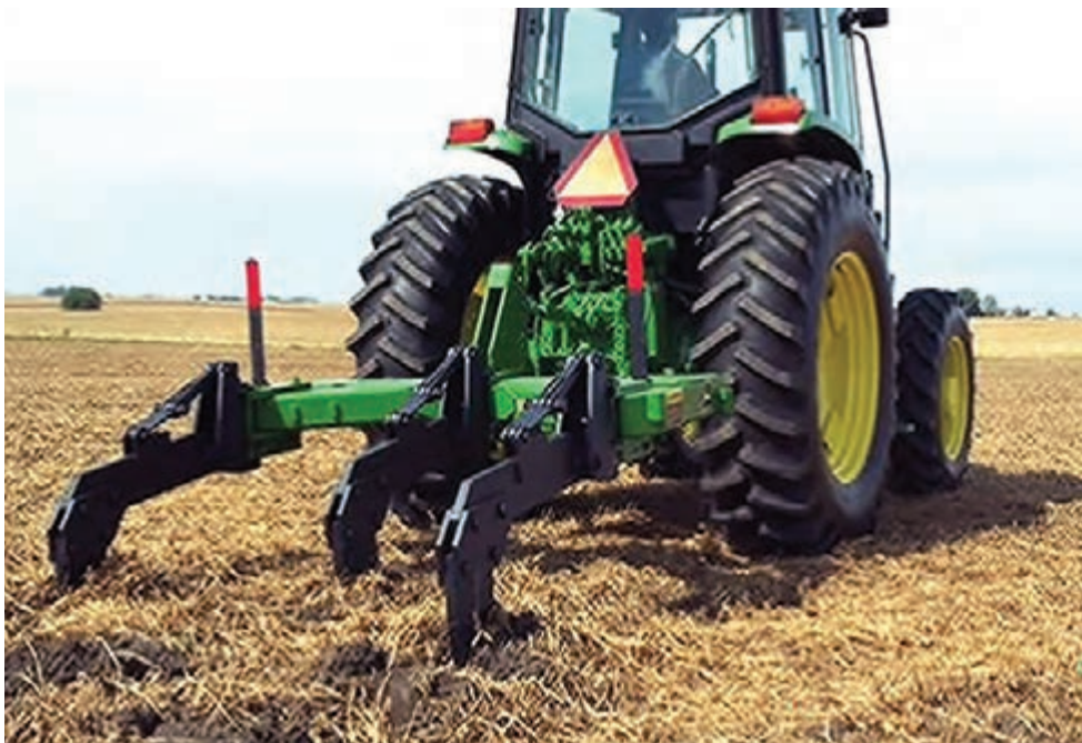
شکل ۵۹- استفاده از زیرشکن برای شکستن لایه‌های سخت خاک
