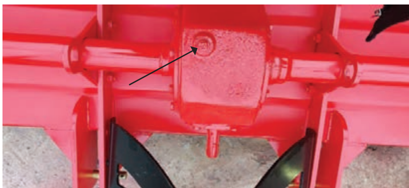
الف) دریچه بازدید و روغن کاری جعبه دنده
