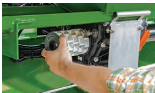
شکل ۸۵- تعویض غلتک (کارتریج) با توجه به اندازه بذر
