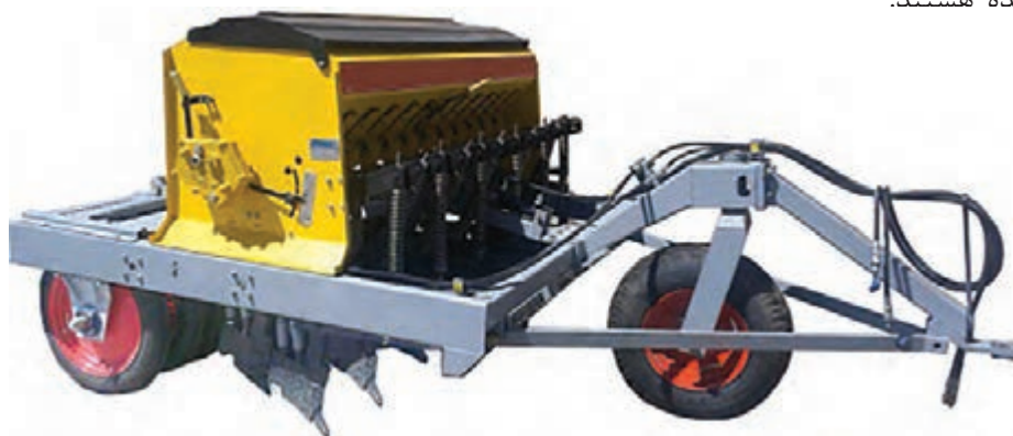
شکل ۵- خطی کار مخصوص کشت دیم با چرخ‌های فشاردهنده
