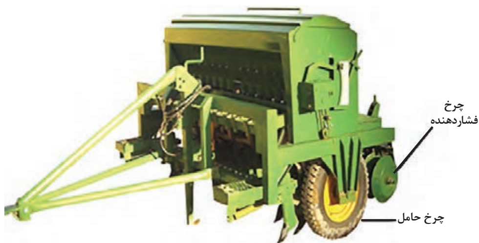
شکل ۶- خطی کار مخصوص کشت دیم، از نوع چرخ انتقال نیرو مستقل از چرخ‌های فشاردهنده
