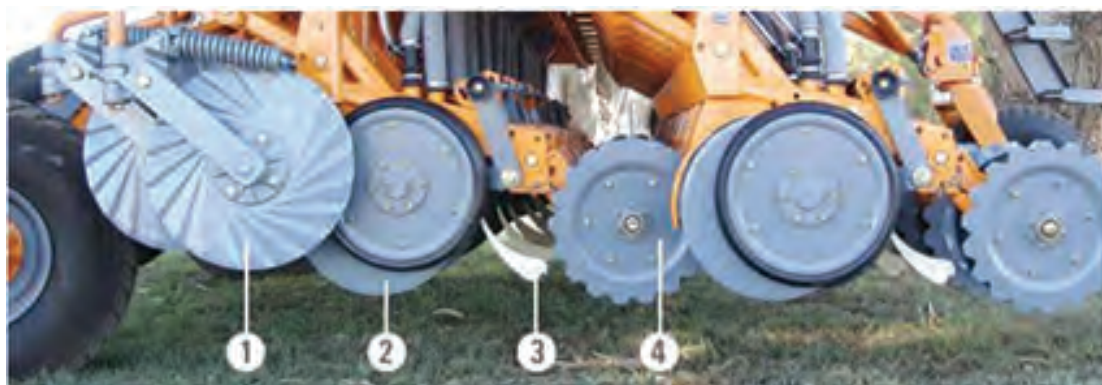
۱- پیش بر بشقابی نوع توربو ۲- شیار بازکن بشقابی ۳- تحکیم کننده بذر از نوع لغزشی ۴- پوشاننده دو بشقابی
