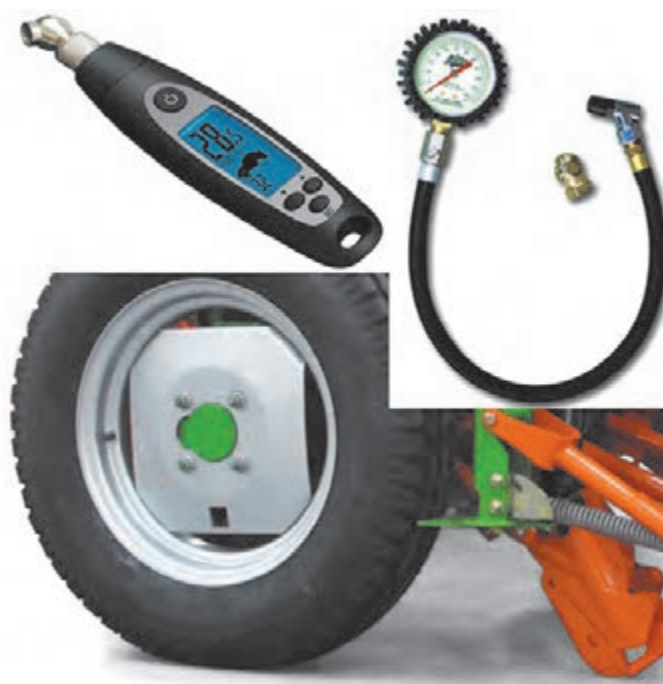
شکل ۵۸- تنظیم باد چرخ خطی کار
