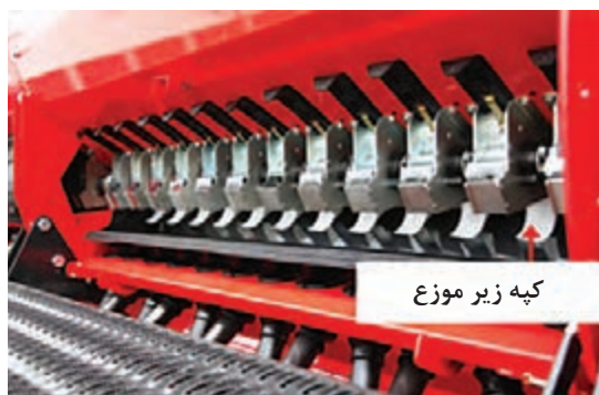
شکل ۱۸- دریچه زیر موزع (کپه زیر موزع)
