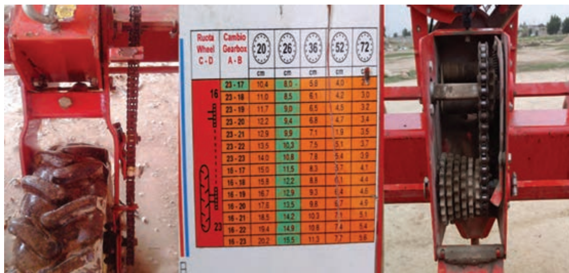
شکل ۲۵- تغییر در وضعیت چرخ دنده‌ها
