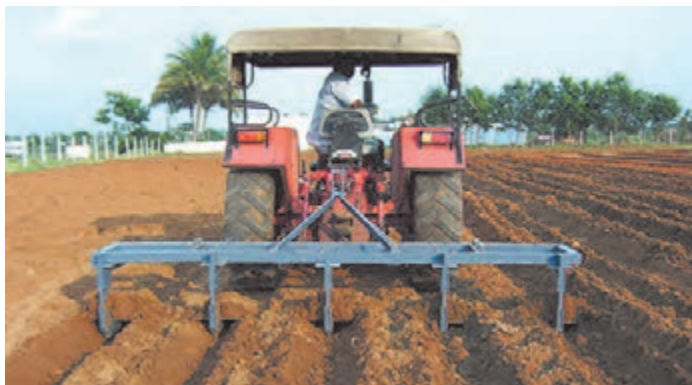
الف) قرار دادن یکی از شیار بازکن‌ها در داخل شیار
