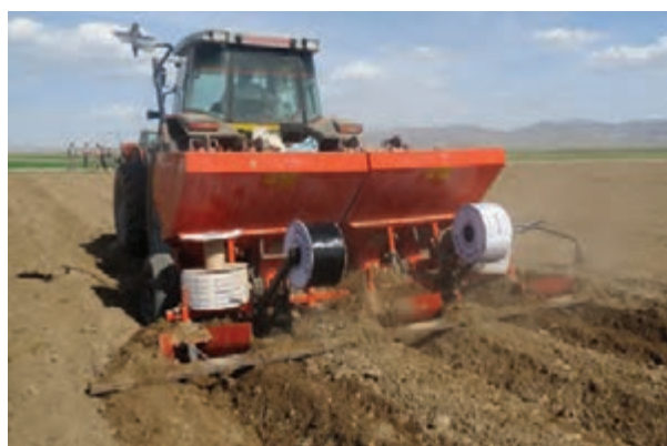
شکل ۶۷- غده کار خودکار با قابلیت خواباندن لوله‌های تیپ
