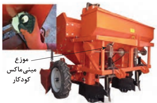
شکل ۷۴- تنظیم موزع مینی ماکس کودکار
