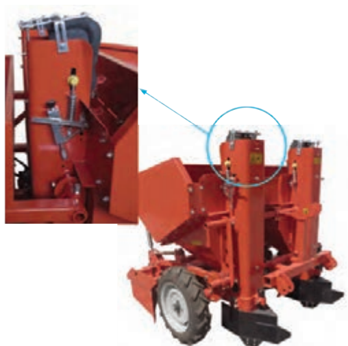
شکل ۷۲- مکانیزم تنظیم کشش نوار نقاله و تک دانه کن
