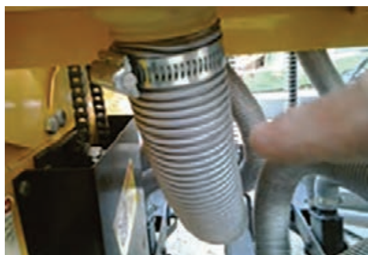
شکل ۳۹- ماشین کاشت دارای لوله‌ها و شیلنگ‌های متعددی هستند که اغلب با بست پیچی یا پرسی محکم می‌شوند.
