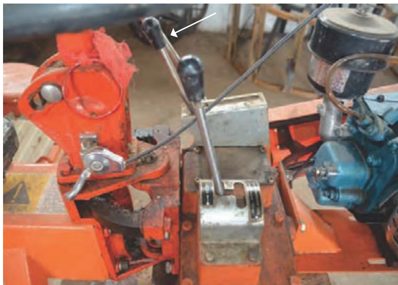
شکل ۴۸- اهرم تنظیم فاصله بین کپه نشاها روی ردیف
