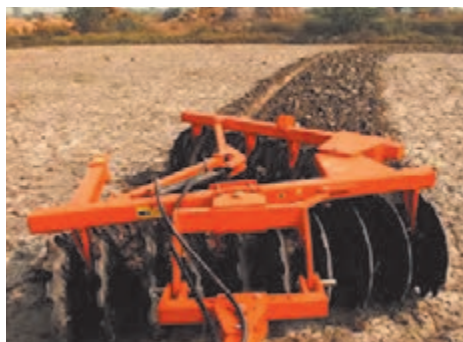
شکل ۱۷- تنظیم زاویه برش به وسیله جک هیدرولیک شکل ۱۸- تنظیم زاویه برش به وسیله پیچ و مهره
