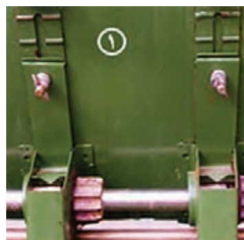
تنظیم دریچه بین مخزن و موزع
