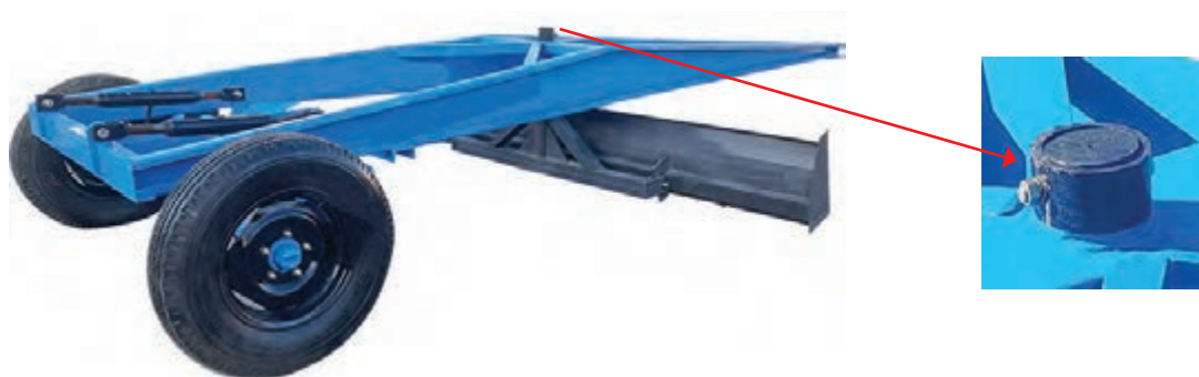
شکل ۱۱- زاویه تیغه نسبت به جهت حرکت و نحوه تنظیم آن
