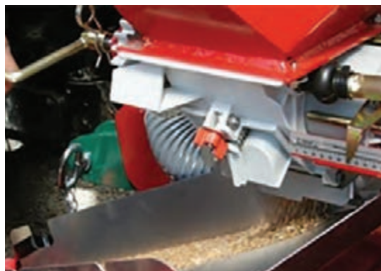
شکل ۸۴- چرخاندن هندل و جمع‌آوری بذر از زیر موزع
