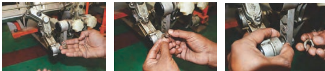
شکل ۵۳- خارج کردن و جا زدن مجدد واشر تنظیم
