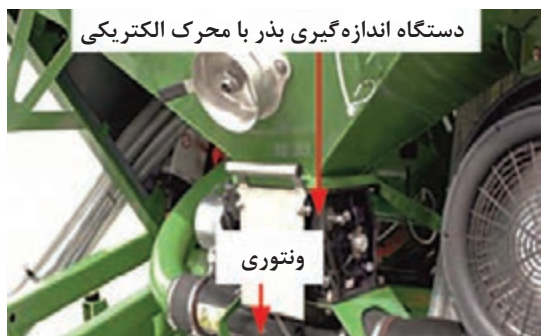
شکل ۷۶- اجزای یک کارنده الکتروپنوماتیک
