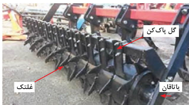
شکل ۴۲- غلتک خاک‌ورز مرکب و ضمايم آن
