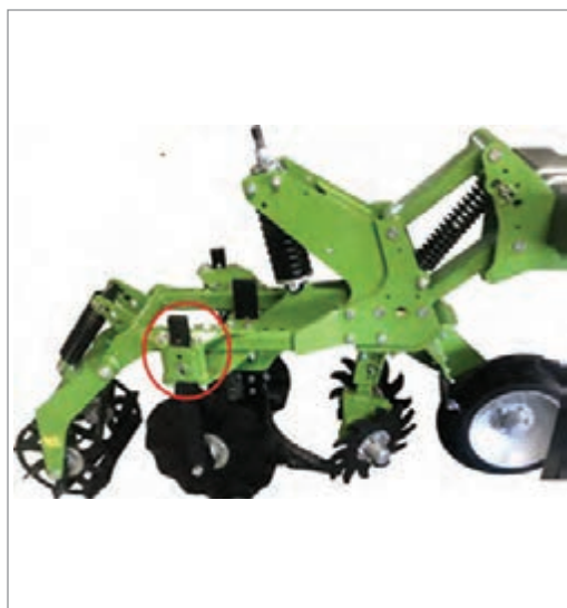
شکل ۵۵- تنظیم ارتفاع بشقاب‌ها
