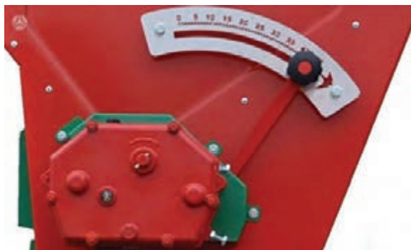
شکل ۳۰- تغییر سرعت چرخش موزع دندانه دار
