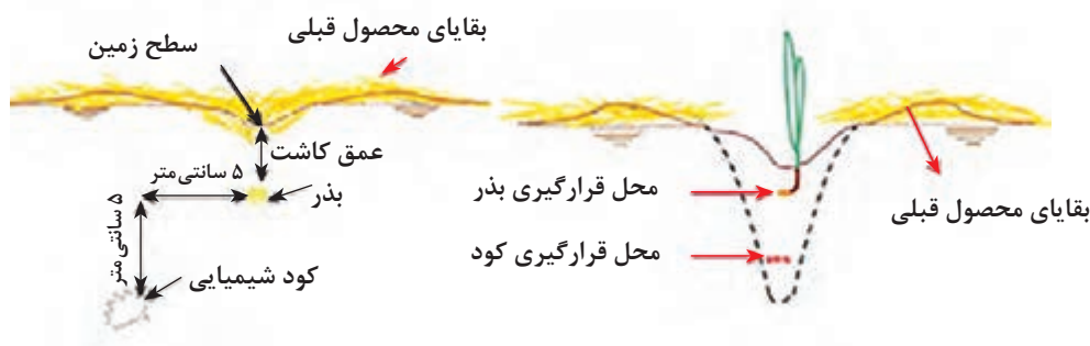
شکل ۶۱- محل قرارگیری کود و بذر در داخل خاک
