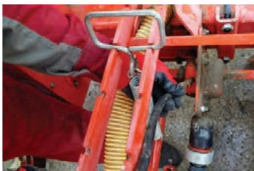
شکل ۱۲- گریس کاری تمام گریس خورهای ماشین ردیف کار
