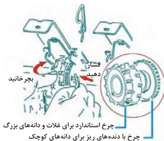
شکل ۳۳- تنظیم موزع‌های دستگاه برای بذور ریز
