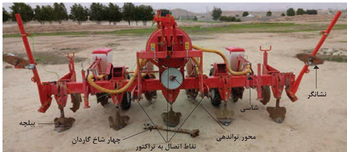
شکل ۶- ساختمان ردیف کار پنوماتیکی بدون کودکار از جلوی دستگاه
