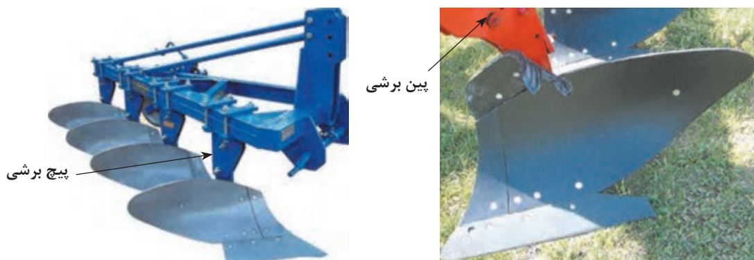
شکل ۷- پین و پیچ برشی در گاواهن برگردان‌دار
