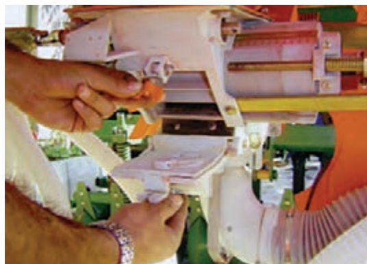
شکل ۸۲- دریچه تخلیه زیر مخزن
