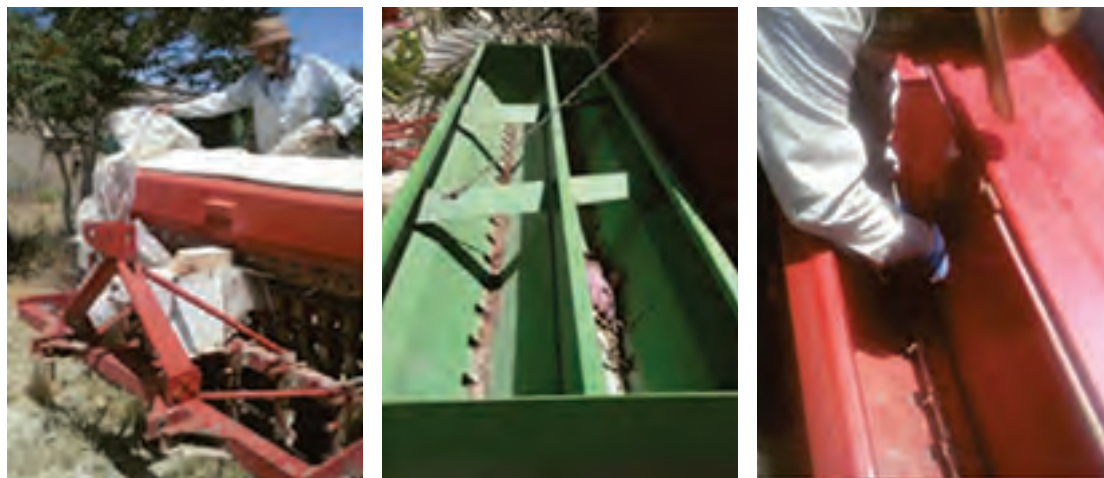
شکل ۳۴- برداشتن روکش ماشین و تمیز کردن داخل مخزن
