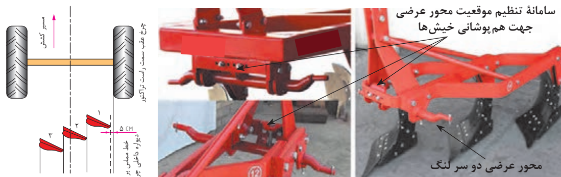
شکل ۲۰- تنظیم هم پوشانی (عرض کار) در گاواهن برگردان دار
