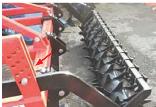
شکل ۴۶- تنظیم دامنه حرکت غلتک در جهت عمودی با استفاده از پین
