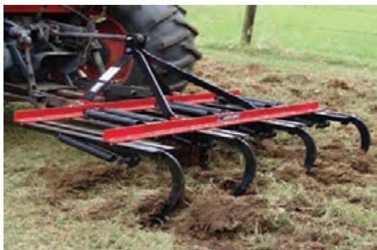
شکل ۳۲- اجرای کم خاک‌ورزی تمام سطح به وسیله چیزل
