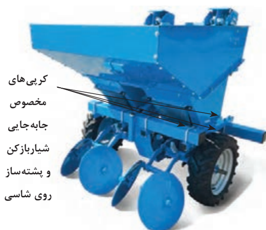
شکل ۶۹- کری های مخصوص تنظیم اندازه پشت ساز
