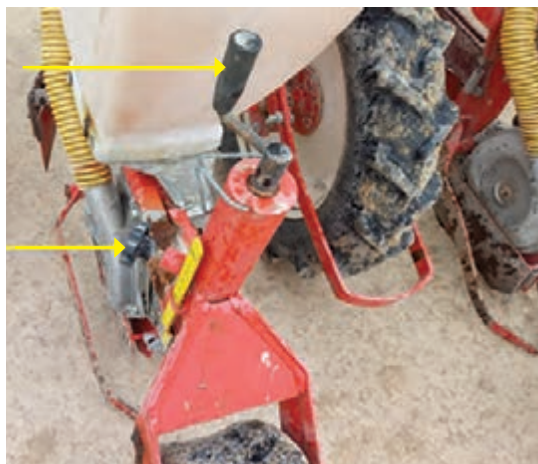
شکل ۲۱- تنظیم چرخ فشاردهنده
