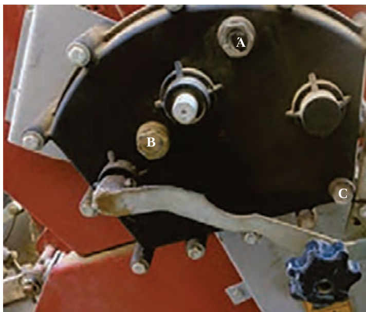
شکل ۳۵- جهت پر کردن مخزن جعبه دنده از روغن، ابتدا پیچ (A) را باز کرده سپس به اندازه‌ای روغن به مخزن اضافه کنید که روی پیچ (B) روغن مشاهده شود. جهت تخلیه روغن جعبه دنده از پیچ (C) استفاده کنید.
