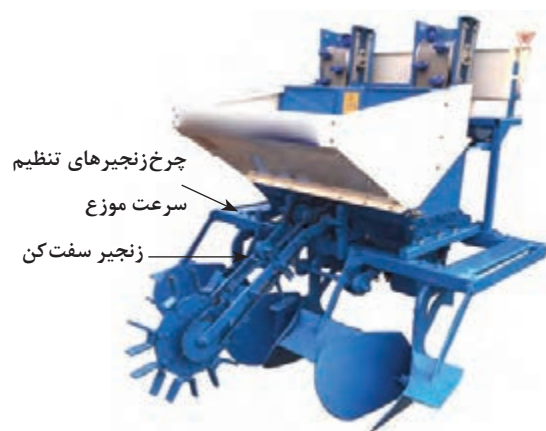
شکل ۷۰- زنجیر و چرخ زنجیر سیستم محرک موزع سیب زمینی کار
