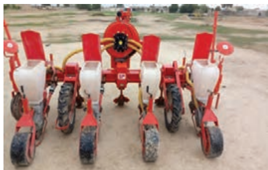
شکل ۲- ردیف‌کار پنوماتیکی (با حذف بخش کودکار)
