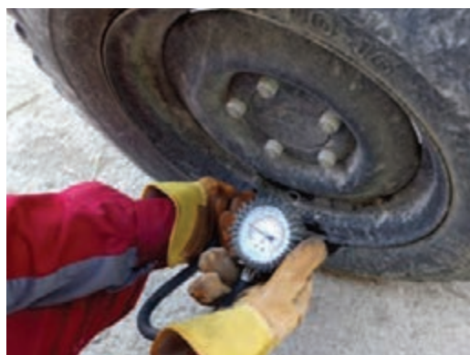
شکل ۱۳- تنظیم باد چرخ‌ها به مقداری که در دفترچه راهنمای ماشین نوشته شده است
