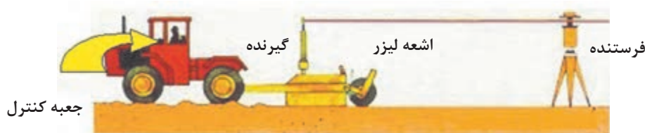
شکل ۳- نحوه عملکرد تسطیح‌کن لیزری
