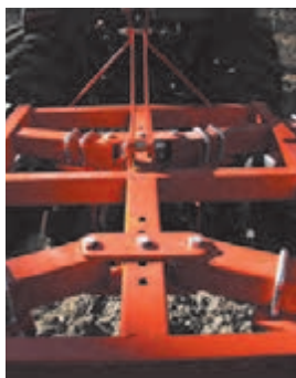
شکل ۱۷- تنظیم زاویه برش به وسیله جک هیدرولیک شکل ۱۸- تنظیم زاویه برش به وسیله پیچ و مهره
