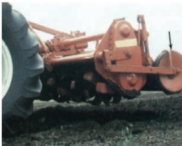
شکل ۴۷- عمق شخم و تنظیم آن با چرخ تنظیم عمق
