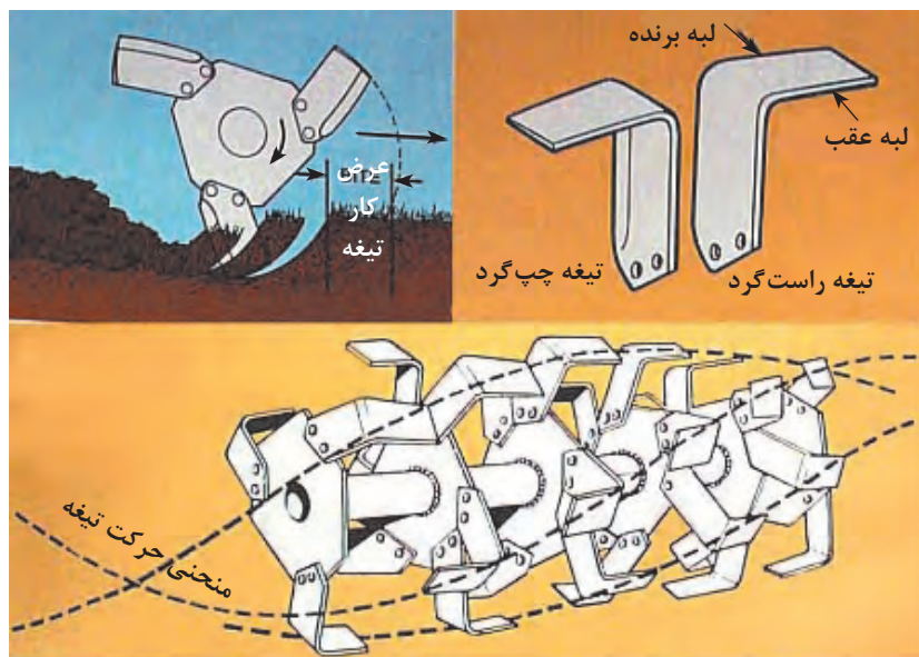
شکل ۴۰- محور گردنده و تیغه‌ها در گاوآهن دوار
