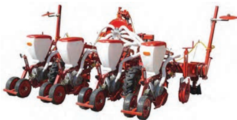
شکل ۳- ردیف کار پنوماتیکی تک دانه کار دوخط روی پشته
