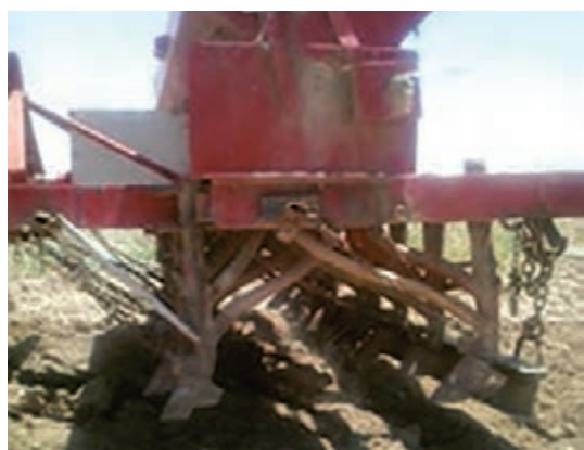
شکل ۴۱- برای تراز عرضی از پشت و برای تراز طولی از بغل به دستگاه نگاه کنید.
