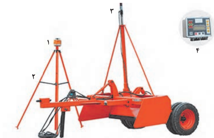
اجزای مختلف تسطیح کن لیزری (۱- فرستنده ۲- سه پایه ۳- گیرنده ۴- جعبه کنترل)
