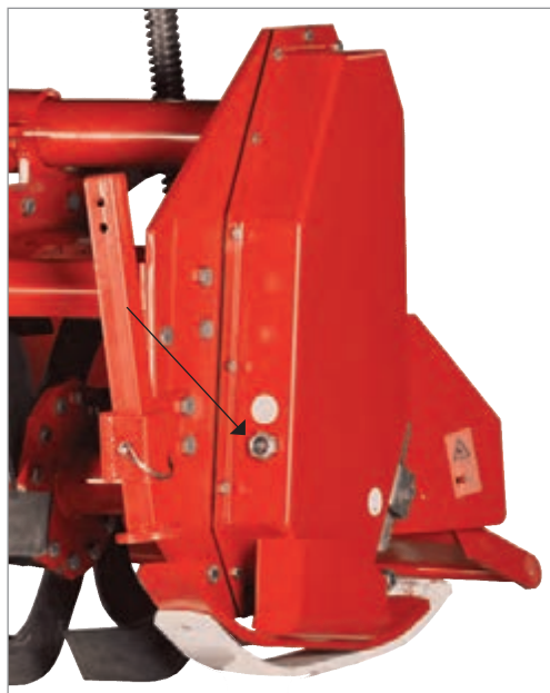
ب) دریچه بازدید و روغن کاری زنجیر و چرخ زنجیر
