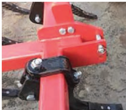
شکل ۴۳- مهره‌های کربی خاک‌ورز قبل از شروع کار باید آچارکشی شوند.
