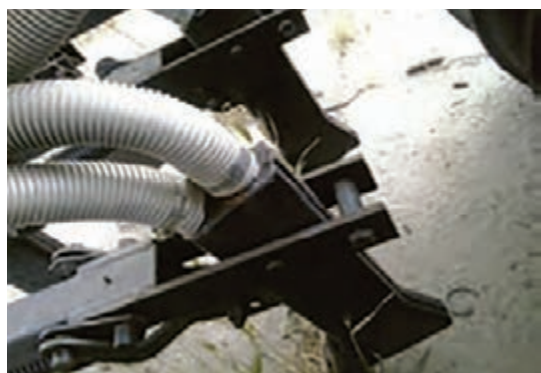
شکل ۳۹- ماشین کاشت دارای لوله‌ها و شیلنگ‌های متعددی هستند که اغلب با بست پیچی یا پرسی محکم می‌شوند.
