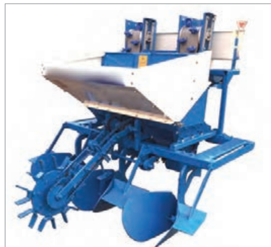
شکل ۶۶- غده کار خودکار دو ردیفه سوار با موزع پیاله ای
