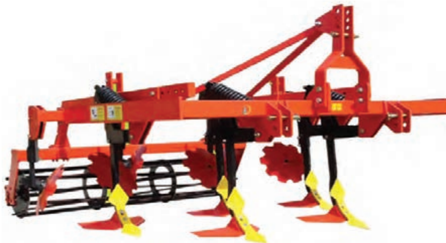
شکل ۳۴- خاک‌ورز مرکب با کلوخ خردکن دیسکی و غلتک قفسی
