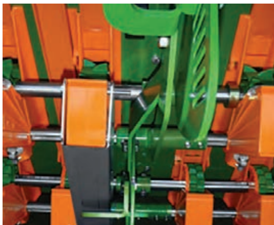
شکل ۳۲- محل قرارگیری دستگیره تنظیم کپه زیر موزع
