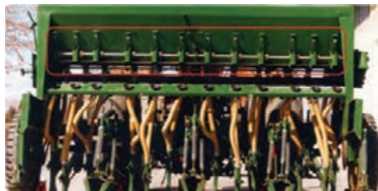
شکل ۴۶- بستن دریچه‌های بین مخزن و موزع
