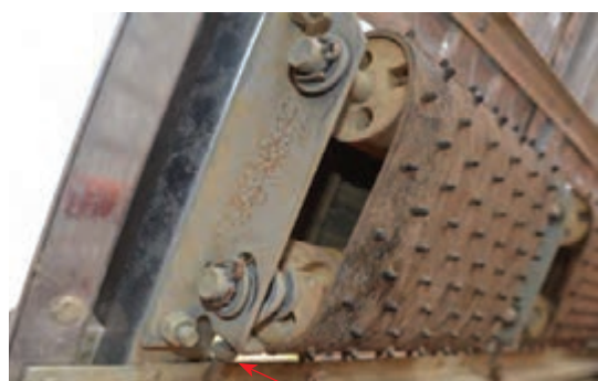
شکل ۵۱- تنظیم کشش تسمه انتقال نشاها
