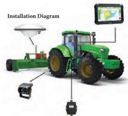
شکل ۴- نحوه قرارگیری اجزا در تسطیح‌کننده ماهواره‌ای
