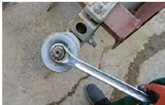
شکل ۴۳- شیار بازکن و مهره نگهدارنده فنر و تنظیم فشار
