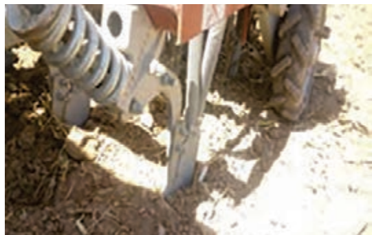
شکل ۴۳- شیار بازکن و مهره نگهدارنده فنر و تنظیم فشار
