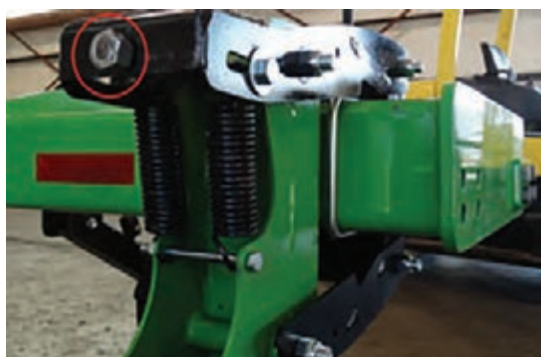
شکل ۵۲- پیچ تنظیم فشار فنر
