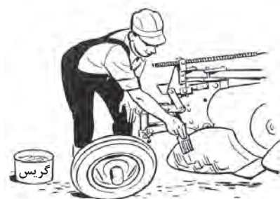
شکل ۳۸- اندود کردن قطعات گاو آهن با مواد ضد زنگ
