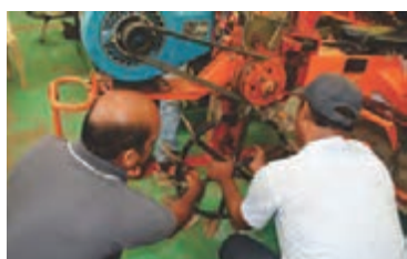
شکل ۵۶- تعویض چرخ‌های نشاکار
