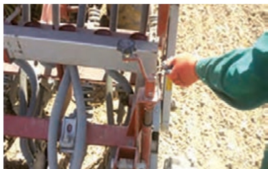
شکل ۴۲- آزاد کردن ضامن و تنظیم عمق کاشت با چرخش اهرم در سیستم یکپارچه
