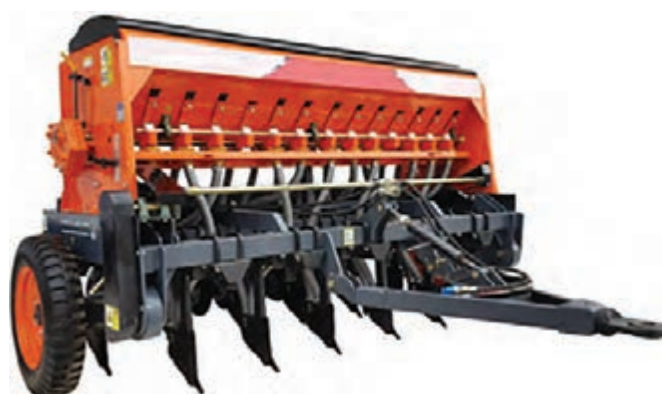
شکل ۹- چرخ‌های طرفین به عنوان چرخ انتقال نیرو
