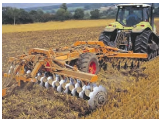
شکل ۳۱- اجرای کم‌خاک‌ورزی تمام سطح به وسیله دیسک
