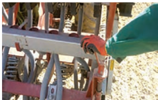
شکل ۴۲- آزاد کردن ضامن و تنظیم عمق کاشت با چرخش اهرم در سیستم یکپارچه
