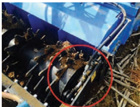
ج) استفاده از جک هیدرولیکی
