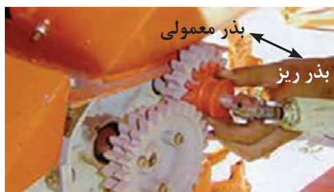
شکل ۷۸- تنظیم چرخ دنده با توجه به اندازه بذر
