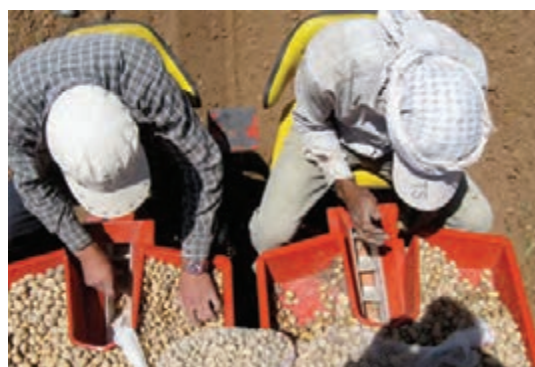
شکل ۶۵- غده کار نیمه خودکار با موزع افقی مخصوص سیب زمینی های ریز
