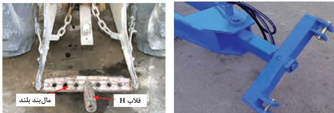
شکل ۱۰- اتصال تسطیح‌کن کششی سبک به تراکتور
