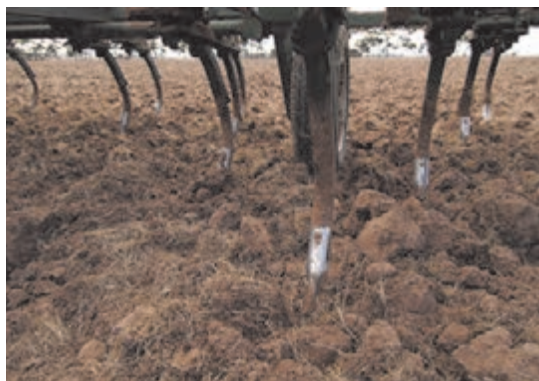
شکل ۳۶- زمین شخم خورده به وسیله گاواهن قلمی
