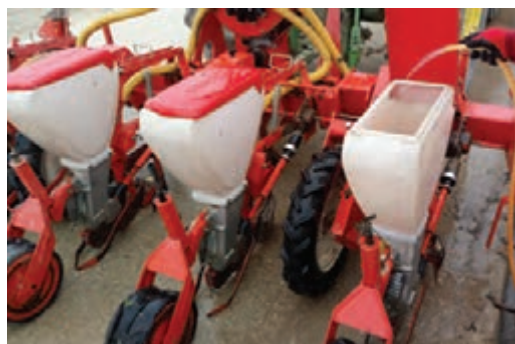
شکل ۱۱- شست و شو و تمیز کردن ماشین ردیف کار
