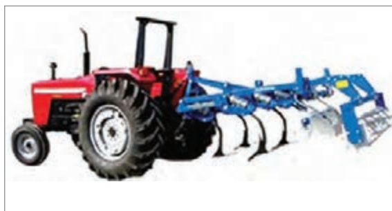
شکل ۴۴- اتصال خاک‌ورز مرکب سوار به تراکتور
