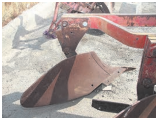
شکل ۱۸- پین بریده شده در گاواهن
