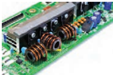
شکل ۴-۱۰ برای به حداقل رساندن اثر القای متقابل در برخی از مدارهای الکتریکی، القاگرهای مجاور را به گونه‌ای قرار می‌دهند که سطح حلقه‌های آنها بر یکدیگر عمود باشد.
