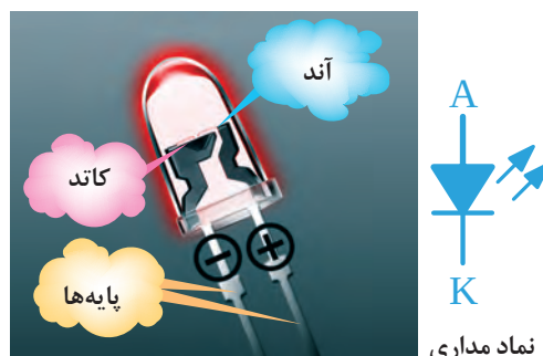
شکل ۳۰- نماد فنی و ساختمان داخلی LED
