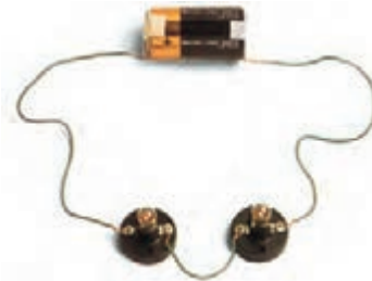
شکل ۲- مدار واقعی دو لامپ به صورت سری
