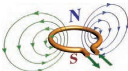
شکل ۱۹- میدان مغناطیسی حاصل در یک حلقه
