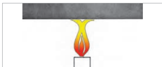
شکل ۱۱- خنثی کردن اثر مغناطیسی یک آهن را به وسیله گرما
