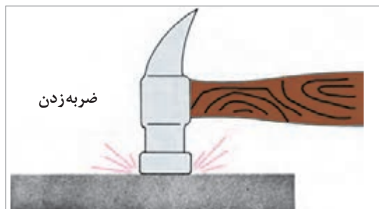
شکل ۱۰- خنثی کردن اثر مغناطیس آهن را با زدن ضربه
