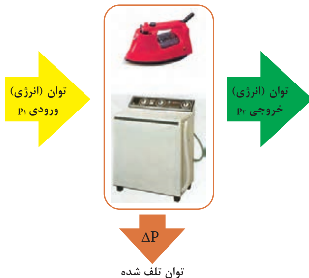
شکل ۸۳- وضعیت مصرف‌کننده‌ها از نظر توان
