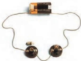
شکل ۱۴- قطع سیم یا لامپ موجب قطع شدن مدار سری می‌شود.
