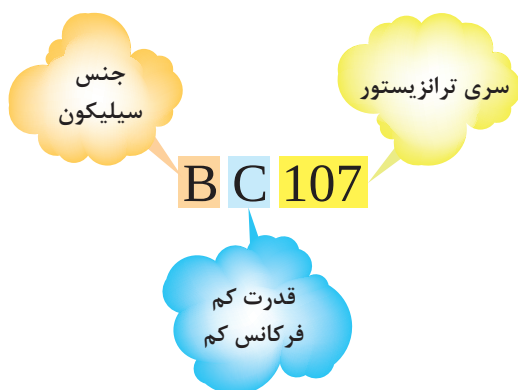
شکل ۶۹- مشخصات ترانزیستور BC107
