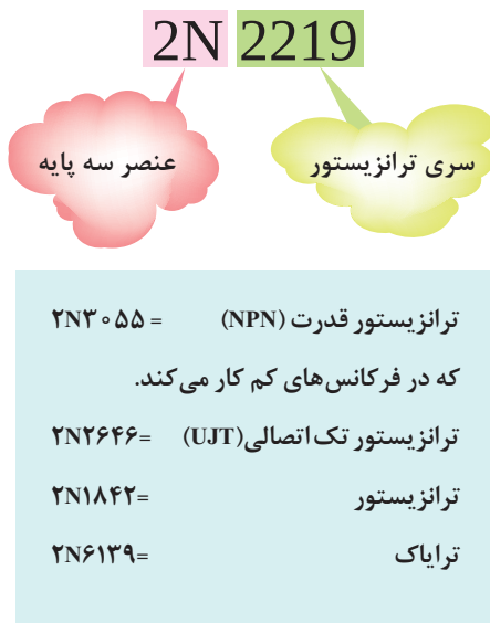
شکل ۷۰- مشخصات ظاهری چند المان سه قطبی
