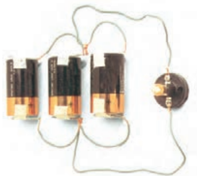
شکل ۹۷- شکل ظاهری و نقشه فنی مدار چند پیل موازی
