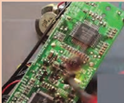
شکل ۴۲- قطعاتی از برد سوخته است.
