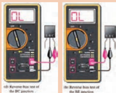
شکل ۵- دیودهای بیس - امیتر و بیس - کلکتور در بایاس مخالف
