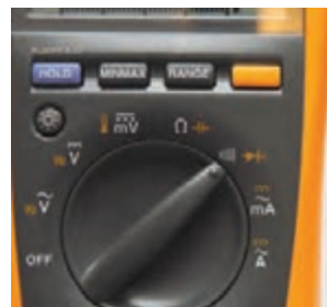
شکل ۵- مولتی‌متر دیجیتالی در حالت آزمایش دیود
