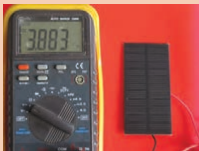
شکل ۹۱- اندازه‌گیری ولتاژ سلول خورشیدی
