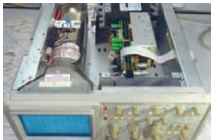
شکل ۸۳- ساختمان داخلی یک نوع اسیلوسکوپ
