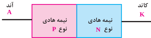
شکل ۴۸- ساختمان داخلی دیود زنر
