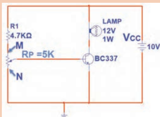
شکل ۱۲- مدار آزمایش هدایت ترانزیستور
