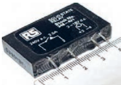
شکل ۱۷۳- یک نوع رله حالت جامد
