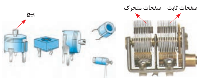
الف) خازن واریابل ب) خازن های تریمر شکل ۹۲- خازن های واریابل و تریمر
