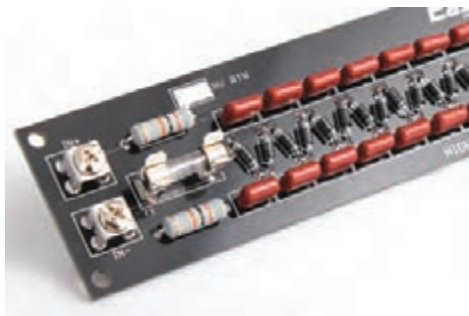
شکل ۸۴- مدار چندبرابر کننده ولتاژ با قطعات واقعی
