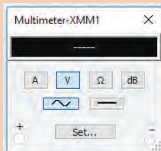
شکل ۶۷- تنظیم مولتی‌متر برای اندازه‌گیری ولتاژ AC
