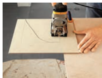
شکل ۶۰- برش قطعه بر اساس فاصله کناره‌های در انجام می‌شود
