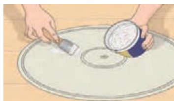
شکل ۱۸۰- با کاردک مقدار مناسبی از چسب در هر مرحله به پشت ابزار زده و آن را پخش می‌کنند تا پشت آن آغشته به چسب شود.
