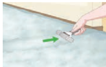
شکل ۷۰- لبه‌های درز را با غلتک فرش ببندید.
