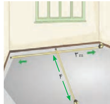
شکل ۵۴ - اندازه گیری طول و عرض اتاق برای خرید موکت
