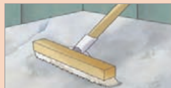
۴- سطح فضا را برای اجرای موکت از گرد و خاک پاک نمایید.
