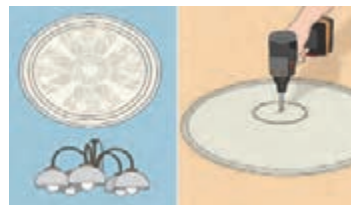
شکل ۱۷۵- حفره ای با قطری متناسب با سیم‌هایی که از آن رد خواهند شد با استفاده از دریل ایجاد می‌شود.
