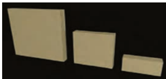
شکل ۱۲۹- مقایسه ابعاد سه آجر قزاقی، ختایی و فشاری با یکدیگر
