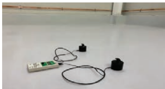
شکل ۸۶- اجرای آزمایش برای اطمینان از آنتی استاتیک بودن کف پوش
