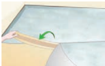
شکل ۶۹- هر دو لبه موکت با چسب نواری دوطرفه چسبانده شود.
