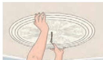
شکل ۱۸۱- با نزدیک کردن ابزار به سقف سیم‌های برق را از آن عبور داده، قطعه ابزار در محل خود قرار گرفته و با دست حدود ۳ دقیقه نگه داشته می‌شود.
