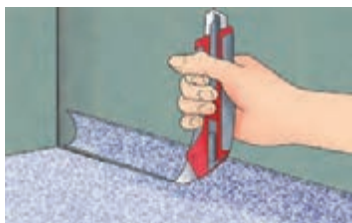
شکل ۷۲- بریدن لبه‌های اضافی موکت
