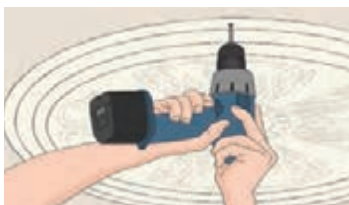
شکل ۱۸۲- با استفاده از دریل، قطعه ابزار با پیچ در جای خود محکم می‌شود.
