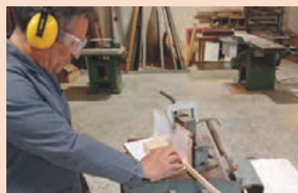
شکل ۱۲۶- نحوه قرارگیری گونیای چوبی دست ساز بر روی ماشین فارسی بر قطع کن از پایین (صندوقی)
