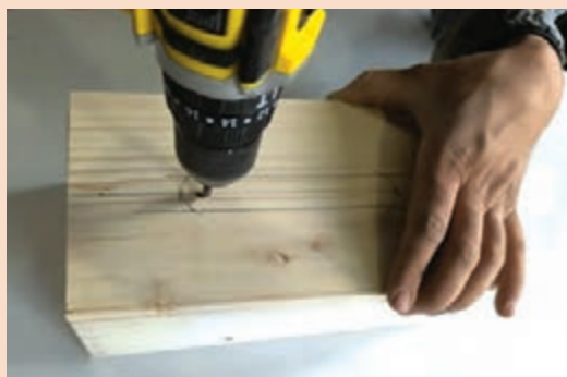
شکل ۶۱- سوراخ کاری وسط طرح شکاف
