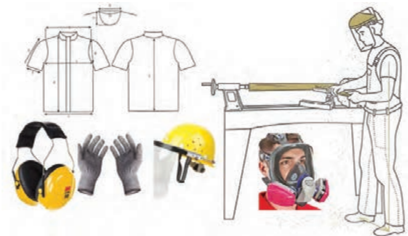
شکل ۳۶- وسایل ایمنی فردی حین کار با ماشین خراطی
