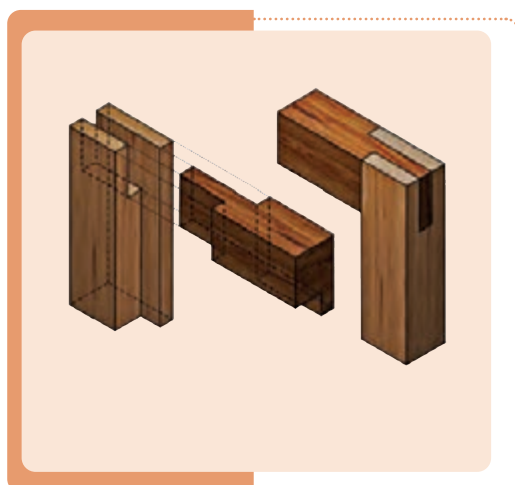
شکل ۱۲- سه نما و تصویر مجسم اتصال گوشه‌ای فاق و زبانه ساده با دو راه عمیق
