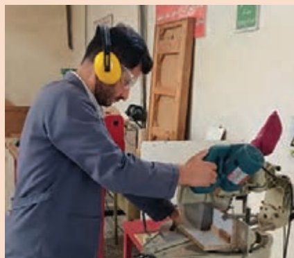
شکل ۱۲۵- نحوه قرارگیری گونیای چوبی دست ساز بر روی ماشین فارسی بر کشویی
