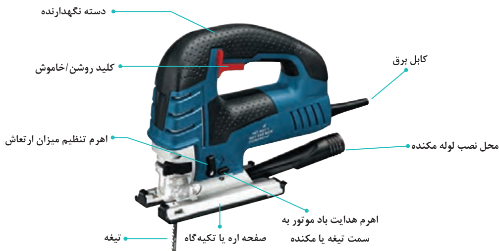
شکل ۴۴- ماشین اره عمودبر و تشریح قسمت‌های مختلف آن
