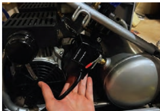
شکل ۱۰۰- خاموش کردن کمپرسور و تخلیه فشار
