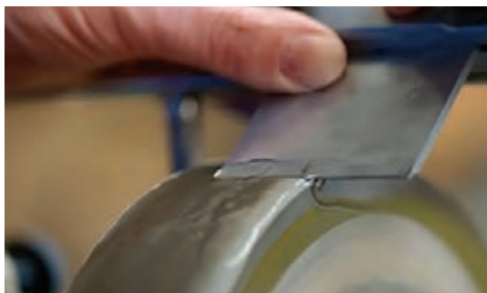
شکل ۱۵۷- نحوه تیز کردن تیغه با دستگاه سنگ و استفاده از آب
