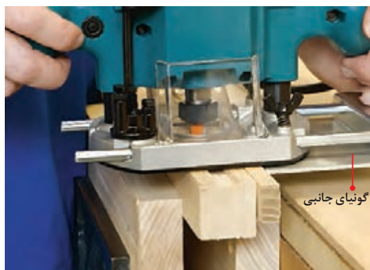
شکل ۱۴۶- شیارزنی روی قطعه کار با استفاده از گونیای جانبی
