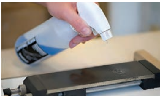
شکل ۱۵۹- استفاده از سنگ آب زبر و نرم برای پرداخت تیغه
