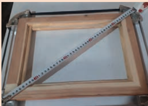
شکل ۱۲۴- نحوه بستن گیره تسمه‌ای و کنترل گونیایی بودن قاب عکس از دو قطر قاب (گرفتن دوییدگی)
