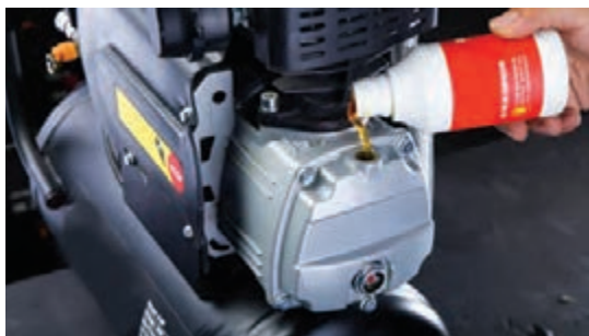
شکل ۱۰۲- ریختن روغن مخصوص در مخزن روغن
