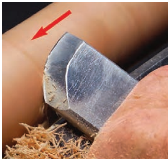
شکل ۲۴- مغار نیم گرد و کار با آن
