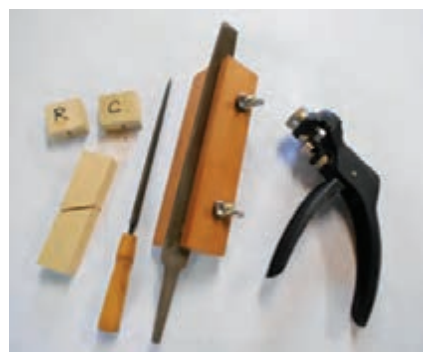
شکل ۷۵- ابزار لازم برای تیز کردن اره دستی
