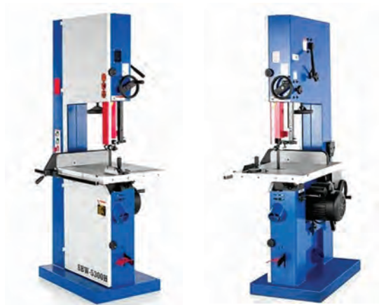
شکل ۵۳- ماشین اره نواری دارای حفاظ کامل فلک‌ها و تیغه
