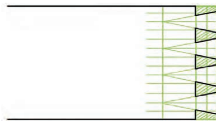
شکل ۵- پررنگ کردن خطوط اتصال و مشخص شدن زبانه‌ها
