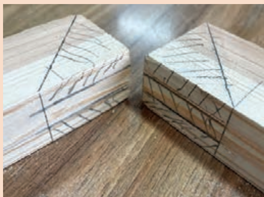
شکل ۱۱۶- خط کشی نر چوب با خط کش تیره‌دار
