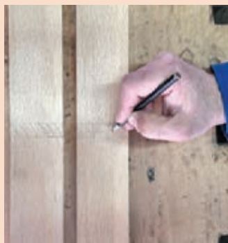
شکل ۲۱۵- هاشور زدن محل شیارها
