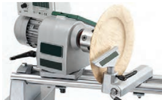
شکل ۹- الکتروموتور سه فاز یک ماشین خراطی
