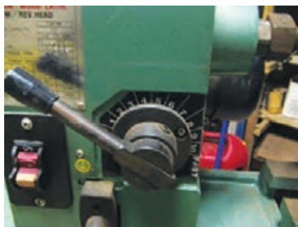
شکل ۱۲- گیربکس تنظیم دور ماشین خراپی
