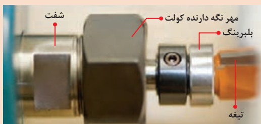
شکل ۱۴۱- بررسی نهایی صحت قرارگیری تیغه
