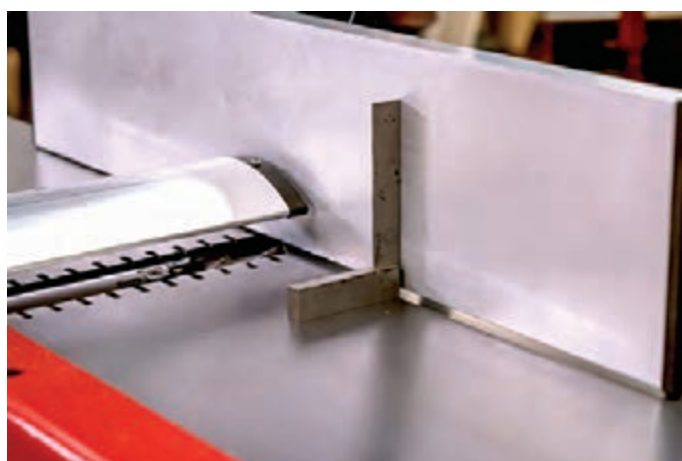
شکل ۲۱- کنترل زاویه صفحه نسبت به گونیای ماشین
