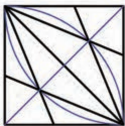
شکل ۱۱۶- ترسیم نیمساز وتر و رسم خطوط از محل برخورد دو نیمساز
