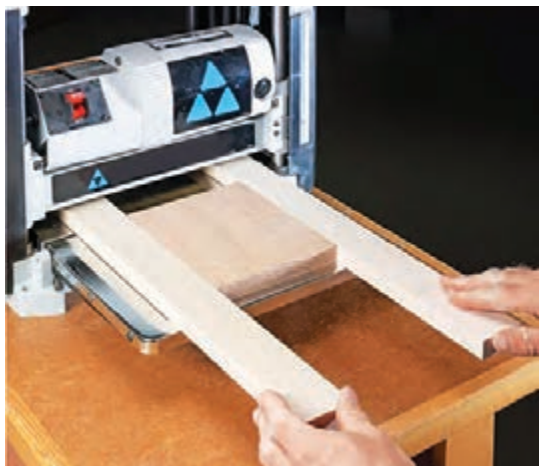
شکل ۷۳- رندیدن چوب‌های باریک و کوتاه با ماشین گندگی
