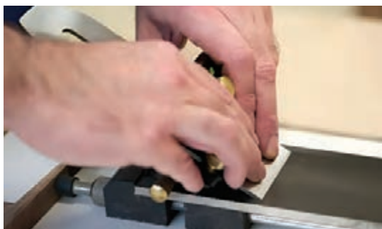
شکل ۱۶۱- نحوه حرکت تیغه روی سنگ آب
