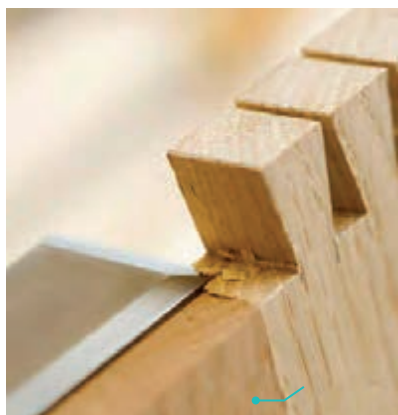
شکل ۱۵- تمیز کردن محل برش خورده با مغار
