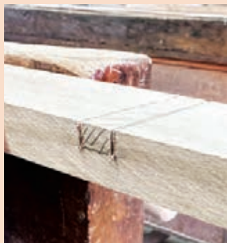
شکل ۲۱۸- برش ایجاد شده تا خط عمق شیار
