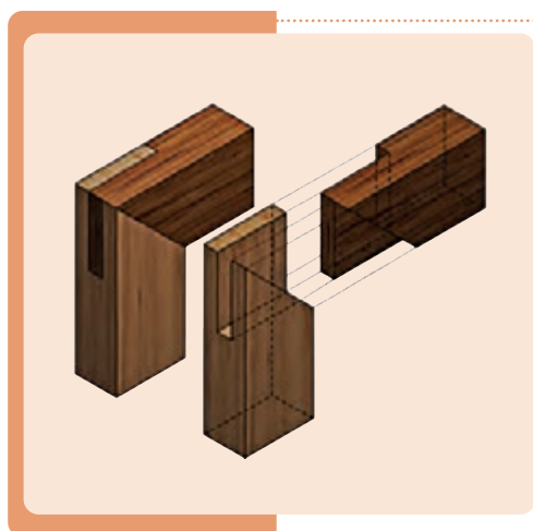
شکل ۶- سه نما و تصویر مجسم اتصال گوشه‌ای فاق و زبانه یک رو فارسی
