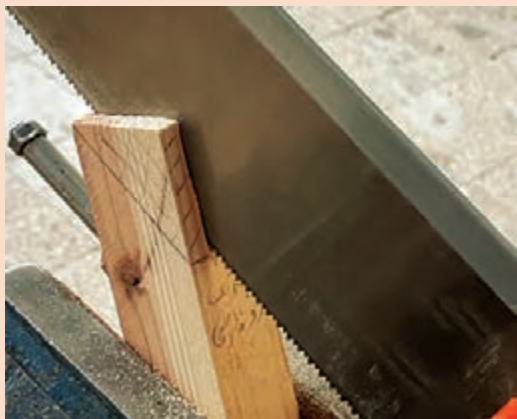
شکل ۱۱۸- برش زبانه اتصال تحت زاویه ۴۵ درجه
