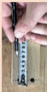
شکل ۲۱۱- اندازه‌گیری محل شیار طبقه اول و سوم
