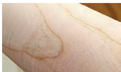
شکل ۵۹- پرداخت قطعه کار خراطی شده با سنباده‌های زیر و نرم
