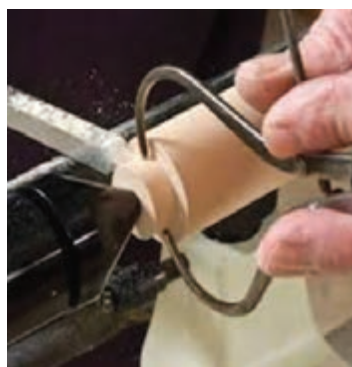
شکل ۴۰- کاربرد انواع پرگار اندازه‌گیر
