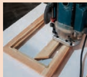
شکل ۱۲۵- مراحل فرز کاری دو راهه قاب عکس و صاف کردن سطح نیم‌گرد به وسیله مغار
