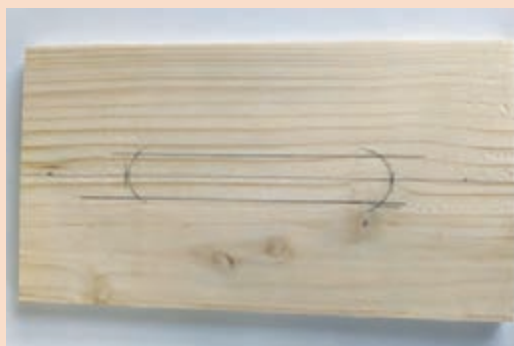
شکل ۶۰- کشیدن طرح شکاف خروج دستمال روی جعبه
