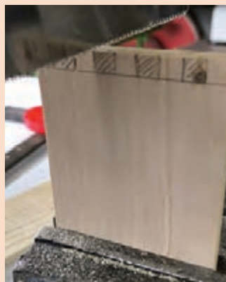
شکل ۵۵- برش کاری اتصال با اره دستی ظریف‌بر شکل ۵۶- خارج کردن بخش‌هایی از اتصال انگشتی
