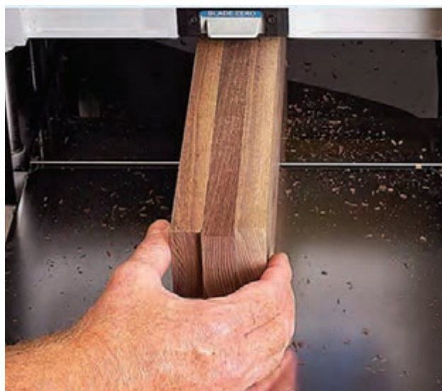
شکل ۷۲- قرار دادن چوب با ابعاد یکسان در ماشین گندگی به صورت هم‌زمان
