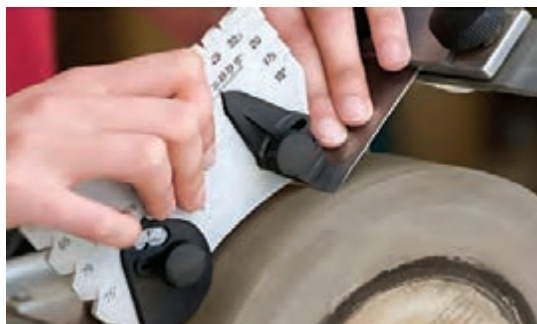
شکل ۱۵۶- تنظیم زاویه قرارگیری تیغه روی دستگاه سنگ
