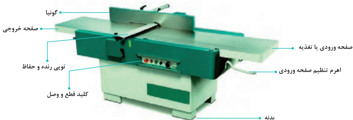
شکل ۶- قطعات مختلف ماشین کفرند
