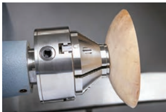
شکل ۱۶- انواع چهار نظام و برخی از کاربردهای آن
