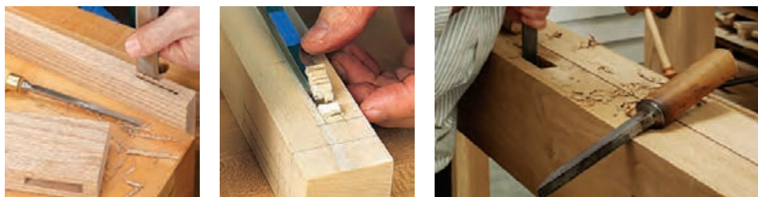
شکل ۶۱- اسکنه و کاربرد آن
