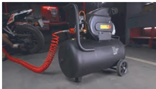
شکل ۱۰۱- کمپرسور خاموش در انتظار خشک شدن رطوبت
