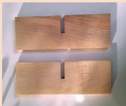
شکل ۳۶- اتصال نیم‌نیم برای تقسیم داخلی جعبه
