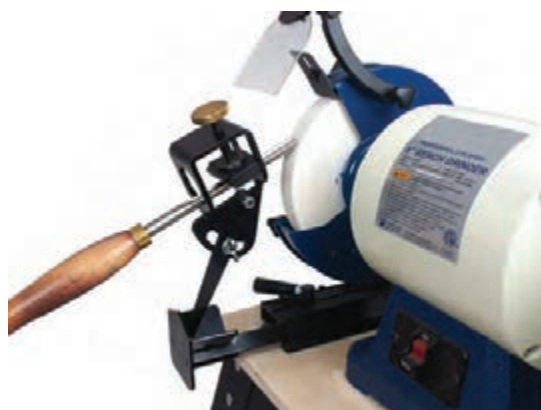
شکل ۳۲- تیز کردن انواع مغار گلوبی براساس زاویه
