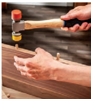
شکل ۵۳- چکش فلزی همراه با لاستیک سخت برای کوبیدن میخ چوبی
