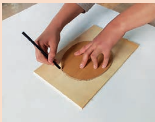
شکل ۹۲- انتقال طرح شابلون روی تخته لایه ۹ میلی‌متری
