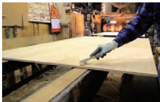
شکل ۵۸- بتونه کاری سطح چوب با کاردک
