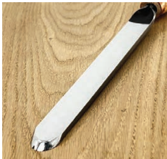
شکل ۲۴- مغار نیم گرد و کار با آن
