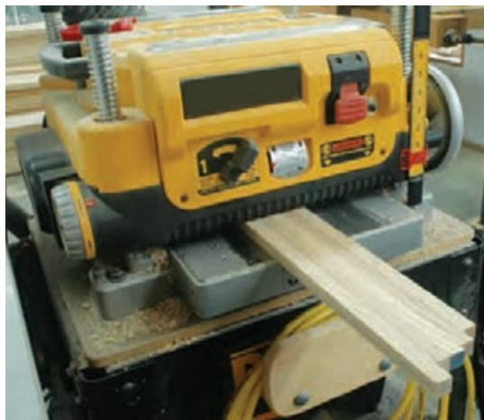
شکل ۷۳- رندیدن چوب‌های باریک و کوتاه با ماشین گندگی
