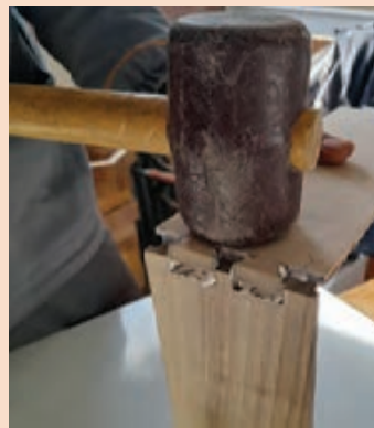
شکل ۳۲- نمایی از اتصال ساخته شده دم چلچله در حال مونتاژ
