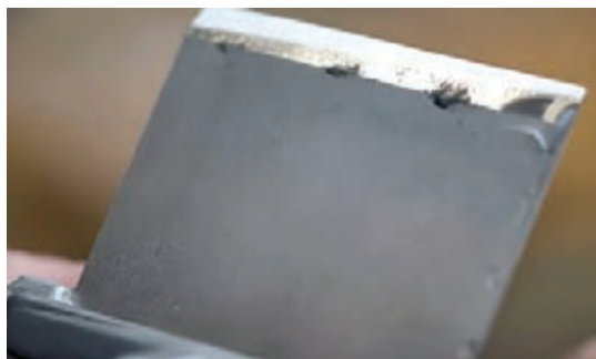
شکل ۱۵۸- تیغه تیز شده با دستگاه سنگ سنباده
