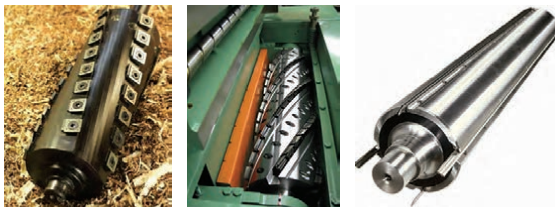
شکل ۶۲- انواع توپ‌ی و تیغه ماشین گندگی
