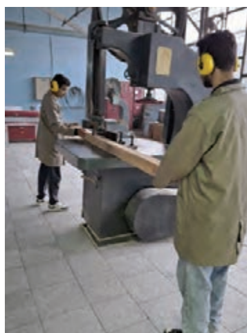
شکل ۵۶- استفاده از فرد کمک در برش چوب با طول زیاد
