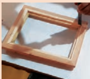
شکل ۱۲۵- مراحل فرز کاری دو راهه قاب عکس و صاف کردن سطح نیم‌گرد به وسیله مغار
