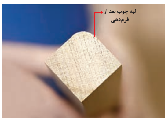
شکل ۱۴۷- گرد کردن لبه قطعه چوب با اورفرز و تیغه بلبرینگ‌دار و قطعه با لبه گرد شده
