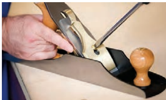
شکل ۱۵۲- باز کردن پیچ روی نگه‌دارنده تیغه
