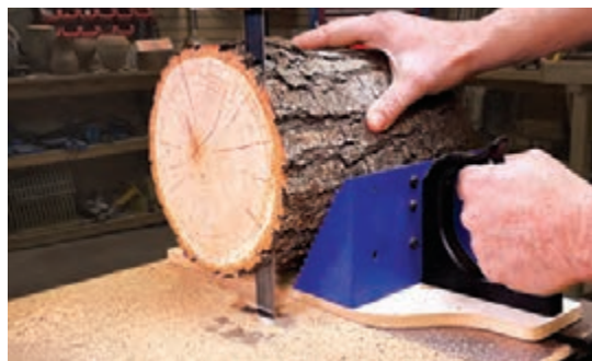
شکل ۵۴- استفاده از فیکسچر (قیدوبند) در برش کاری با ماشین اره نواری
