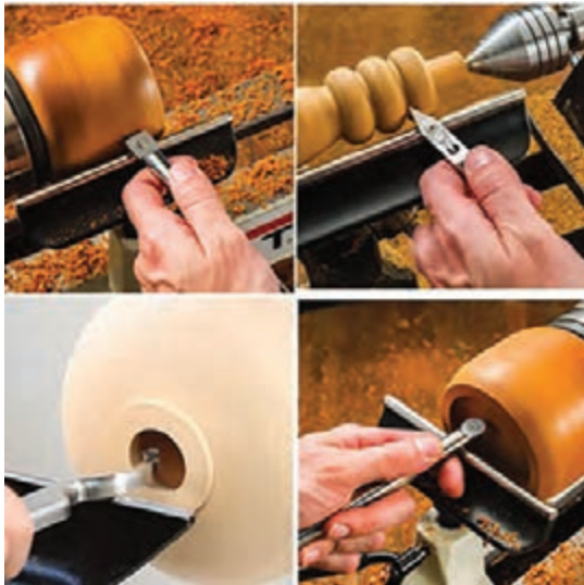
شکل ۱۸- کاربرد برخی مغارها با تیغچه‌های الماسه
