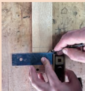
شکل ۲۱۲- خط کشی محل شیار با گونیا
