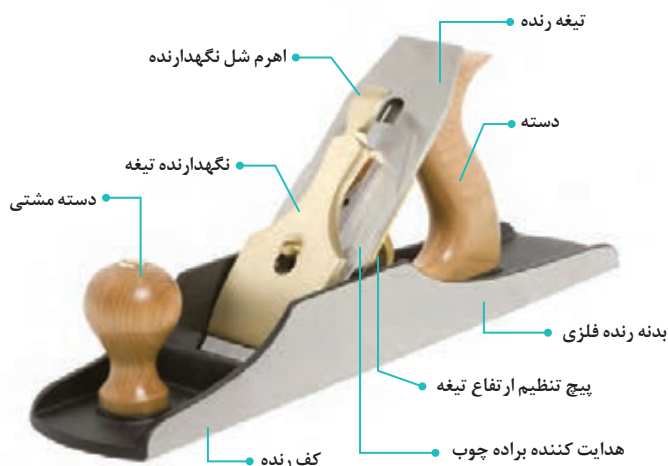
شکل ۱۴۹- رنده پرداخت فلزی (آهنی) و اجزای مختلف آن
