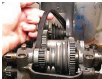
شکل ۱۲- گیربکس تنظیم دور ماشین خراپی
