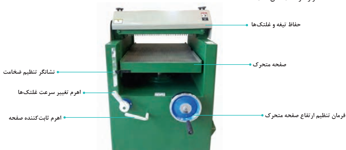
شکل ۶۰- قسمت‌های مختلف ماشین گندگی
