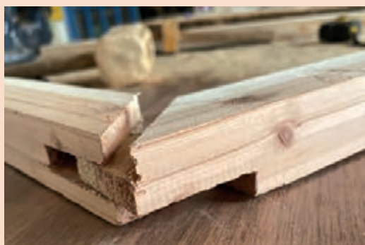
شکل ۱۲۲- اتصال فاق و زبانه یک‌رو فارسی ساخته شده
