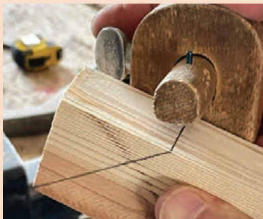
شکل ۱۱۶- خط کشی نر چوب با خط کش تیره‌دار
