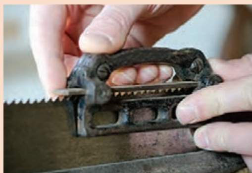
شکل ۷۲- صاف کردن دندان با سوهان تخت
