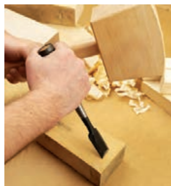
شکل ۵۲- چکش چوبی برای مونتاژ و ضربه زدن به مغار دسته چوبی
