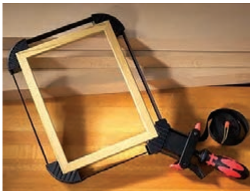
شکل ۲۳۳- مونتاژ قاب با گیره تسمه‌ای
