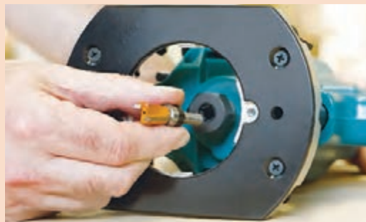
شکل ۱۳۸- نصب تیغه در کولت
