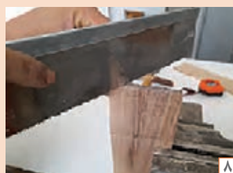
شکل ۲۸- مراحل برش و آماده‌سازی زبانه و فاق اتصال دم چلچله
