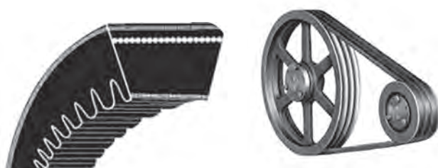
شکل ۱۶- مکانیسم انتقال نیرو با تسمه و چرخ تسمه
