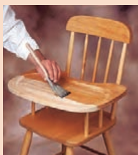
شکل ۱۱۵- سیلر کاری تمام سطح
