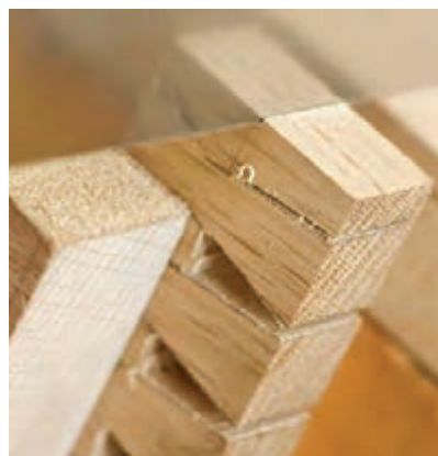
شکل ۱۴- برش لبه زبانه با اره ظریف بر
