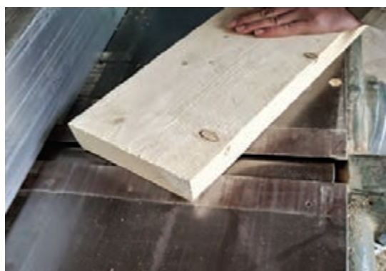
شکل ۲۳- رندیدن چوب‌های دارای گره زیاد به صورت مورب
