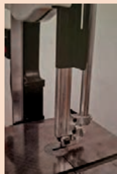
شکل ۱۶- تنظیم ارتفاع هادی‌ها
