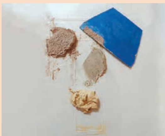
شکل ۱۳۳- ساختن بتونه هم رنگی
