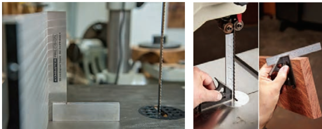
شکل ۵۸- کنترل گونیایی بودن صفحه نسبت به تیغه و گونیای ماشین و کنترل گونیایی بودن دو سطح مجاور هم در قطعه چوب
