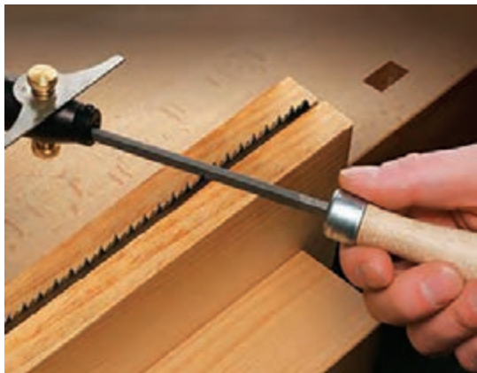
شکل ۸۰- قابلیت تنظیم دو زاویه حمله و برش
