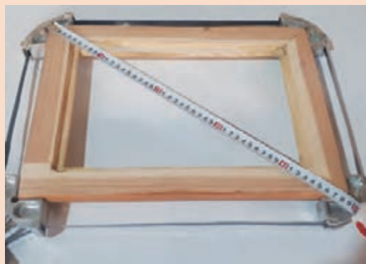
شکل ۱۲۴- نحوه بستن گیره تسمه‌ای و کنترل گونیایی بودن قاب عکس از دو قطر قاب (گرفتن دوییدگی)
