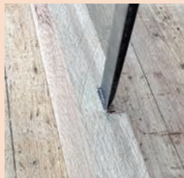
شکل ۲۲۰- نحوه قرارگیری مغار نسبت به خط
