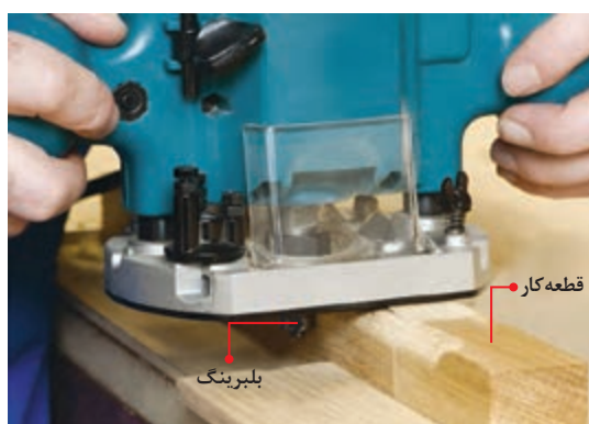
شکل ۱۴۷- گرد کردن لبه قطعه چوب با اورفرز و تیغه بلبرینگ‌دار و قطعه با لبه گرد شده
