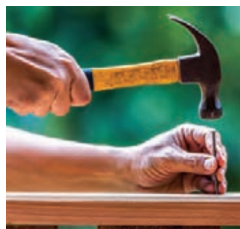
شکل ۴۹- چکش فلزی شاخ‌دار برای کوبیدن و کشیدن میخ
