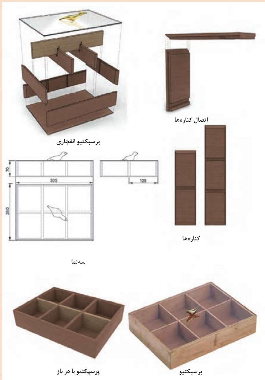
شکل ۴۲- نقشه‌های سه‌نما، تصویر مجسم ایزومتریک، نقشه مونتاژ (انفجاری) جعبه پذیرایی مستطیلی
