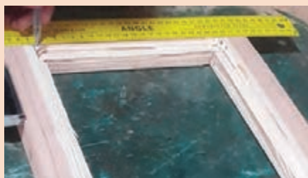
شکل ۱۲۵- مراحل فرز کاری دو راهه قاب عکس و صاف کردن سطح نیم‌گرد به وسیله مغار
