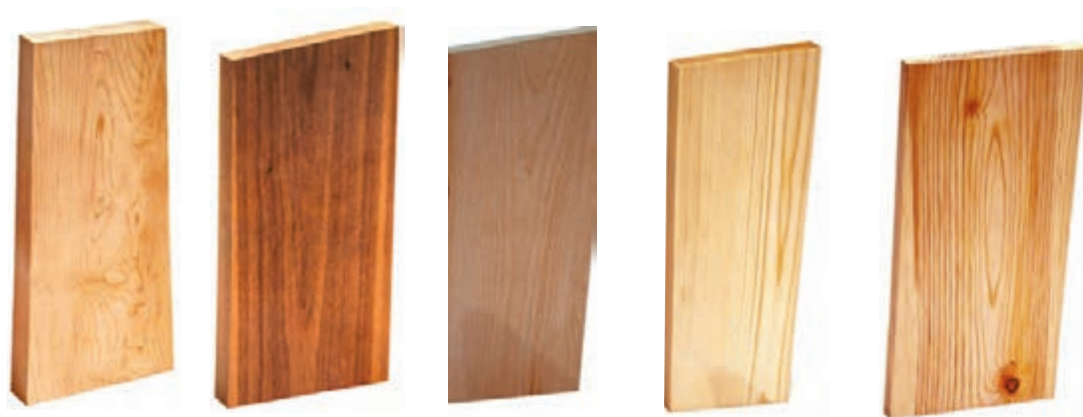
شکل ۵- از راست به چپ، کاج، نراد، راش، گردو و افرا
