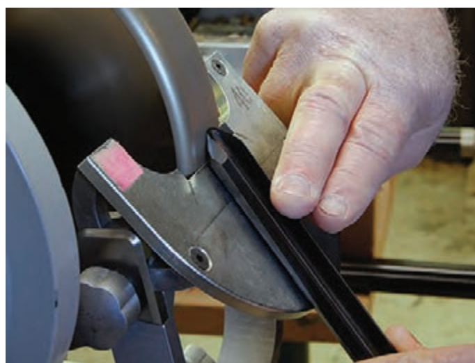
شکل ۳۲- تیز کردن انواع مغار گلوبی براساس زاویه
