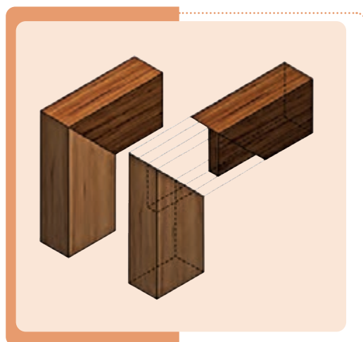
شکل ۸- سه نما و تصویر مجسم اتصال گوشه‌ای فاق و زبانه دو رو فارسی مخفی
