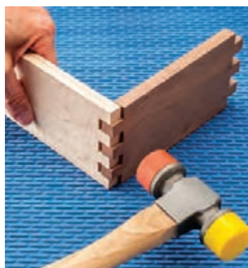
شکل ۵۴- چکش فلزی همراه با لاستیک نرم برای مونتاژ اتصالات چوبی
