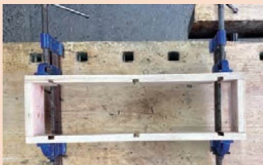
شکل ۲۳۱- قرارگیری قاب شلف درون تنگ
