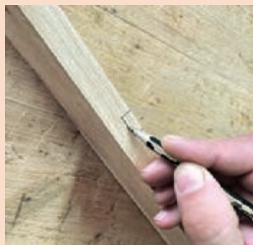
شکل ۲۱۴- تیره نمودن خط عمق شیار با مداد
