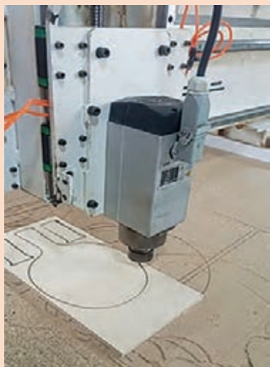
شکل ۹۱- تهیه شابلون توسط ماشین CNC
