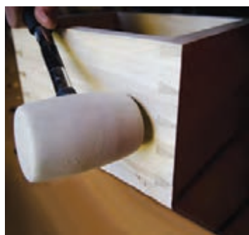
شکل ۵۱- چکش لاستیکی برای مونتاژ مصنوعات چوبی
