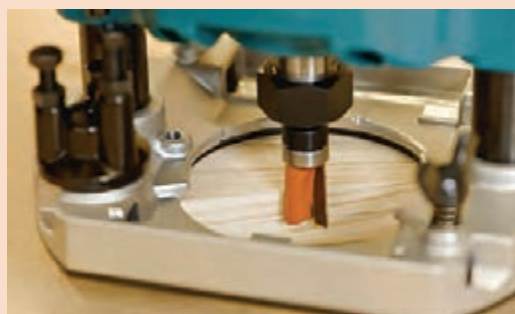
شکل ۱۴۲- فشار اورفرز تا تماس تیغه با سطح قطعه کار
