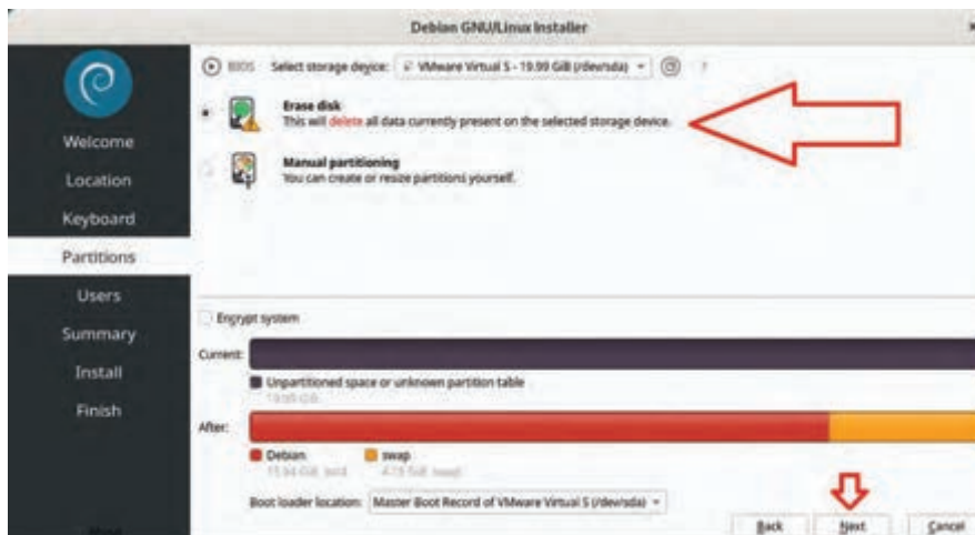
شکل ۳۵- تنظیم هارد دیسک برای نصب دبیان
