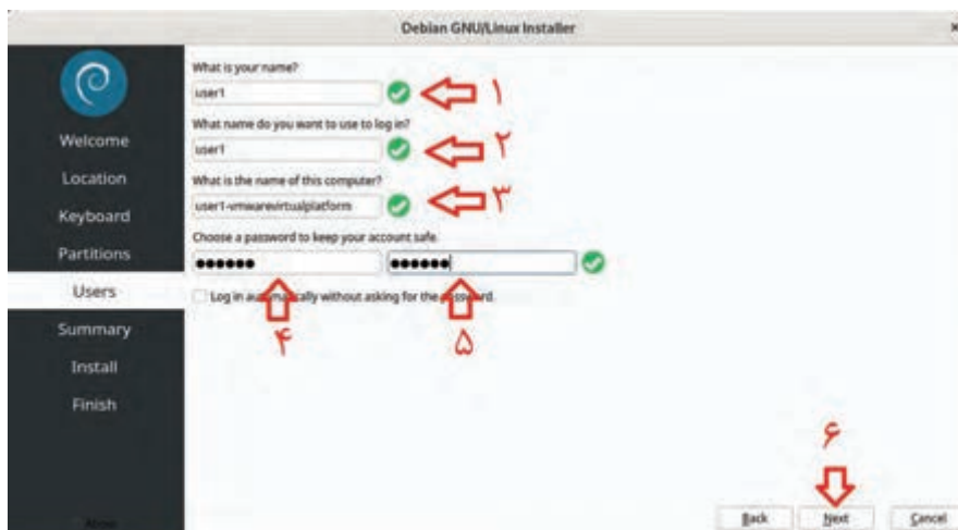
شکل ۳۶- تنظیم نام کاربری و نام سیستم
