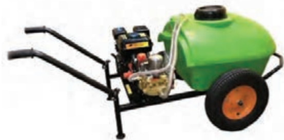
شکل ۴۷- سم پاش چرخ دار موتوری (فرغونی)
