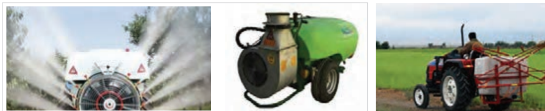
شکل ۴۸- سم‌پاش پشت تراکتوری بوم‌دار (سمت راست) و سم‌پاش توربینی (توربولاینر) (سمت چپ)
