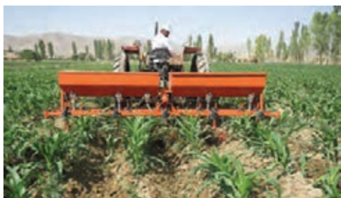
شکل ۴۱- کولتیواتور پنجه‌ای (غلتان) و یا دستگاه کولتیواتور مرکب با کودکار
