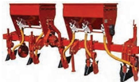
شکل ۴۱- کولتیواتور پنجه‌ای (غلتان) و یا دستگاه کولتیواتور مرکب با کودکار
