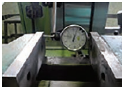
تنظیم گیره به کمک ساعت اندازه‌گیری
