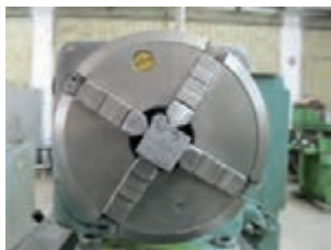
ب: بستن قطعه با مقطع مربع در چهار نظام
