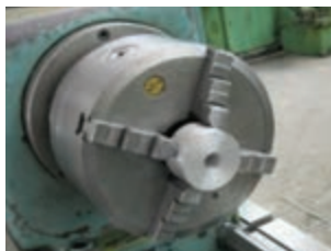
ب: بستن قطعه گرد در چهار نظام
