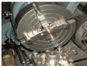
ج: بستن قطعه با مقطع مستطیل در صفحه نظام با فک های تک رو
