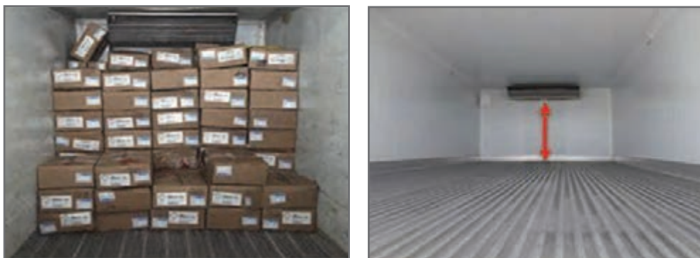
شکل ۲۴- نمایش حداکثر ارتفاع بارگیری
