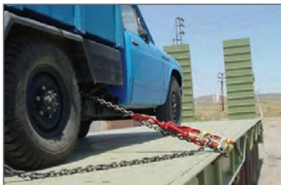
شکل ۵۸- نمونه‌ای از مهار نادرست یک اتومبیل
