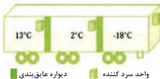
شکل ۲۰- نمای شماتیک از کانتینر با دماهای مختلف پشت سرهم
