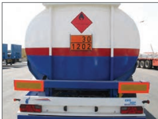
شکل ۶۵- علامت گذاری نشان دهنده گروه مواد خطرناک در پشت و جلو وسیله نقلیه
