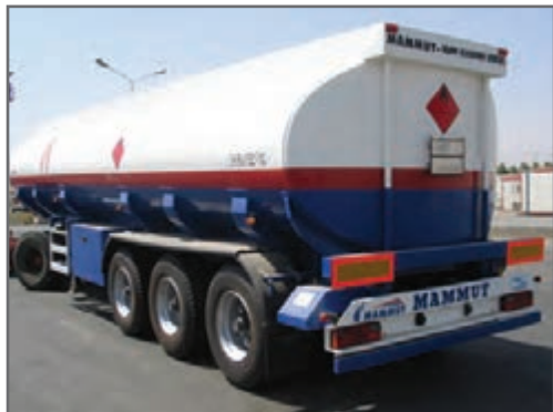
شکل ۶۴- علامت گذاری نشان دهنده گروه مواد خطرناک در پشت و بغل وسیله نقلیه
