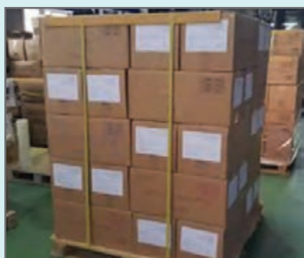
شکل ب) نحوه بستن تسمه و محکم کردن بار روی پالت
