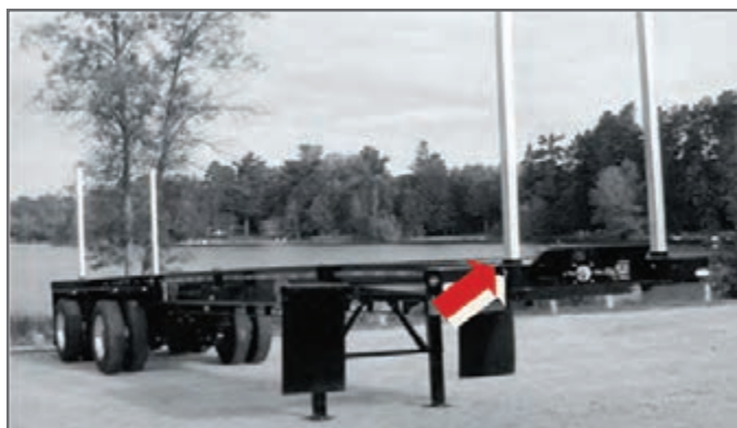
شکل ۱۳- تیرک‌های قائم و نحوه قرارگیری آنها در کنار بارگیر
