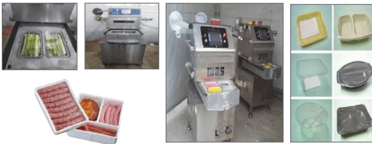
شکل ۳۲- نمونه‌ای از دستگاه‌ها و بسته‌بندی‌های تهیه شده به روش اتمسفر تغییر یافته
