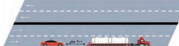
شکل ۳۰- محل قرارگیری خودروی اسکورت نسبت به وسیله نقلیه
