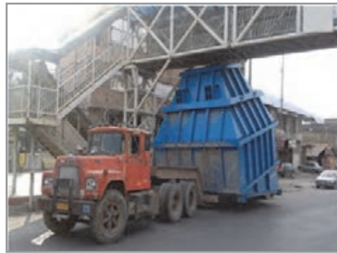
شکل ۳۱- بی‌دقتی در بارگیری و حمل
