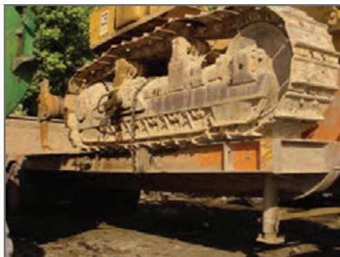
شکل ۶۴- بستن بلدوزر با یک زنجیر آن هم با عبور از چرخ شنی
