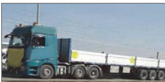
شکل ۱۷- تریلی پنج محور (هجده چرخ) و شش محور (شانزده چرخ)
