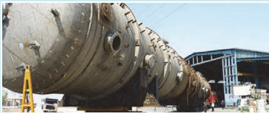
حمل تجهیزات پالایشگاهی برای پروژه بنزین‌سازی پالایشگاه اصفهان (برج فرایندی، بیشترین قطر ۱۱/۵ متر)
