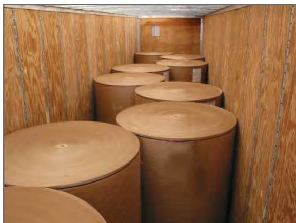
شکل ۵- نمونه‌ای از مهار رل‌های کاغذ با کمک دیواره‌های بارگیر
