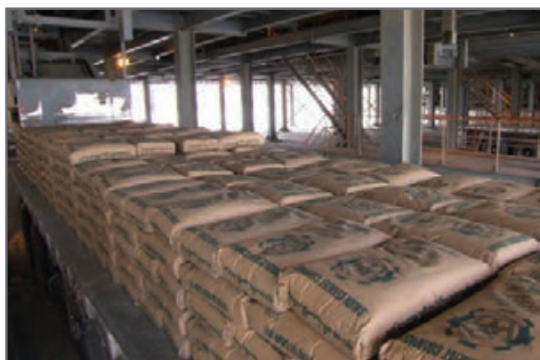
شکل ۵۰- نحوه چیدن کیسه‌ها روی یکدیگر
