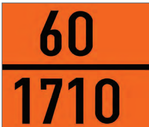
شکل ۵۶- نمونه‌ای از پلاک نارنجی رنگ و علامت مشخصه (لوزی خطر) نصب شده در پشت یک تانکر مخصوص شناسایی مواد خطرناک
