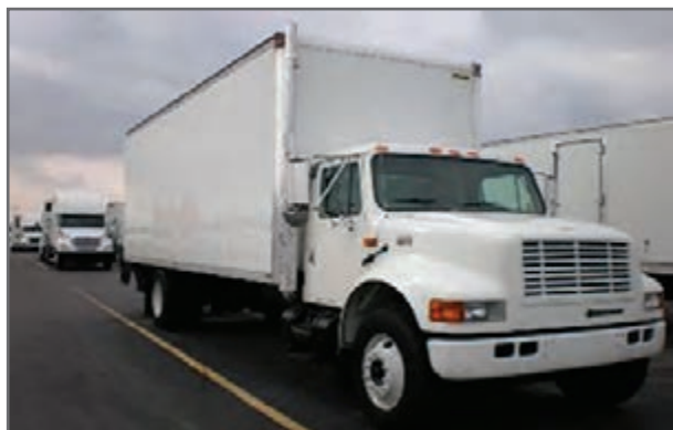
شکل ۸- کامیون با اتاق عایق‌بندی شده
