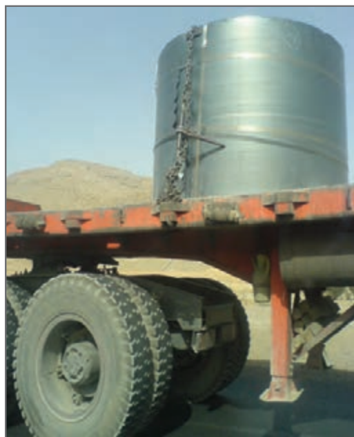
شکل ۷۱- نمونه‌ای از مهار نادرست رل فلزی تنها با یک زنجیر
