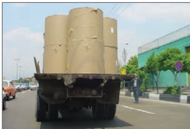
شکل ۶- نمونه‌ای از حمل نادرست رل‌های کاغذ
