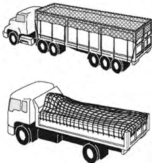
شکل ۸۲ – استفاده از چادر و روکش‌های توری برای مهار بارهای فله‌ای
