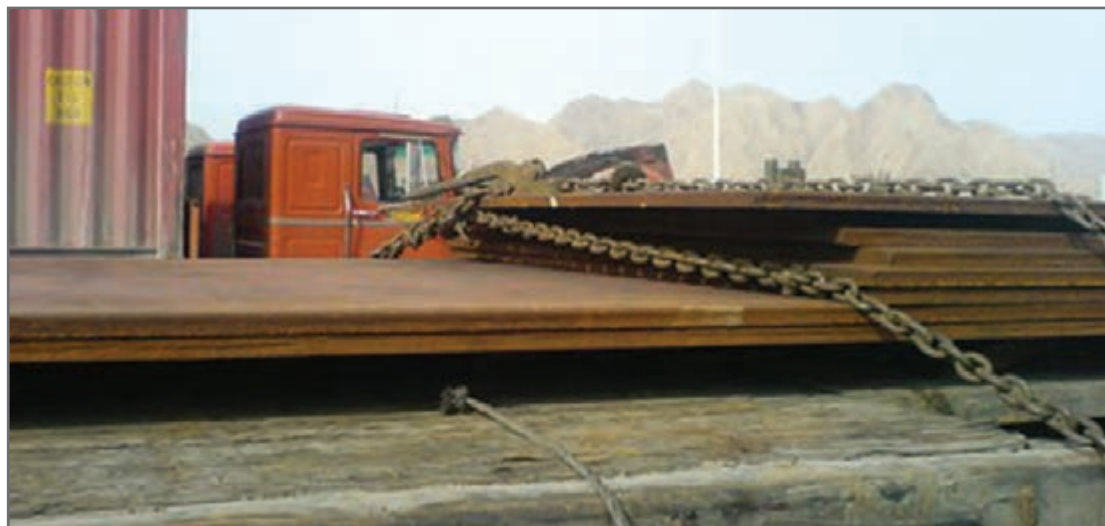
شکل ۶۸ - نمونه‌ای از مهار نادرست ورق (بار تخت) توسط زنجیر
