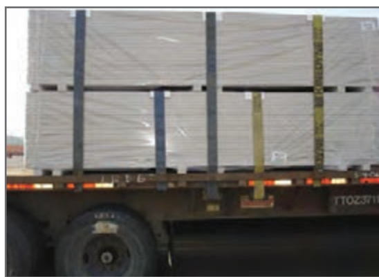
شکل ۲۴- نحوه چیدن ردیف‌های باندل روی هم
