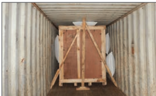
شکل ۳۹- نمونه واقعی از پرکردن و مهاربندی فضای خالی داخل کانتینر
