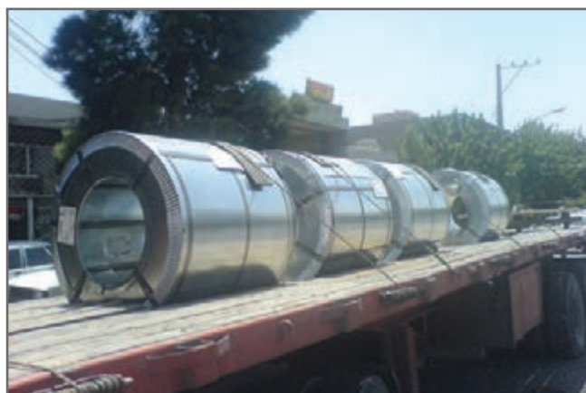
شکل ۱۱- نمونه‌ای از استقرار رل فلزی به صورت طولی با کمک جازلی
