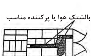
شکل ۳۸- پرکردن فضای خالی داخل کانتینر با بالشتک هوا یا سازه‌های مهارکننده
