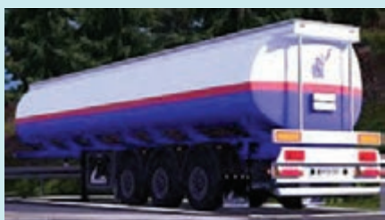
شکل ۶۵- علامت گذاری نشان دهنده گروه مواد خطرناک در پشت و جلو وسیله نقلیه
