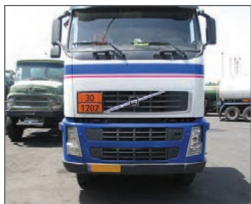
شکل ۶۵- علامت گذاری نشان دهنده گروه مواد خطرناک در پشت و جلو وسیله نقلیه
