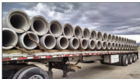
شکل ۱۸- نحوه عملی چیدن لوله‌های فلنجی در دو ردیف
