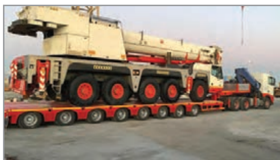
شکل ۱۰- نمونه‌ای از حمل بار سنگین و یا خاص با بوژی
