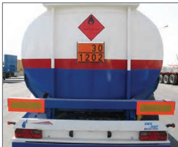
شکل ۵۸- پلاک نارنجی رنگ و علامت مشخصه (لوزی خطر) نصب شده در پشت یک تانکر
