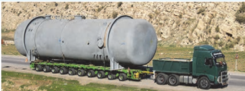
حمل تجهیزات پالایشگاهی برای پروژه بنزین‌سازی پالایشگاه اصفهان (برج فرایندی، طول کل ۲۱ متر)
