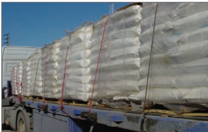
شکل ۴۴- نمونه‌ای از مهر نامناسب پک‌ها به وسیله طناب
