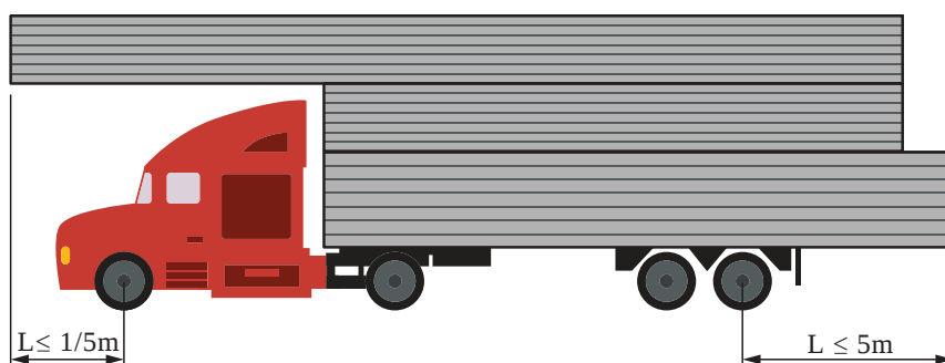
شکل ۵۹- حداکثر میزان تعیین شده بیرون ماندگی بار از عقب و جلوآمدگی بار از جلو انواع تریلی
