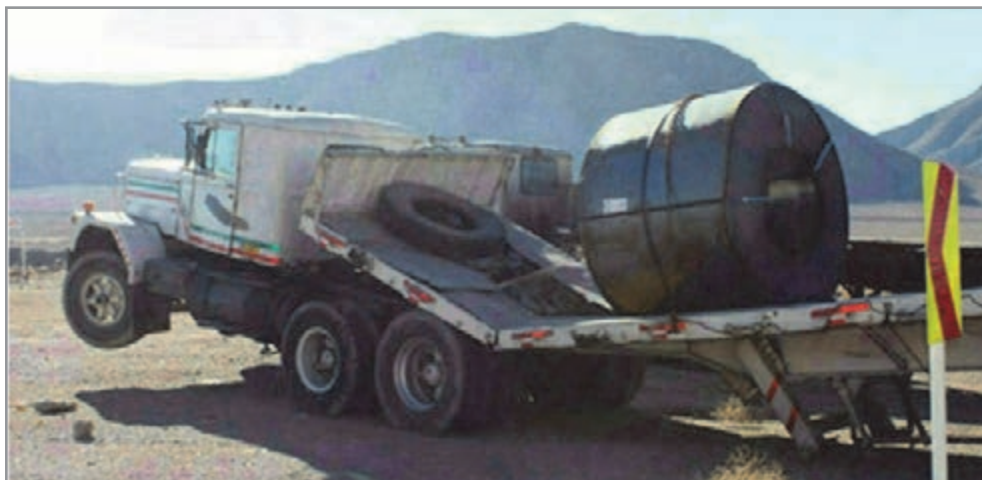
شکل ۳۲- عدم توزیع مناسب بار بر گروه‌های محوری
