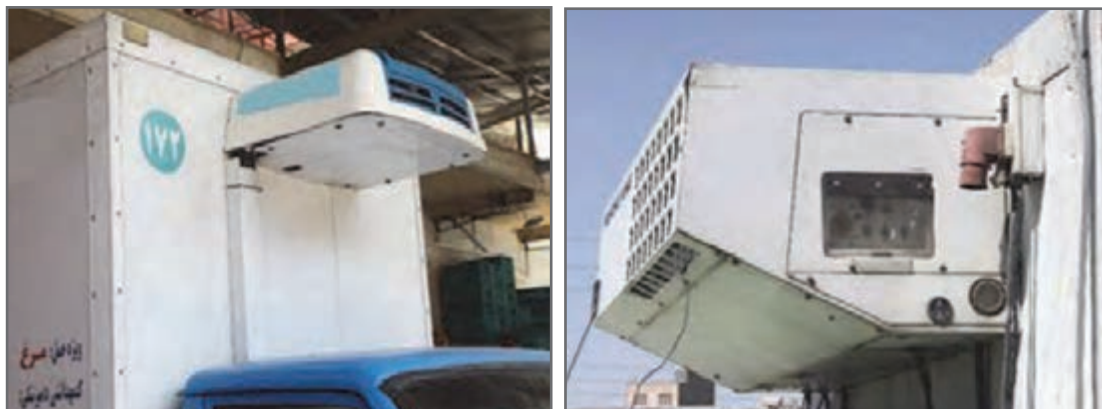
شکل ۲۱- تجهیزات سرمایشی نصب شده بر روی وسیله نقلیه
