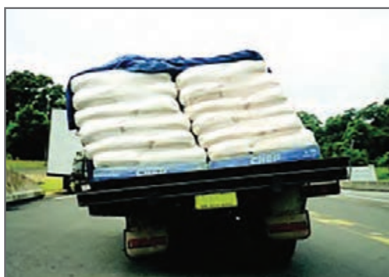
شکل ۱- عدم تعادل وسیله نقلیه به دلیل بارگیری نامناسب
