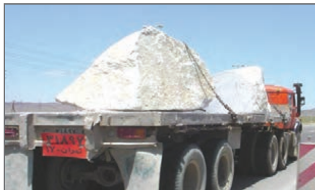
شکل ۵۵- نمونه‌ای از مهار نادرست سنگ‌ها
