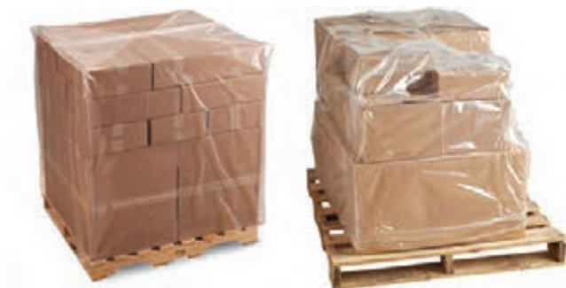
شکل ۱۲- پالت: تخته چوبی برای حمل و نگهداری بار که می‌تواند از دو طرف توسط لیفتراک بلند شود
