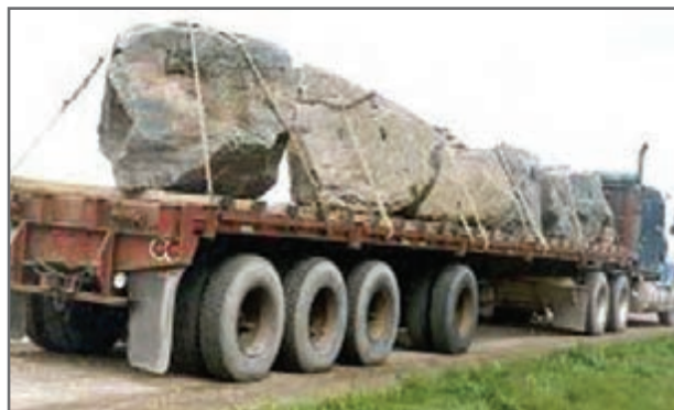
شکل ۵۴- نمونه‌ای از مهار صحیح سنگ‌ها
