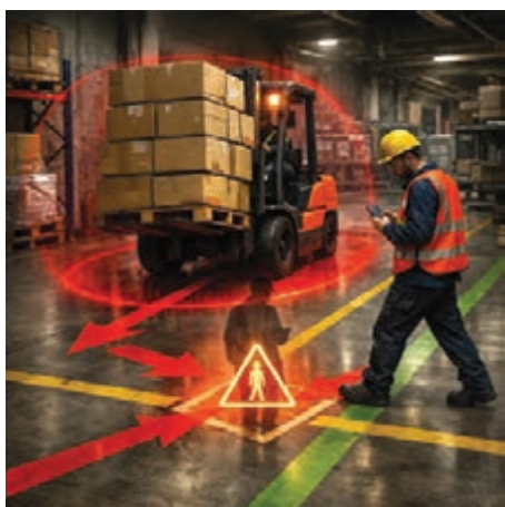
شکل ۳۵- عدم رعایت حریم راه وسایل نقلیه کارگاه می‌تواند منجر به حادثه شود
