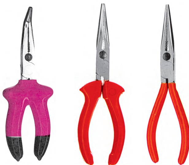
الف - دم باریک دسته ب - دم باریک دسته عایق ج - دم باریک دسته عایق عایق معمولی نوک گرد فشار قوی با نوک بلند فشار قوی با نوک کج ۴۵°
