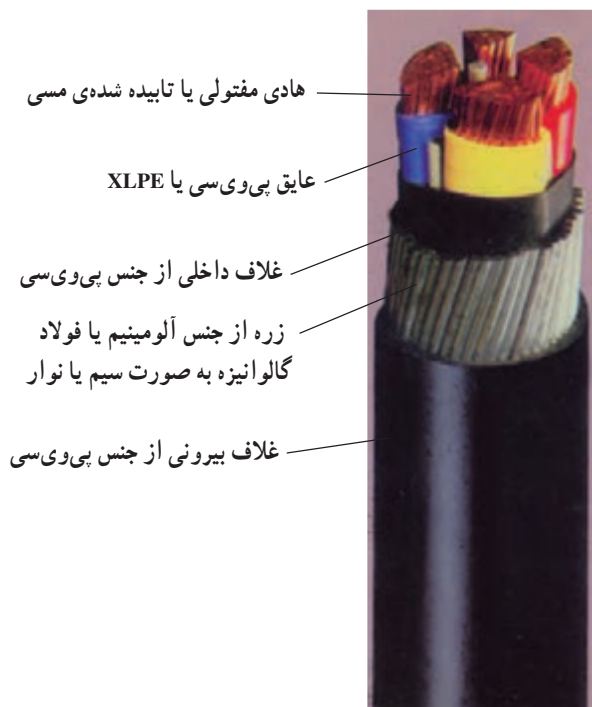
شکل ۵-۴- کابل با عایق PVC به همراه اجزای کابل
